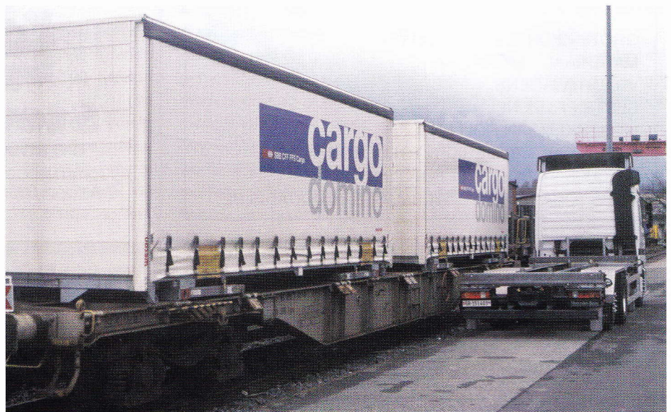
Een eenvoudige overslagtechniek tussen trein en vrachtauto is de Mobiler, die in Zwitserland als Cargo Domino wordt ingezet. Opname in Landquart op 18 december 2002.
