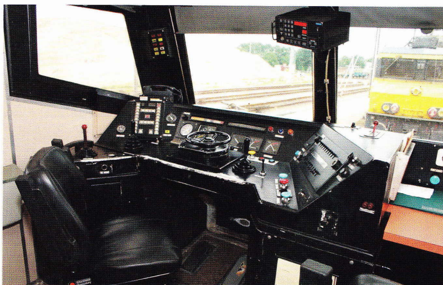
De stuurstanden van de Bs-rijtuigen zijn nagenoeg gelijk aan die van de locomotieven van de reeks 11. Amsterdam Watergraafsmeer, 26 juni 2006. (foto Jos van der Kolk)
