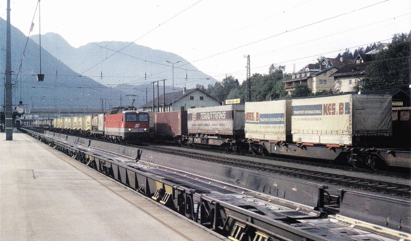
In het station van de Oostenrijkse grensplaats Kufstein zijn op 30 september 1995 verschillende vormen van intermodaal vervoer te zien. Langs het perron staan lege wagens van de Rollende Landstrasse. Locomotief 1044.226 rijdt binnen met een trein met tankcontainers. Daarnaast staan wagens met eerst twee wissellaadbakken, een oplegger en vervolgens nog een maritieme container.
