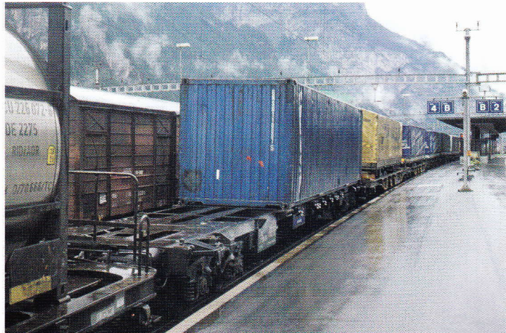
Op een vierassige containerdraagwagen is in het station van Erstfeld (Zwitserland) een 40-voet container te zien. Een vierassige wagon heeft een capaciteit van 60 voet. In deze trein is de overige ruimte onbenut gebleven. In de hoeken van de container zijn zowel boven als onder de uitsparingen voor de kranen te zien.
