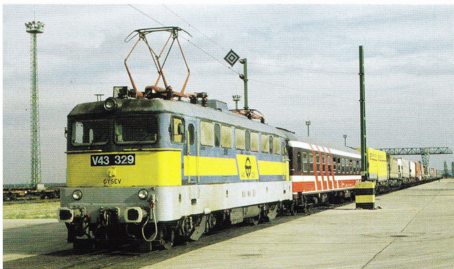
In de terminal van Sopron, gelegen in het netwerk van de particuliere GySEV op de grens van Oostenrijk en Hongarije, is een Rollende Landstrasse te zien. Achter de locomotief is de slaapwagen voor de vrachtwagenchauffeurs te zien, 9 mei 1995.
