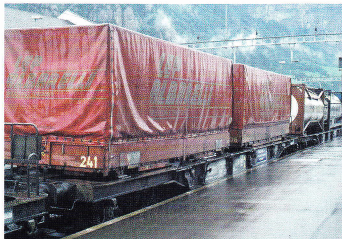
Op de foto een wagon met wissellaadbakken. De wissellaadbakken hebben bovenin op de hoeken geen uitsparingen om ze met een kraan op te tillen. Onder de wissellaadbak zijn de rode poten te zien, waar de bak op geplaatst kan worden, Erstfeld, 7 augustus 1996.
