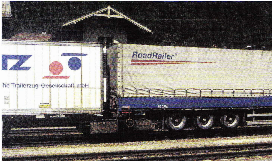
Een Amerikaanse ontwikkeling, die ook enkele jaren door de Bayerische Trailerzug (BTZ) in Duitsland is ingezet, is de zogenaamde RoadRailer, waarbij opleggers op spoorwegdraaistellen worden geplaatst, 7 juni 2001 in Brenner.
