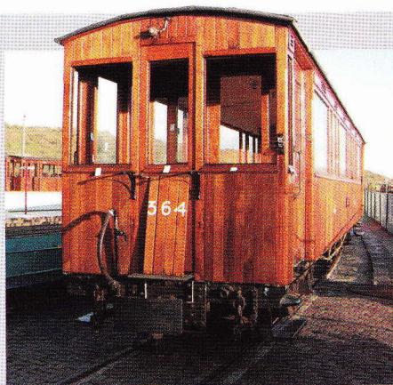
Rijtuig B 364 wordt even buitengezet tijdens de grote revisie, waarna dit rijtuig na 45 jaar stilstand weer in dienst komt. Deze zijde van het balkon is reeds vervangen, aan het andere balkon wordt hard gewerkt. Let ook eens op het nieuwe stijl RTM aanwijsbord. (foto Mark Grootendorst, 9 december 2006)
