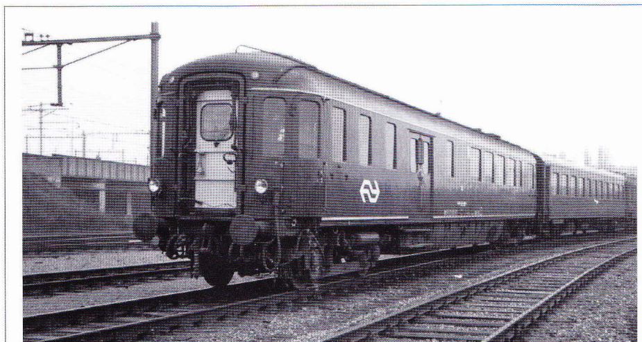
Op deze close-up van WRD 87 40 108 zijn de aanpassingen aan de kop van het rijtuig goed te zien: twee extra lampen, een dichtgemaakte deur en een hoorn. (foto Peter van der Vlist)
