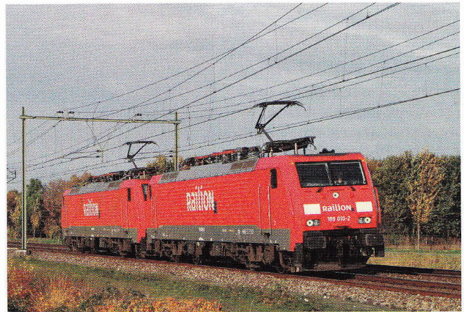
Tijdens de proefritten werd onder meer de opdukracht van de pantografen tegen de bovenleiding gemeten. (foto Sevrien Ferrée)
