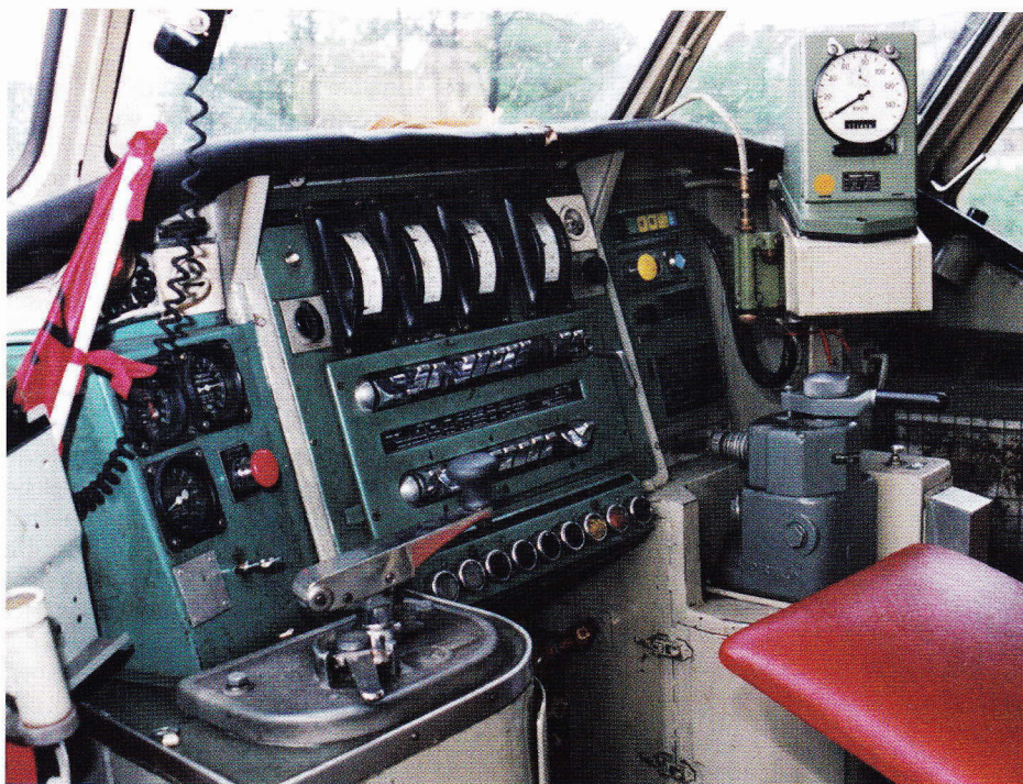
De stuurstand van treinstel 220.904. De Belgische JH-walzen hebben in de loop der jaren voor heel wat storingen gezorgd.
