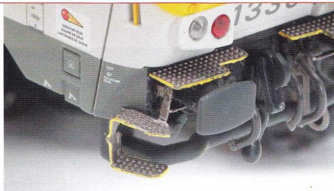
Op de bufferbalk zijn metalen trapjes gemonteerd, ze zijn erg kwetsbaar. (foto Rob Ellerman)
