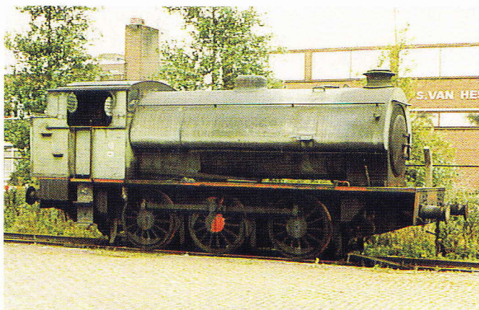
Zo stond de LV13 er jaren lang bij in de Spaansepolder. Na voorzichtig enig Limburgs vuil van de wielassen verwijderd te hebben kwam tot ieders verrassing het 'echte' rood te voorschijn. Het front, dat nu geheel vernieuwd is, laat duidelijk zien waarom dit een Zadel-tank locomotief is. (foto Hans Reints, 4 augustus 1981, Rtd-sp)
