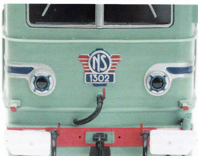
De frontseinen krijgen een dun blauw randje verf en de ruitenwissers worden aluminiumkleurig.
