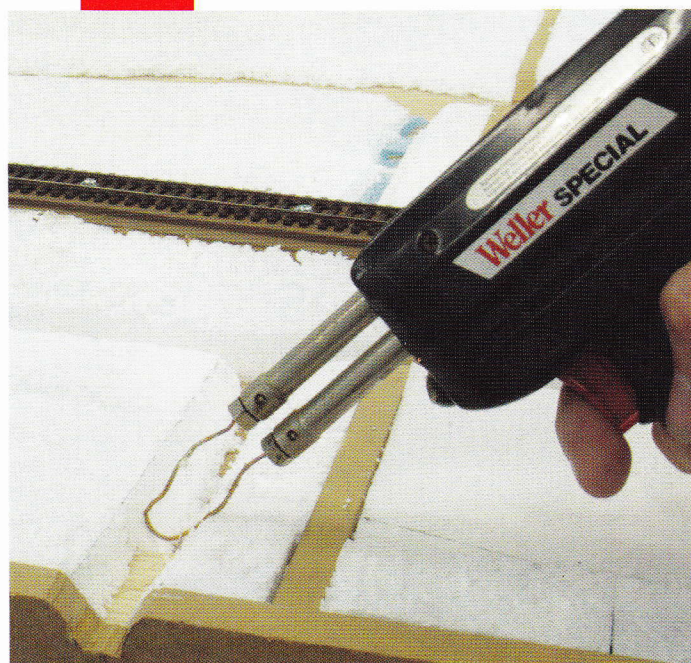
Een soldeerpijstool is heel handig om slotjes uit te baggeren.
