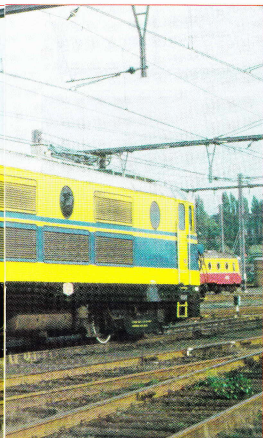
Oorspronkelijk had deze loc vijf horizontale roosters. Na levering van de serie-uitvoering werden de prototypes omgebouwd. Charleroi 28 maart 1983. (foto Thiery Heylen)
