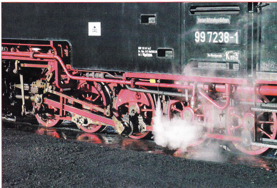
Indrukwekkend is het samenspel van de vijf gekoppelde drijfwielen van loc 99 7238-1. Depot Wernigerode, 20 december 2004.
