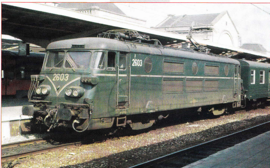
Oorspronkelijk had deze loc vijf horizontale roosters. Na levering van de serie-uitvoering werden de prototypes omgebouwd. Charleroi 28 maart 1983. (foto Thiery Heylen)
