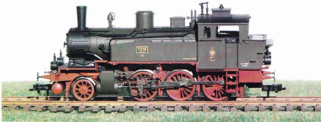
Deze T 9 is een getrouwe kopie van het grote voorbeeld uit Pruisen. Let op de dakventilatie en de petroleumlantaarns.
