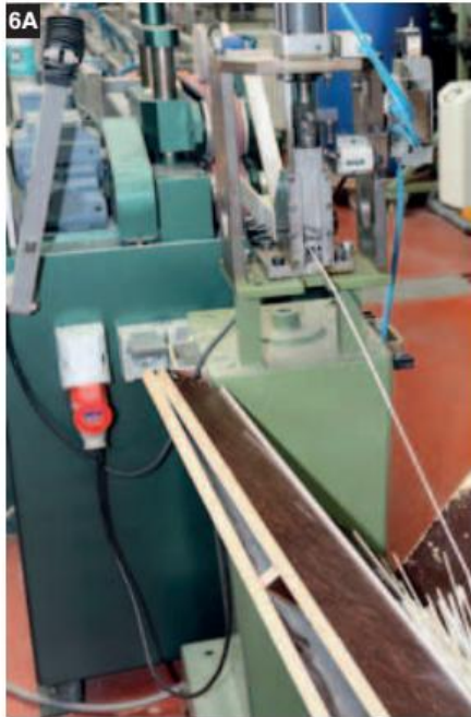
(6A/B) De profielen kunnen een paar honderd meter lang zijn maar worden op de juiste lengte afgeknipt of gezaagd. Voor dunne vlakke profielen volstaat een slagschaar (6A). Dikke of veelvormige profielen worden met een cirkelzaag (6B) automatisch op lengte gemaakt.
