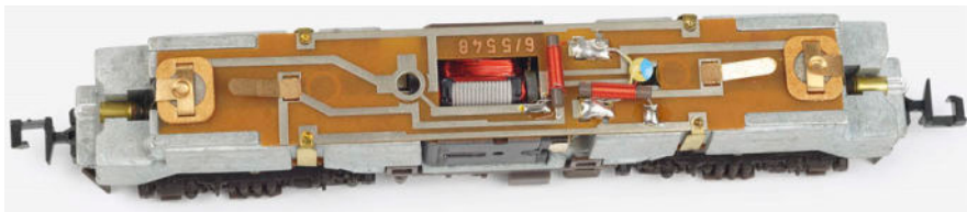
Fleischmann: Das analoge Chassis der ursprünglichen 120.0
