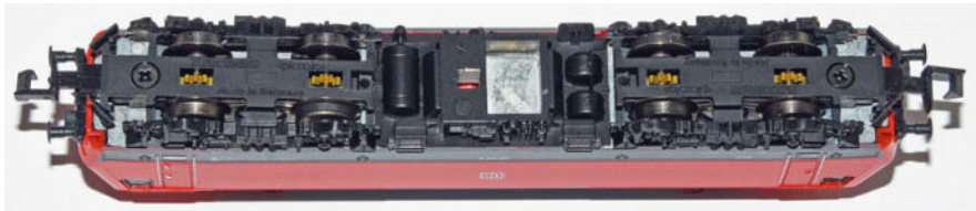
Die alte Fleischmann-Konstruktion der 120.1 mit nur noch zwei diagonal zueinander angeordneten Haftreifen und Einbauraum für einen Sender für Magnetartikel
