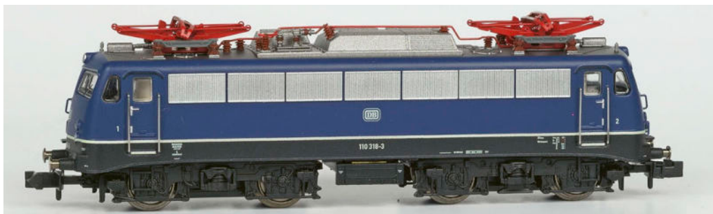
Minitrix: DB 110 318-3 mit langen Klatte-Lüftern und Regenrinnen nur über Türen und Frontfenstern
