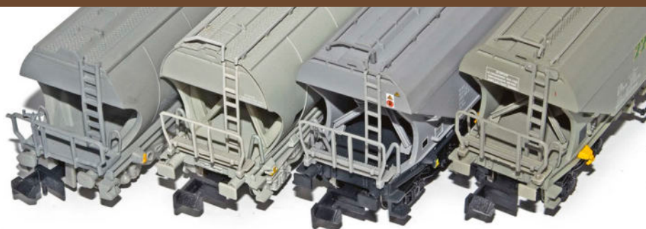
Bühnengeländer, Leiter und Handläufe der „runden“ Wagen von Artrain und Arnold sowie von den „Glatten“ von Arnold und Minitrix
