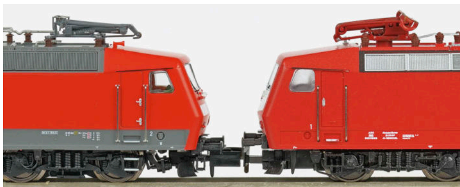
Das Fleischmann-Modell links liegt deutlich niedriger in der Pufferbohle und hat einen zierlicheren Stromabnehmer. Beide Fabrikate haben eingesetzte Lüftergitterelemente und freistehende Griffstangen aus Draht beidseitig der Führerstandtüren
