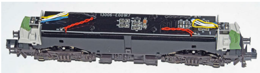
Fleischmann: Das Chassis der neuen 120 in der Digitalversion
