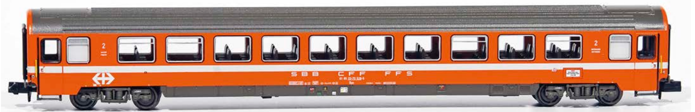
Oben die WC-Seite des C1-Modells mit den Lüftergittern über den weißen Fenstern, unten die Gegenwand wie auf dem Vorbildfoto
