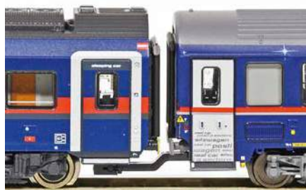
Kupplung zwischen dem Nightjet2-Endwagen und einem Nightjet1-Bmz (L.S.M.)
