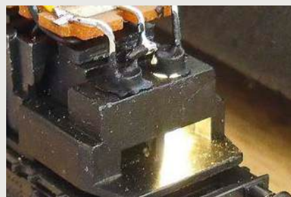
Die LED werden in die Lampenöffnungen gesteckt und außen schwarz lackiert
