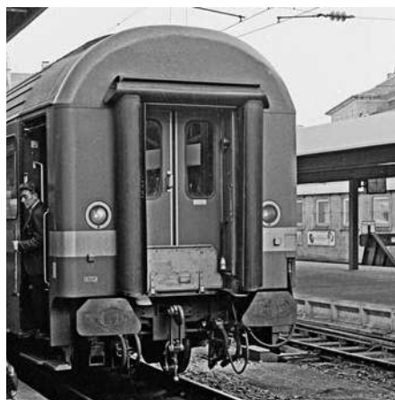
Stirnseitenansicht eines Bpm 500 nach Abkuppeln der Re 4/4 II in Lindau 1981
