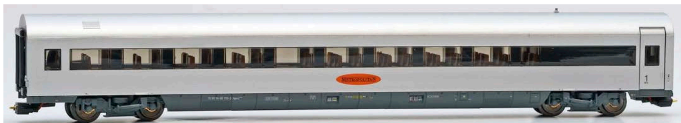
End/Großraumwagen Nr. 1 Apmz 116.0 mit einseitig Gummiwulst und Standardpuffern (links)
