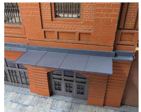
Für eine genaue Passfähigkeit zwischen Arkaden und Hallenwänden wurde ein schmales Zwischendach gedruckt, welches im Bereich der Eingänge verbreitert einen Witterungsschutz darstellt. Das Zwischendach kragt oben aus und hält die Halle somit unverschiebbar fest
