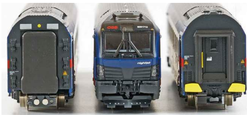
Die drei Stirnseiten der NJ2-Modelle: links gefederte Faltenbälge zwischen den Wagen, Mitte Steuerwagen mit Pufferbohle, rechts Endwagen mit Gummiwulst und Puffern
