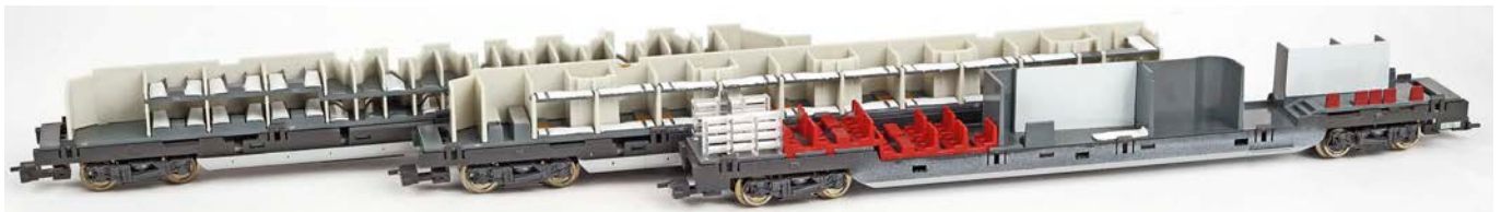
Getreu dem Vorbild verfügen die Wagen über sehr unterschiedliche und aufwendig detaillierte Inneneinrichtungen: hinten der Liegewagen mit Vierer- und Einzelkabinen, in der Mitte der Schlafwagen mit Längsbetten, vorn der „Multiwagen“ mit Behindertenabteil
