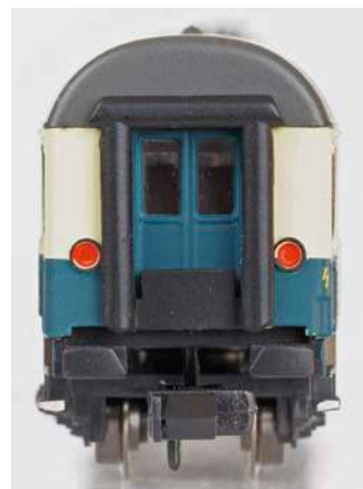
Minitrix: Die Stirnpartie an den Einstiegen des DB WRtm 134 mit tiefhängenden Puffern
