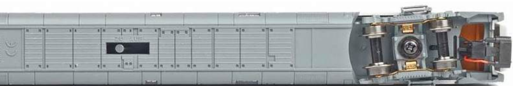
Die Wagenböden-Unterseiten sind detailliert und haben einen Entriegelungsschieber
