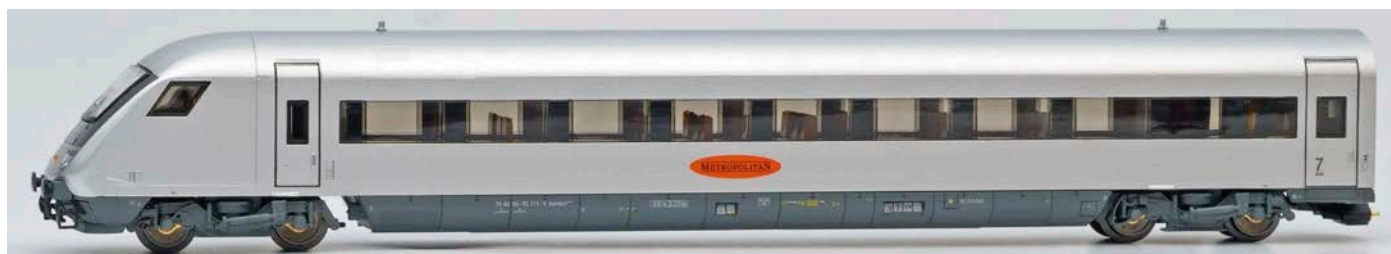
Steuer/Großraumwagen Nr. 7 Apmbfz 116.8 mit zusätzlichen Führerstands-Vorraumtüren
