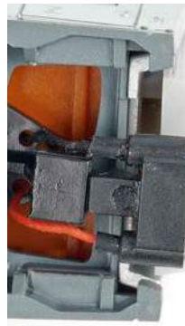
Die Magnetkupplung hat beidseitig Kontakte mit Stift und Buchse für Stromübertragungen durch den ganzen Zug
