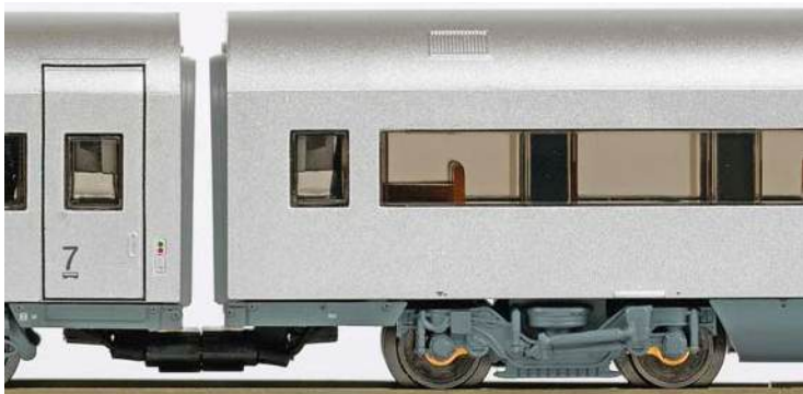
Der Kuppelabstand lässt reichlich Spiel für die Einfahrt auch in starke Steigungsübergänge. Vorbildgerecht gibt es keine Standardpuffer
