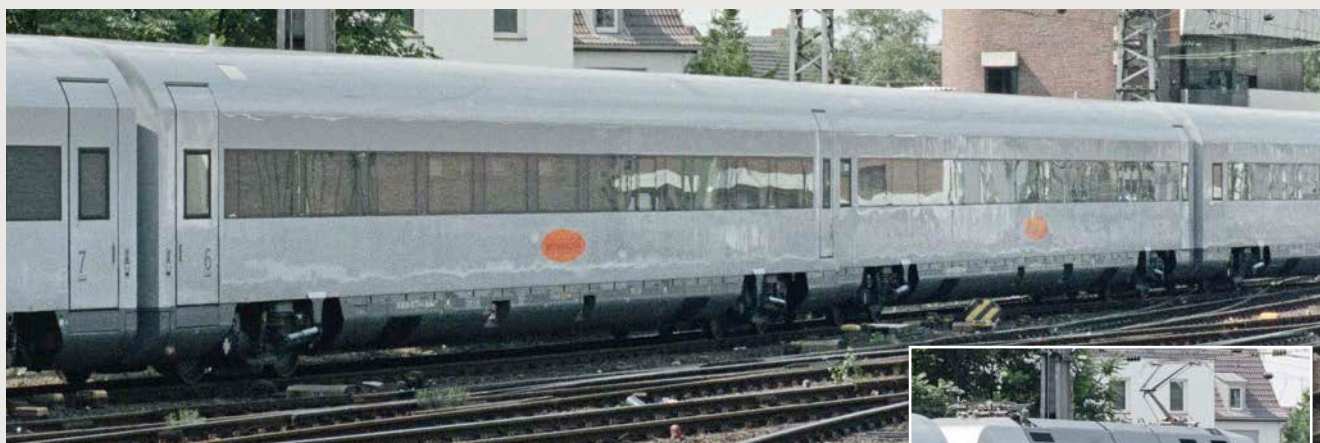
Die Bar/Großraumwagen (hier links Wagen Nr. 6) unterscheiden sich äußerlich durch die zusätzlichen Servicetüren. Wagen Nr. 5 steht noch etwas schräg auf der Weiche, sodass auf dem Foto kein Spalt zu sehen ist. Am Schluss eine der 101 in MET-Farben
