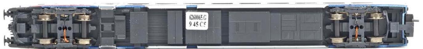
Der Boden des Steuerwagens mit den Anschlusskabeln an den Drehgestellen für die Stromabnahme über die Achslagerbleche
