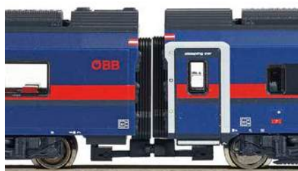
Es verbleiben geringe Spalten zwischen den Wagenenden des analogen Nightjet2
