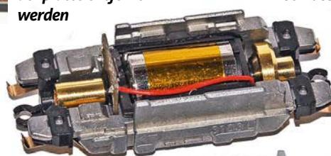
Motor mit Schwungmasse, Kardanaufnahmen und Anschlussplatine
