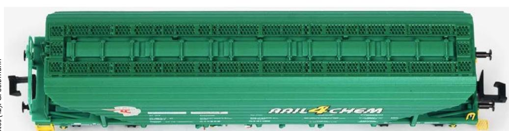
**Liliput:** Die Dachlaufroste des Uagpps sind als geätzte und lackierte Teile aufgesetzt
