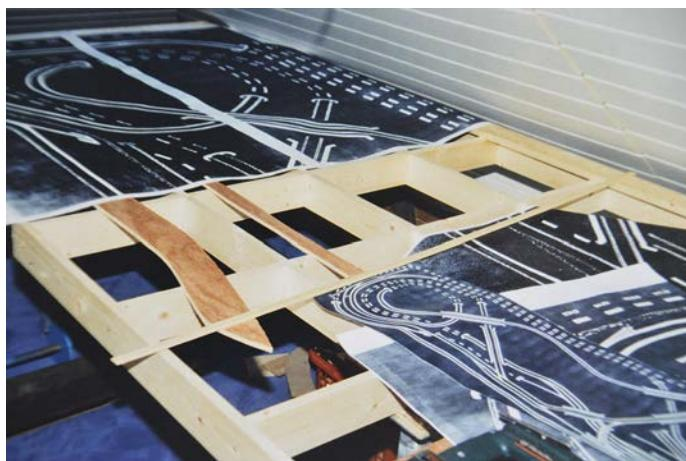
Die Gleis- und Trassenführungen wurden mit Hilfe von vergrößer-ten Kopien des Originalgleisplans auf dem Anlagenrahmen verlegt
