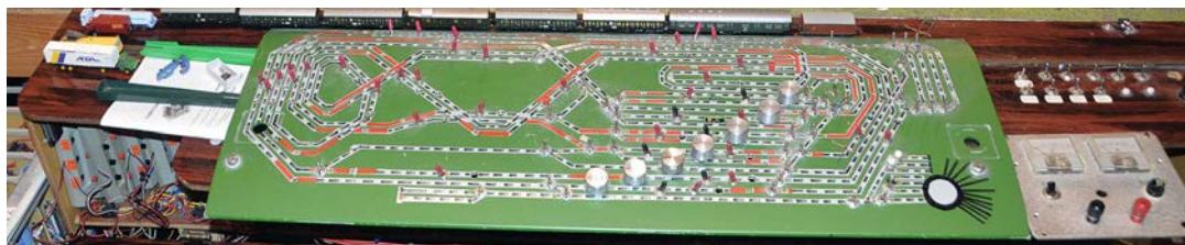
Die Anlage wird über ein selbst gebautes Gleisbild-Stellpult gesteuert, das vor dem Hauptbahnhof platziert ist
