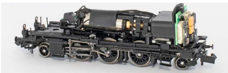
**Das Innere der Eb 3/5 von AVM mit Sounddecoder, Lautsprecher im Führerstand und Glockenankermotor mit Schwungmasse im Kessel für den Antrieb**
