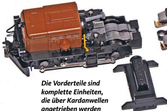
Die Vorderteile sind komplett Einheiten, die über Kardanwellen angetrieben werden
