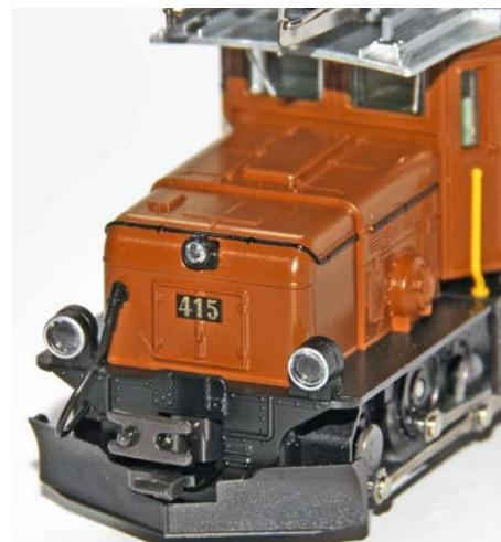
*Kato: Vorbau mit angesetzten Steckteilen*
