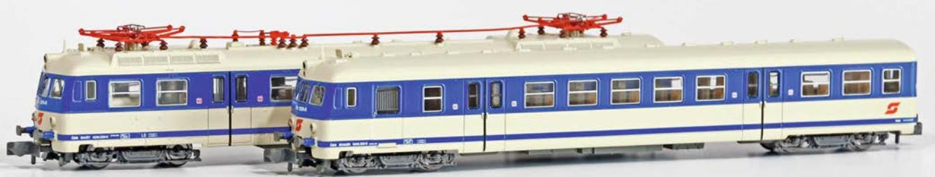
**Motor- und Steuerwagen der neuen Variante haben Fronten mit oberem separatem Schlusslicht, Antenne und Typhon-Schutzgitter**
