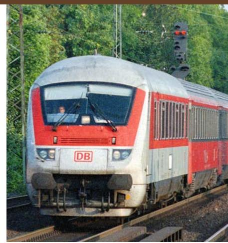
Dank der gleichen 18-poligen UIC-Leitung konnten EC der ÖBB mit DB-Steuerwagen im Wendezugbetrieb verkehren, Bonn 2000
