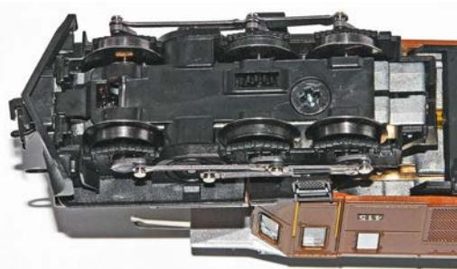
Zum Tauschen der Kupplung muss die angeschraubte Bodenplatte entfernt werden
