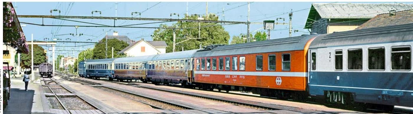
Im EC 92 „Schweiz“ stellten 1987 die SBB/SSG einen WRm in Eurofima-Lackierung C1 zwischen den DB-Wagen. An der Zugspitze ist eine der sechs Re 4/4 II mit einem breiten Schleifstück für die Streckenabschnitte der DB und ÖBB. Ihr folgten unmittelbar ein Bpmz und ein Avmz (ex Rheingold) zollmäßig für Reisende nach und von Bregenz, St. Margrethen
