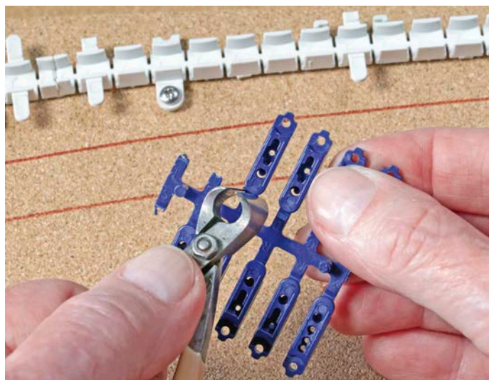
Die Glieder müssen gradfrei vom Anguss getrennt werden
