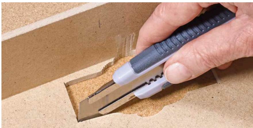
Nachdem die Korkplatte flächig auf den Dioramakasten geklebt wurde, wird aus dieser der Ausschnitt für den Magnorail-Antrieb von unten herausgeschnitten
