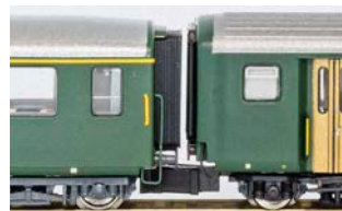
Abstände mit Peko-Köpfen zu Ls von MW-Modell, EW I von Piko und EW II von Brawa
