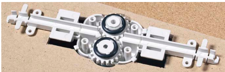
Der Antriebsblock wird von oben provisorisch eingesetzt
