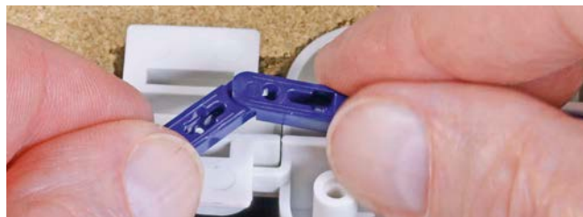
Verdreht in den Zapfen des jeweils letzten Kettengliedes eingesteckt, rasten die sauber abgetrennten Glieder der Antriebskette beim Geraderichten miteinander ein
