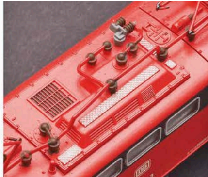
Links die geschwärzten Räder, Mitte und rechts die auf den Dächern nachlackierten Isolatoren, Dachleitungen, Laufroste und Gitter
