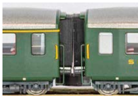
Abstände mit Peko-Köpfen zu Ls von MW-Modell, EW I von Piko und EW II von Brawa
