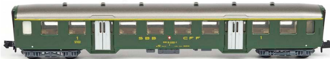
A 040–049 und 750–779 von 1951/52 (ex B4ü) mit acht Sitzkarrees (2+1/ 1+2) in drei Großräumen, hier der Nr. 757 in einem Schnellzug nach Brig. Man sieht, dass der Boden und die Sitzebene des mittleren Abteils tiefer liegen als bei den äußeren, Spiez 1991
