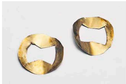
Rechts: Für einen besseren Stromkontakt zwischen Drehgestell und Lokchassis werden Bleche aus 0,3 mm Messing zugeschnitten, Mitte: Kontaktblech auf dem Drehgestell bereit zum Einfügen, rechts die Aufnahmeöffnung für das Drehgestell im Lokrahmen
