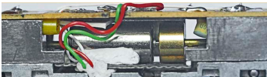
Der Motorblock ist an seinem Platz: Zu beachten sind die weiße Klebmasse an den Seiten und unter dem Motor sowie die Kartoneinlage (Pfeil) oben zur Feineinstellung
