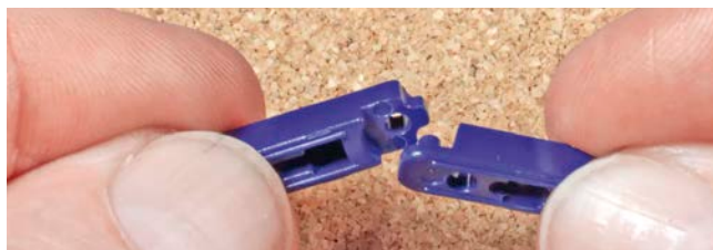
Verdreht in den Zapfen des jeweils letzten Kettengliedes eingesteckt, rasten die sauber abgetrennten Glieder der Antriebskette beim Geraderichten miteinander ein
