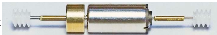
Bei der ozeanblau/beigefarbenen Version der 111 wurden die Kunststoff-Schnecken von Tramfabriek verwendet. Sie sind auf 1 mm dicke Verlängerungsachsen aus Stahl geschoben, die je mit einer Messing-Hülse (abgeschliffene Schnecken) an die Motorwelle angesetzt sind
