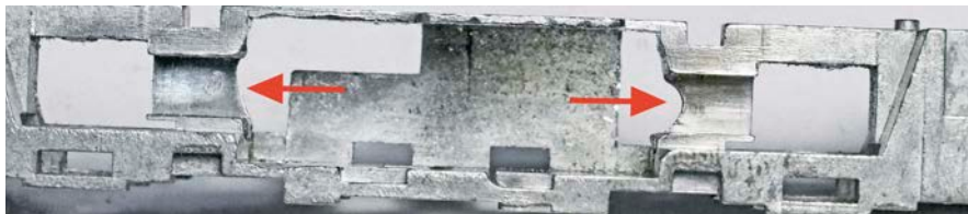
Der gefräste Rahmen, bereit, um den neuen Motorenkomplex aufzunehmen
