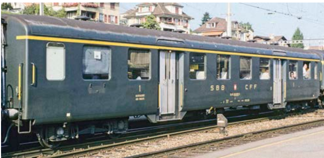
A 040–049 und 750–779 von 1951/52 (ex B4ü) mit acht Sitzkarrees (2+1/ 1+2) in drei Großräumen, hier der Nr. 757 in einem Schnellzug nach Brig. Man sieht, dass der Boden und die Sitzebene des mittleren Abteils tiefer liegen als bei den äußeren, Spiez 1991
