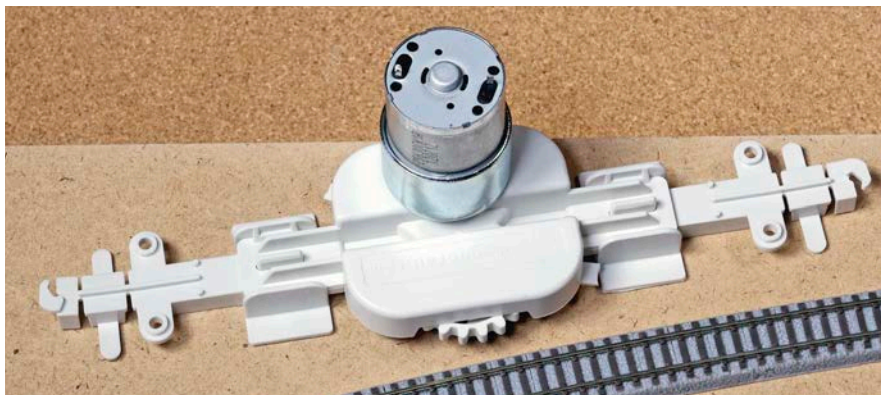
Die Position des Antriebs wird ermittelt, angezeichnet und anschließend ausgesägt
