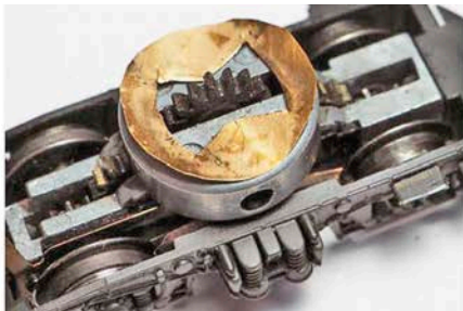
Rechts: Für einen besseren Stromkontakt zwischen Drehgestell und Lokchassis werden Bleche aus 0,3 mm Messing zugeschnitten, Mitte: Kontaktblech auf dem Drehgestell bereit zum Einfügen, rechts die Aufnahmeöffnung für das Drehgestell im Lokrahmen
