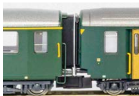
Abstände mit Peko-Köpfen zu Ls von MW-Modell, EW I von Piko und EW II von Brawa
