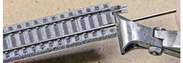
Der Schienenprofil-Überstand wird gradfrei abgetrennt
