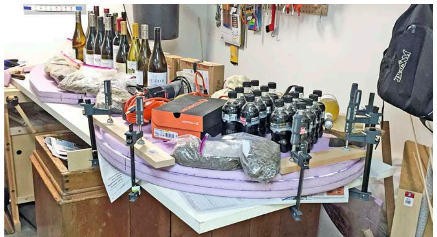
Die Platten sind mit allerlei Haushaltsgegenständen beschwert. Bei Verwendung von Schraubzwingen müssen Holzleisten als Beschädigungsschutz untergeschoben werden
