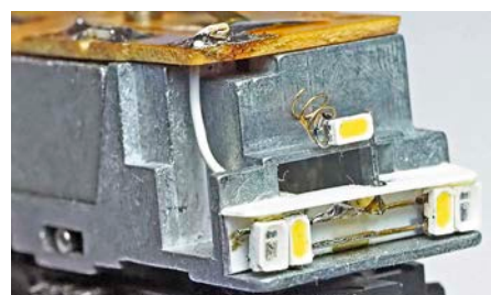
Die untere LED-Einheit ist mit einem Kabel mit der Platine verbunden. Die obere LED hat Massekontakt über eine Feder
