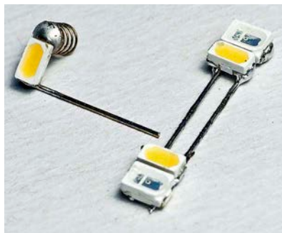
Von links nach rechts: 1) LEDs, die mit ihren Rückseiten auf einem doppelseitigen Klebeband zum Anlöten der Drähte fixiert sind, 2) die Beleuchtungseinheit je Lokseite bestehen aus der oberen LED mit Kontaktfeder und Draht sowie der unteren mit den an den Drähten aufgelöteten vier LEDs für die Lampen und roten Lichter, 3) die untere Einheit mit der kleinen Messinglasche und dem angelöteten Kabel
