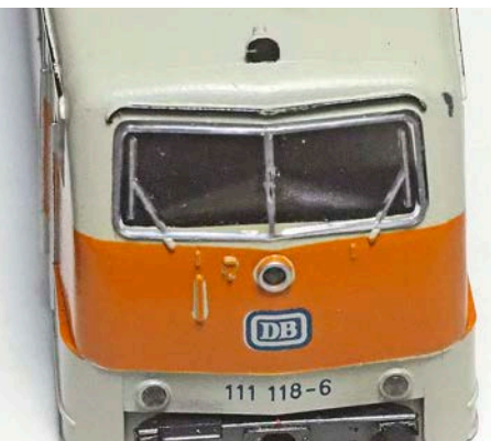
Hier folgt die Anordnung der LEDs dem Lochabstand in der Front, sodass die weißen jeweils zentriert zum Lampenglas liegen. Man beachte, dass dabei die roten LEDs nahe der Chassisaußenkanten und eingezogen, abgerundeten Führerstandsecken sitzen. Allerdings ist es nicht zwingend notwendig, sie dort zu belassen, da die beiden weiß/roten LED-Paare auch perfekt mittig zur jeweiligen Lampenöffnung platzierbar sind. Aufgrund der LED-Lichtstärken wäre auch bei dieser Alternative das Leuchterverhalten der Lampen überzeugend
