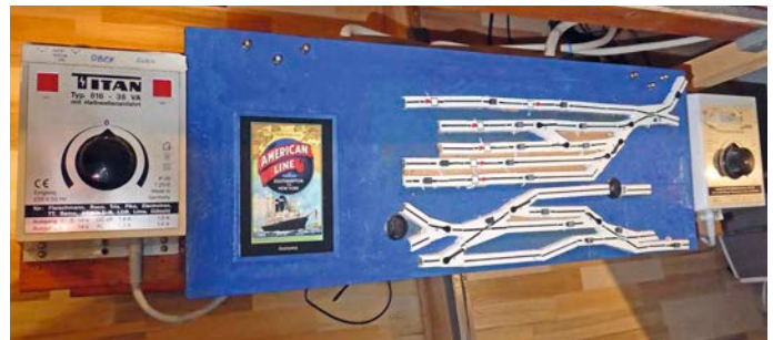
Das Gleisbild-Stellpult ist mit Elementen von Fleischmann aufgebaut. Rechts und links stehen die Titan-Trafoegler für die untere beziehungsweise obere Anlagenebene
