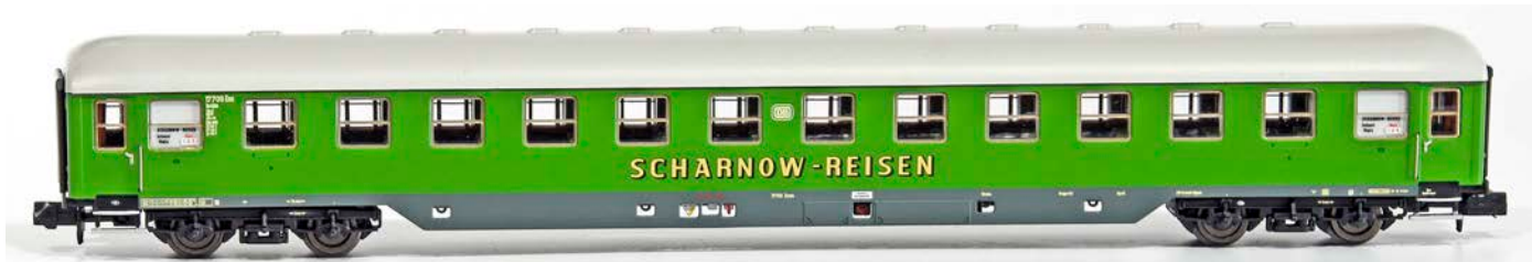
Hobbytrain: Scharnow-Wagen Bc4ümg-54 mit normalen Abteilen (oben) sowie Bc4ümg-53/60 mit Vorzugsabteilen und ohne Schürze
