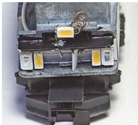
Hier folgt die Anordnung der LEDs dem Lochabstand in der Front, sodass die weißen jeweils zentriert zum Lampenglas liegen. Man beachte, dass dabei die roten LEDs nahe der Chassisaußenkanten und eingezogen, abgerundeten Führerstandsecken sitzen. Allerdings ist es nicht zwingend notwendig, sie dort zu belassen, da die beiden weiß/roten LED-Paare auch perfekt mittig zur jeweiligen Lampenöffnung platzierbar sind. Aufgrund der LED-Lichtstärken wäre auch bei dieser Alternative das Leuchterverhalten der Lampen überzeugend
