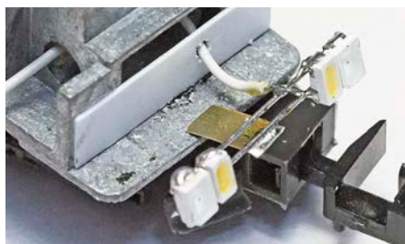
Am unteren Pol ist ein Massekontaktleuchblech angelötet. Der obere wird über ein isoliertes Kabel mit der alten Platine verbunden
