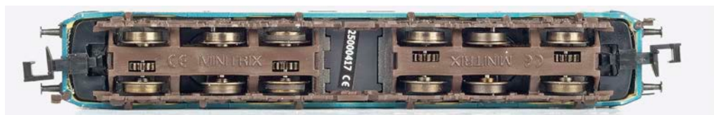
Die Drehgestellrahmen sind aus Kunststoff. Auf einem inneren Radsatz sitzen zwei Haftreifen
