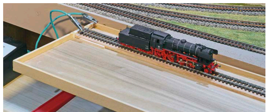
Mit Klammern befestigtes separates Programmier- und Testgleis auf einem schnell abnehmbaren Tablett aus Holz
