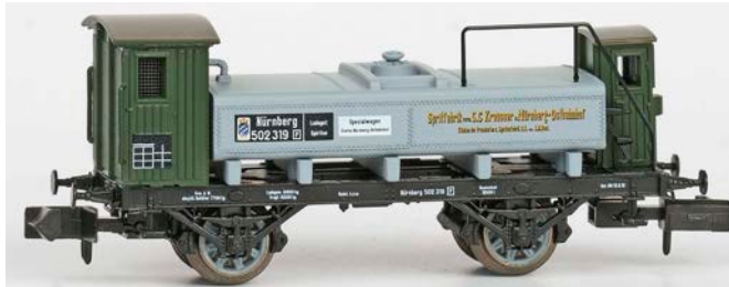
Wagen mit Pumpen- und Bremserhäusern
