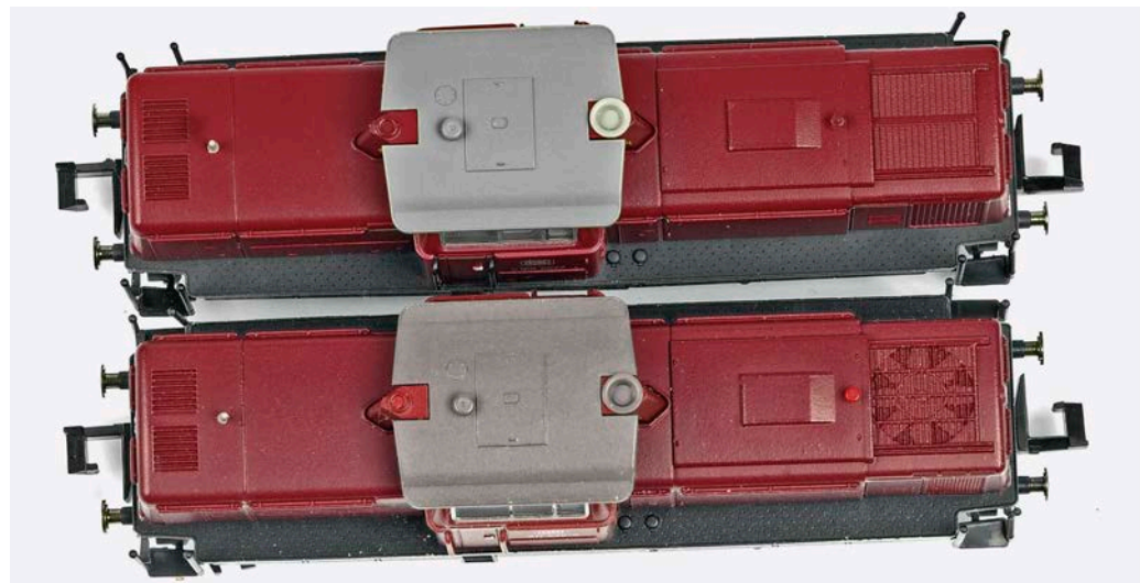
Fleischmann: die neue DB V 100 2027 oben und die 211 236-5 im Aufsichtvergleich. Offensichtlich sind die Unterschiede im vorderen Bereich der beiden längeren Vorbauten zueinander
