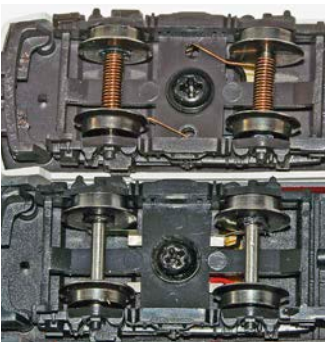
Arnold: Der DB AG Bybdzf hat nun Achsstromabnahme über Drahtspiralen (Bild oben)
