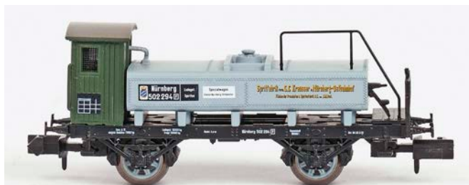
Wagen mit einem Pumpenhaus und Bremserbühne
