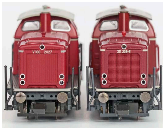
Fleischmann: Die unterschiedlichen Stirnseiten-Lüftergitter der langen Vorbauten bei der DB V 100 2027 links und der 211
