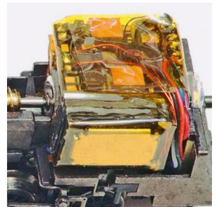
Der fertige Einbau: Der Lautsprecher mit Schallkapsel befindet sich links vom Motor. Hinter dem Lautsprecher ist Platz für die Führung der Leitungen. Alle offenen Kontakte sind gut mit Klebeband isoliert
