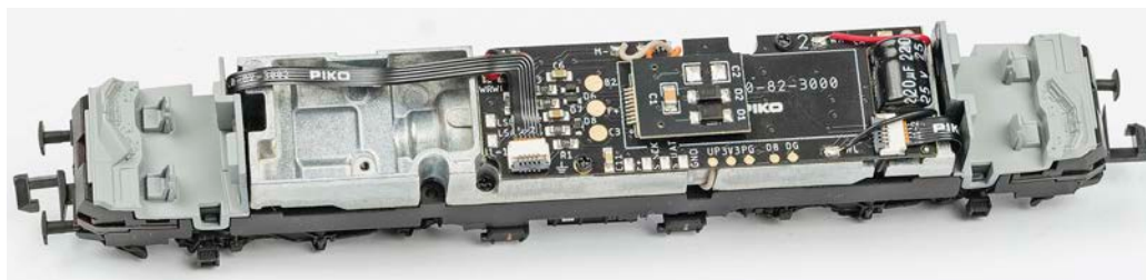
Piko: Das massive Chassis der 152 sorgt für gute Traktion. Links ist Freiraum für Digitaltechnik zu sehen. Die Next18-Schnittstelle liegt auf der Platinenoberseite, vor dem Führerstand ein Kondensator
