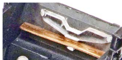
Die bearbeiteten Teile des getrennten Lichtleiters werden wieder eingebaut und mit einem lichtundurchlässigen Blech beleuchtungstechnisch getrennt
