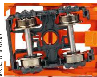
Drehstell mit teilweiser Bremsanlagen-Nachbildung
