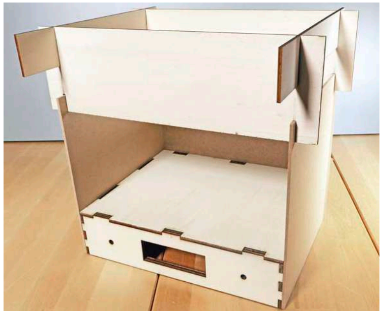
So wird der Abstützrahmen von oben auf den Dioramenkasten gesteckt. Ein Verkleben oder Anschrauben erfolgt nicht. Er verhindert das Verrutschen im dazu passenden Versandkarton
