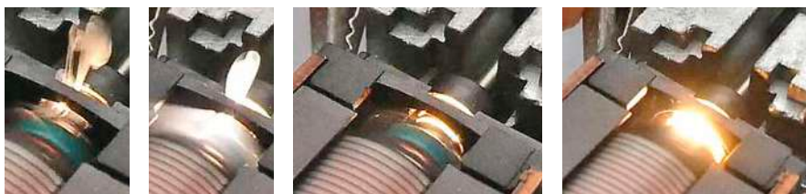
Im Kollektor hat zwischen den Kohlen ein Plasma gezündet (1. u. 2. Bild), zunächst nur als einzelne Ringe (3. Bild). Schließlich füllt das Plasma den gesamten Kollektorraum aus (4. Bild). Der Motor blieb wegen der kurzen Demolaufzeit dabei noch schadenfrei
