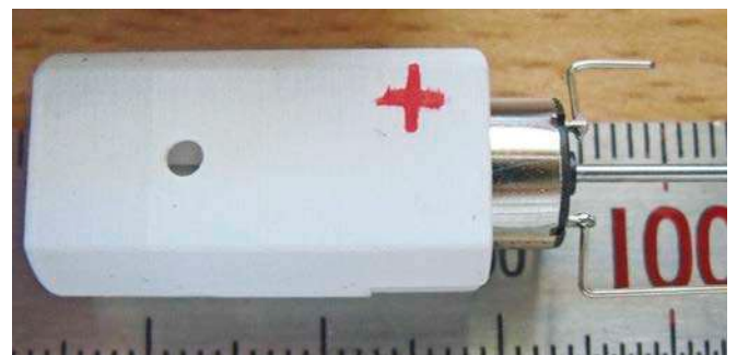
Statt Kabel wird je ein Anschlussdraht in die Kontaktfahnen des Motors gesteckt und anschließend vorsichtig verlötet
