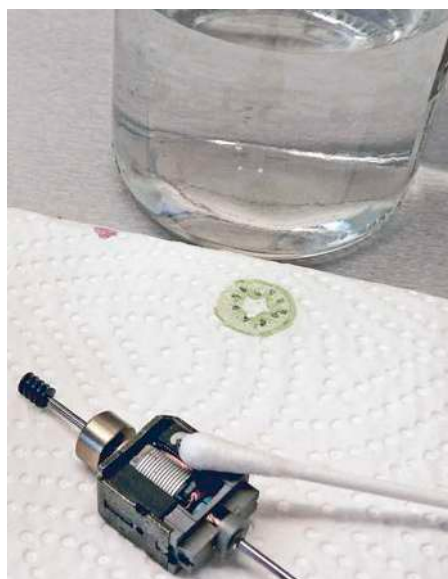
Eine Schnellentfettung mit Wattestäbchen und Waschbenzin. Danach Motor unbedingt gut ausblasen und testen (Brandgefahr und gute Lüftung beachten!)
