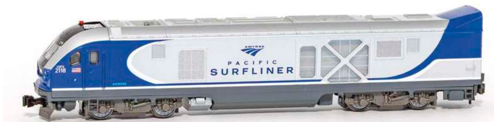
Die SC-44 (Vectron-Basis) in der abgeänderten Ausführung für den Pacific Surfliner
