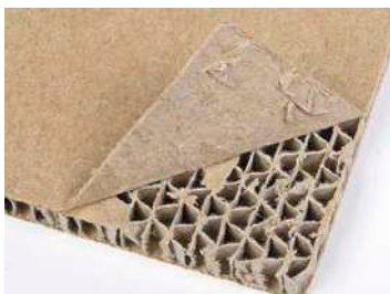
Diese verklebte Wabenstruktur macht den speziellen Baukarton so widerstandsfähig
