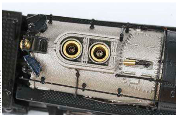
Minitrix: Es sind beide Triebwerk der Class 4000 wegen der Modellkurvenläufigkeit als Drehgestelle ausgeführt. Am hinteren sind die Nachläufer direkt befestigt. Die Vorläufer können kinematisch ausschwenken. Das Tenderdrehgestell ist dreh- und seitenverschiebbar
