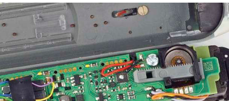
Minitrix: 103.1 mit Stromabnehmer-Antrieben, rechts einer der Motoren, der auf den Zahnstangenschieber wirkt
