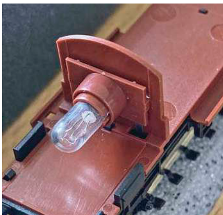
Im Originalzustand steckt eine Fadenbirne in einer runden Wandhalterung mit aufgeschobener Anschlussdrahthalterung
