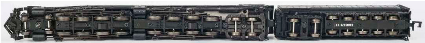
Minitrix: Es sind beide Triebwerk der Class 4000 wegen der Modellkurvenläufigkeit als Drehgestelle ausgeführt. Am hinteren sind die Nachläufer direkt befestigt. Die Vorläufer können kinematisch ausschwenken. Das Tenderdrehgestell ist dreh- und seitenverschiebbar
