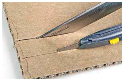
Mit dem feineren Messer vorne gelingt der Schnitt durch den Karton präziser, ohne die Schnittkanten einzudrücken
