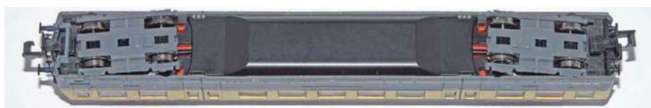
Zwei lange Kardanwellen treiben alle Achsen an. Es sind zwei Haftreifen aufgezogen
