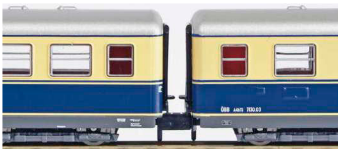
Der Kuppelabstand mit den beiliegenden Klauenköpfen
