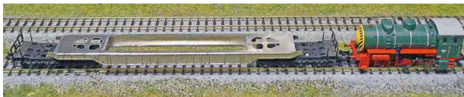
Der noch unlackierte SSt 422 mit geätzter Ladebrücke auf Fleischmann-Drehgestellen
