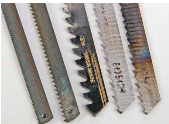
Links Metall- sowie Holz-Blatt für Bügelsäge – in der Mitte ein Span/Multiplexplatten-Blatt, rechts ein Holz-Blatt neu und außen dito unbrauchbar, da heißgelaufen, für elektrische Stichsäge
