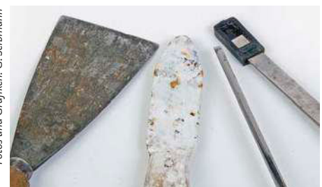
Von links nach rechts: Spachtel zum Auftragen, Abschaben und Trennen – Kittmesser für Spachtelarbeiten – schmaler und breiter Stechbeitel mit Schutzkappe, die vor Verletzungen sowie die scharfe empfindliche Stichkante schützt
