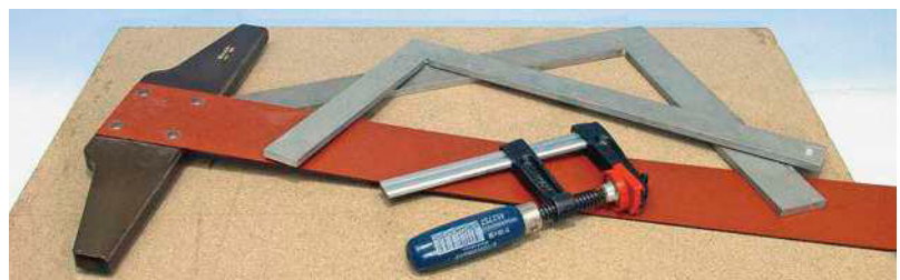
Metallwinkel und Reißschiene zum Anzeichnen von Schnittlinien. Mit kleinen Schraubklemmen können sie bei Bedarf am Werkstoff fixiert werden
