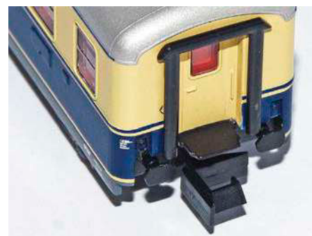
Die Übergangsbleche ragen feststehend am Wagenkasten hervor
