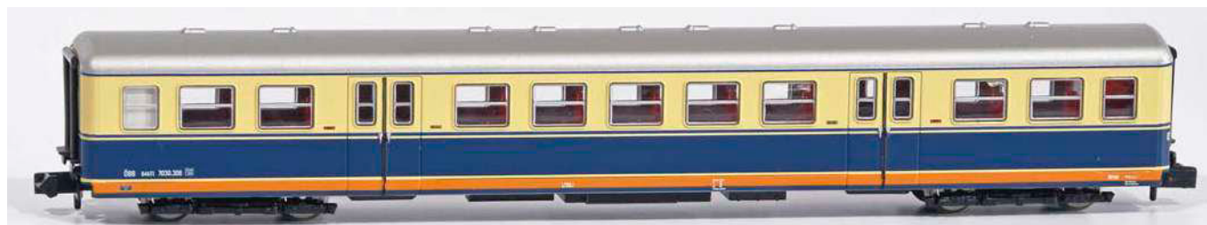
Der 2. Klasse Zwischenwagen B4hTI 7030.3. Alle Drehgestellrahmen sind zur Kurvenbeweglichkeit oben stark beschnitten
