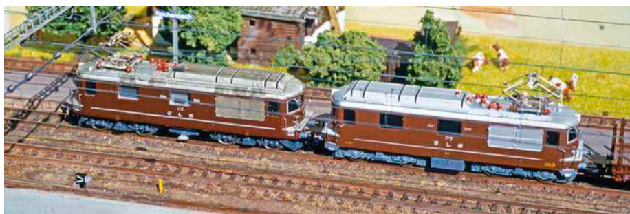
Auch diese Doppeltraktion erzählt Modellbahngeschichte: Arnold rapido brachte auf dem Fahrwerk seiner alten SBB Re 4/4 II eine zu hohe unförmige BLS Re 4/4 heraus. Diese verleitete zu einem Umbau des Gehäuses auf einem Minitrix-Fahrwerk. Dahinter läuft das von Arnold selbst korrigierte Modell auf Basis der neueren SBB Re 4/4 II mit zwei Pantos
