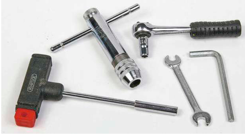
Bithalter mit T-Griff – Werkzeughalter mit Knarre – Knarre in Winkelform – Maulschlüssel für Sechskant außen – Inbus-L-Stiftschlüssel für Sechskant innen
