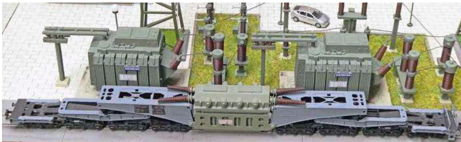
Der SIKI-600 bei Anlieferung eines Transformatortransportes zu einem Unterwerk der Bahnstromversorgung
