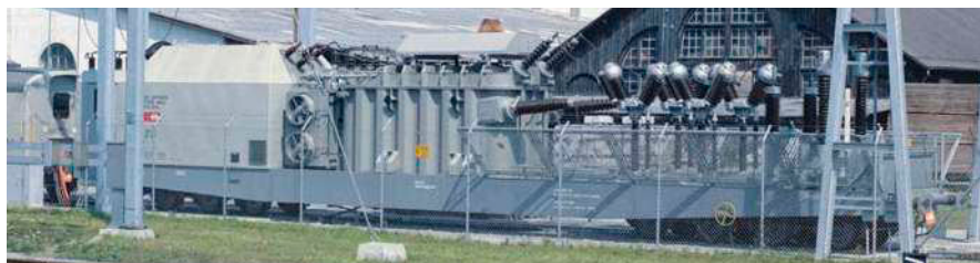
In einem achtsachsigen Schwerlast-Durchladewagen ist der Trafo des SBB KW-DU in St. Margrethen (1987) eingebaut. Dazu gehört noch ein umgebauter Leichtstahlwagen
