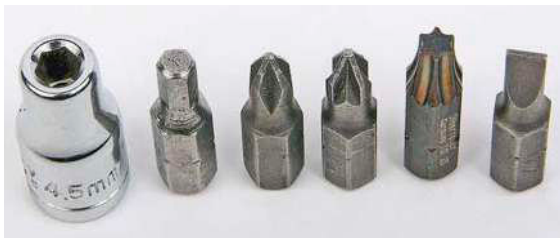
Bit-Typen für Schrauben: Sechskant außen 4,5 mm, Sechskant Inbus 4 mm, Kreuzschlitz Phillips PH1, Kreuzschlitz Pozidriv PZ1, Torx T25 und Klinge 4,5 mm
