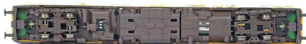
Liliput: Es ist ein Drehgestell angetrieben, DIP-Schalter am Boden für die Funktionssteuerungen
