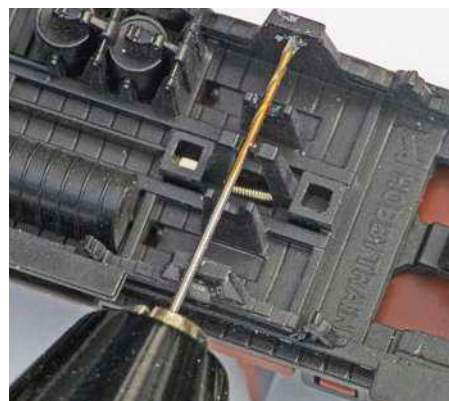
An der Stelle mit der Körnung wird mit einem 0,5 mm dicken Bohrer in einem Stiftenklöbchen vorsichtig vorgebohrt (nicht die Achslagerblende durchstoßen!)
