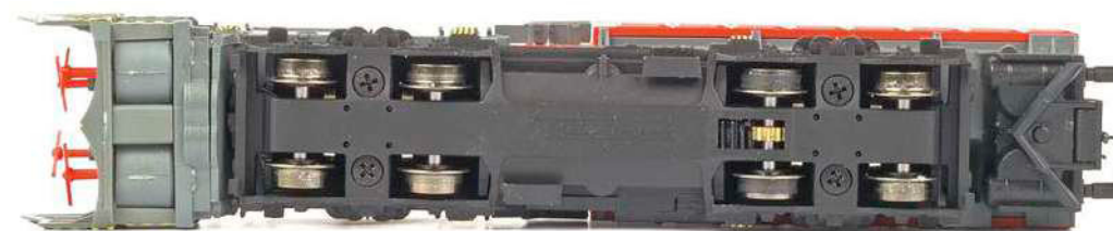
Fleischmann: Die Drehgestelle sind nur angedeutet, die Räder liegen in einem starren Rahmen
