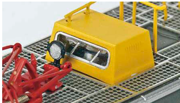
Die Beobachtungskabine neben dem Pantografen hat Scheibenwischer und davor eine Scheinwerferattrappe
