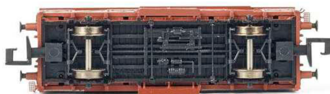
Der Wagenboden hat eine freistehende Bremsanlage
