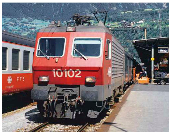
Die Nr. 10102 noch mit steingrauen Seitenwänden auf der Fahrt nach Lausanne in Brig 1985. Man erkennt unten die seitlich eingebauten roten Schlusslampen und beim oberen Scheinwerfer rechts das Fahrtberechtigungssignal. Rechter Hand des linken Puffers ist oberhalb ein Handgriff angebracht
