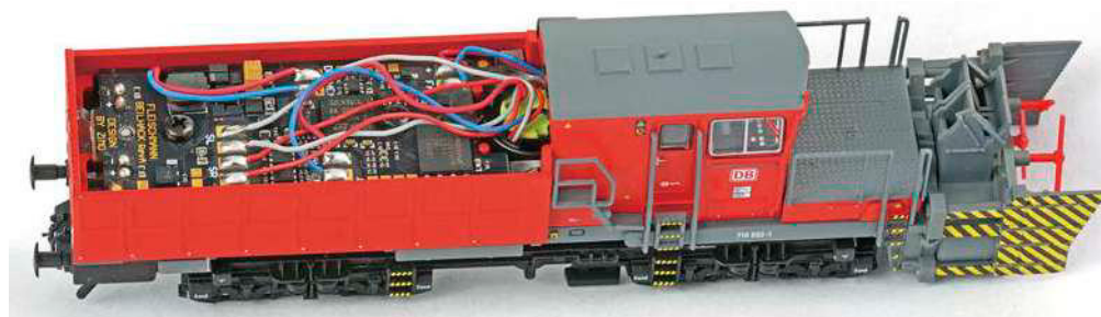
Fleischmann: Blick ins Innere des Maschinenaufbaus, der die Komplexität erahnen lässt
