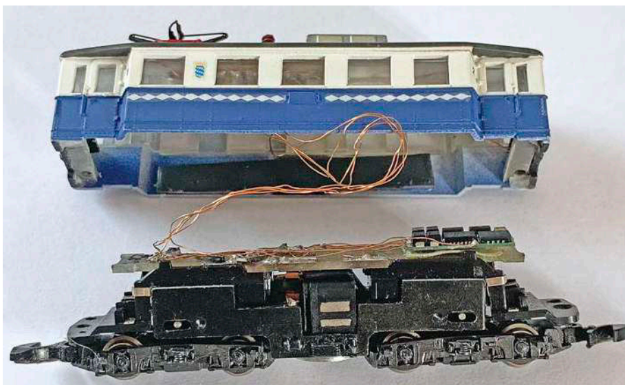
Die Triebwagen bestehen aus einem Z-Chassis und einem N-Gehäuse des VT 75.9
