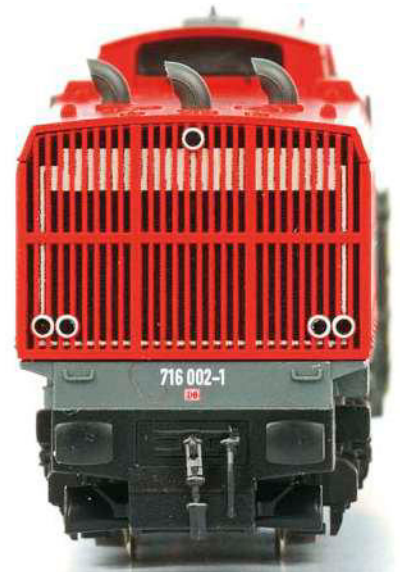
Fleischmann: Gut gelungen ist das täuschend echt wirkende Gitter an der Rückfront. Es handelt sich aber nur um präzise Farbeinträge in die Stegzwischenraumvertiefungen
