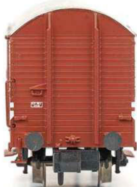
Griffstange und Tritt sind angesetzt
