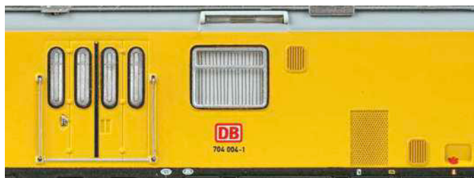
Liliput: Beschriftung des DB AG 704 und die aufwendige Detaillierung mit gummi gefassten Fenstern und angesteckten Griffstangen
