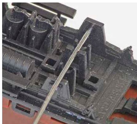
Knapp unterhalb der Markierung (= näher zur Schiene) wird mit einer Nadel die tatsächliche Lagerbohrung angekört
