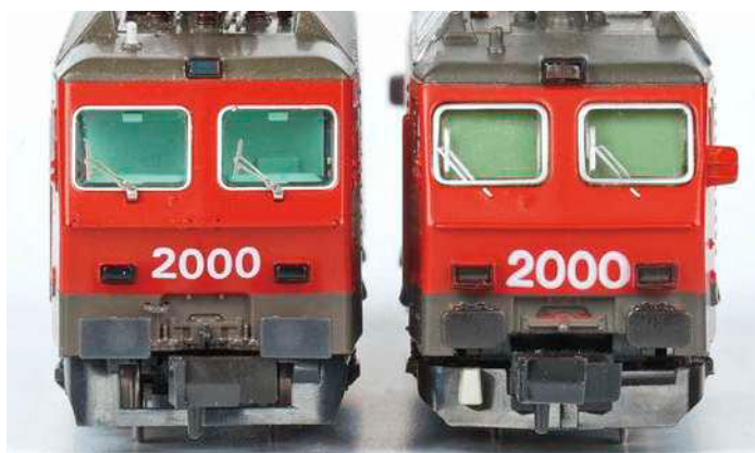
Auffällig sind die Unterschiede bei der Frontgestaltung: Das Hobbytrain-Modell hat größere Scheiben mit feineren Rahmen, zierlichere Scheibenwischer, kleinere Scheinwerfer, eine vollständig ausgestaltete Pufferbohle inklusive Rangiergriff und Zughakenlagerung sowie tiefer liegende Puffer
