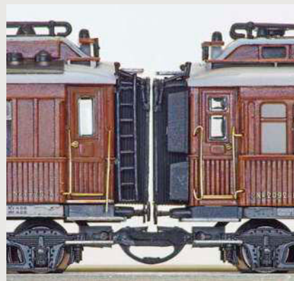
So gering ist der Abstand nur, wenn die Kupplungsköpfeverbindung 3,5 mm kürzer als die Normvorgabe ist (hier ein eigenes 3D-Druck-Entwicklungsprojekt)
