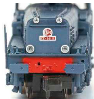
Arnold: Die Pufferbohle der CC 14100 bietet die Option, Zurrüstteile anzubringen
