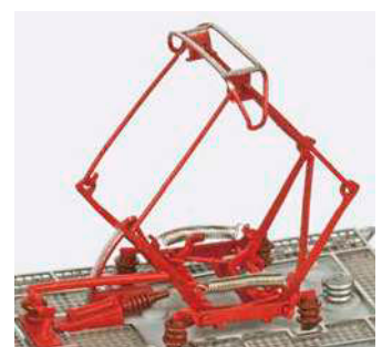
Ein umgedrehter Pantograf mit der Öffnung für den Antrieb und Hubanzeiger nach innen
