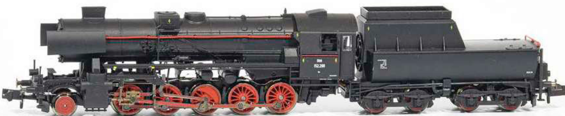
Fleischmann: ÖBB 152 mit Giesl-Ejektor und Kohlenkastenaufsatz
