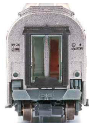
Stirnseite mit den typischen Glastüren, Schlusslampen und Stromversorgungskabeln
