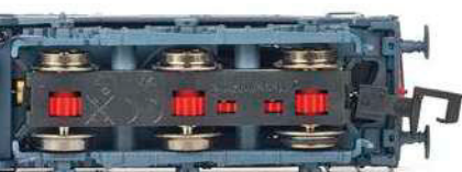
Arnold: Alle Achsen der SNCF CC-14100 werden angetrieben
