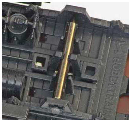
Zunächst wird die theoretisch ideale Position der Achse mit einer in den Aufnahmen befindlichen, einseitig gekürzten Spitzenlagerachse auf der Innenseite der Achslagerblenden markiert
