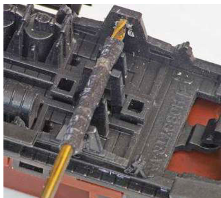
Die Lagerbohrung wird mit dem speziell geschliffenen kleineren Peho-Lagerbohrer von Hand fertig gebohrt
