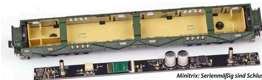
Minitrix: Die Bremsanlage ist angesteckt. Der Strom wird von den Achsen abgenommen
