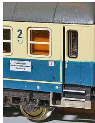
Eichhorn Modellbau: Klapptritte für die Bm 234 und 235
