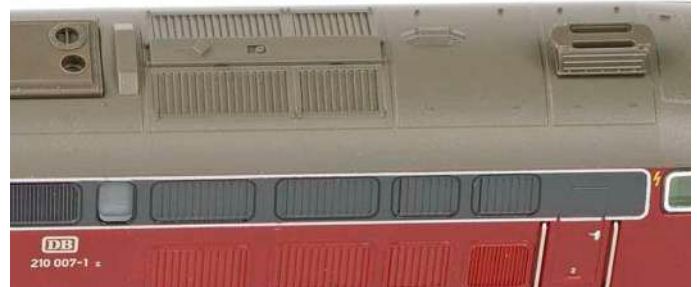
Fleischmann: die von der Serien-218 abweichende Dachausrüstung mit der länglichen, hohen Auspuffhütze
