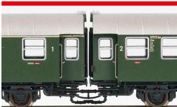
Piko: Die Wagen sind recht eng mit einem Steg gekuppelt, der auch die Andeutung von Brems- und Heizkupplung hat
