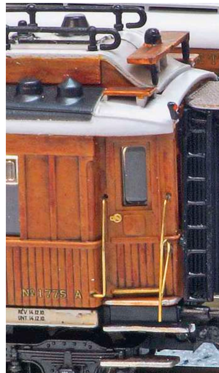
Die montierten neuen Griffstangen aus hartem Messingdraht
