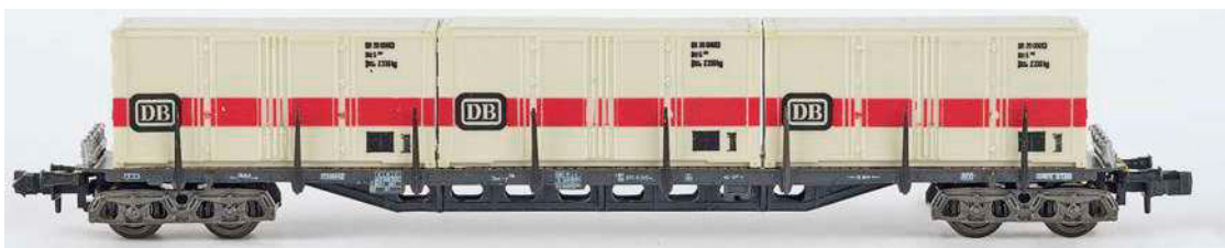
Röwa: Der Sss-y 716 bietet drehbare und senkrecht einrastende Rungen sowie drei damals zeitgemäße DB-Binnencontainer
