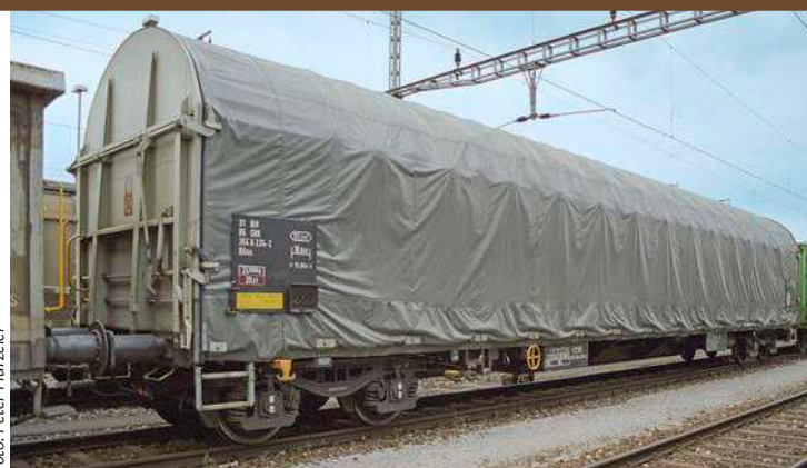
Durchaus gewellt und geknittert erscheint die PVC-beschichtete Plane dieses von den SBB gemieteten Rilns, Spreitenbach 2003
