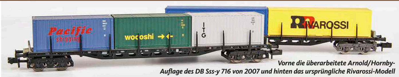
Rivarossi/Atlas: Der Sss-y 716 hat feststehende Rungen und einen vollständig durchbrochenen Untergurt
