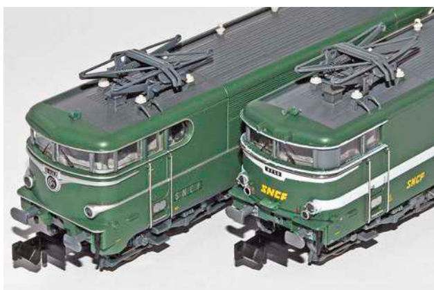
Stirnseiten der älteren BB 9200 (links) und der neuen Modelle nun mit Tritt, umlaufenden Griffstangen, Schlusslampen sowie entfernten Eck- und hinteren Seitenfenstern
