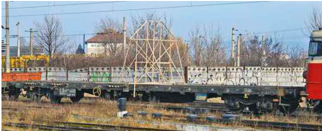
Ein zweckentfremdeter Rs als behelfsmäßiger Lichtraumprofil-Prüfwagen, aufgenommen 2013 in Rumänien
