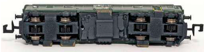
Angetrieben werden alle Achsen, die keine Haftreifen haben
