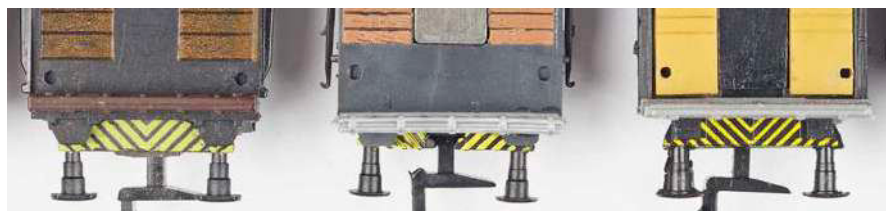
Bei Minitrix und Röwa (links und Mitte) ist der Stoßdämpfer-Pufferbalken schwenkend eingelegt, bei Rivarossi und Arnold am Boden feststehend angeformt (rechts u. unten)
