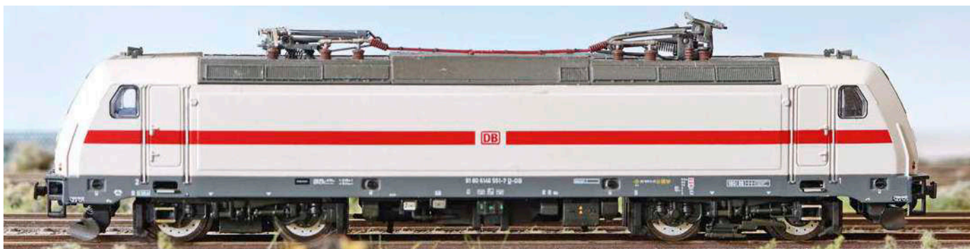
Links ist auf der DB AG 147 von Arnold der fligranere Einholmstromabnehmer von der DB AG 101 von Piko montiert
