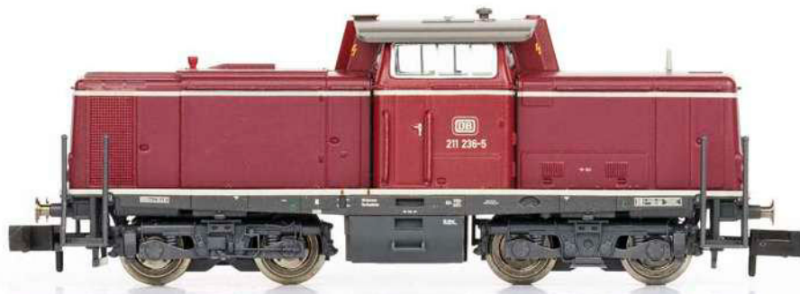
Der Lokaufbau samt Umlauf sitzt durchgängig horizontal auf dem Chassis. Die Drehgestelle sind fein graviert. Gezeigt ist der Zustand ohne angesetzte große Bahnräume
