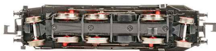
Direkt über Zahnräder wird nur der rechte äußere Radsatz angetrieben. Von den Kuppelstangen weitgehend verdeckt sieht man von unten die Treibstangen. Es sind beidseitig Kurzkupplungskinematiken vorhanden
