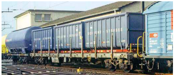
Dieser zum Muldentransport umgerüstete Wagen der SBB wurde als Rs-x bezeichnet, Aarau 1988
