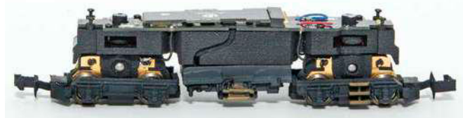
Antriebschassis mit mittigem Motor und Next18-Schnittstelle
