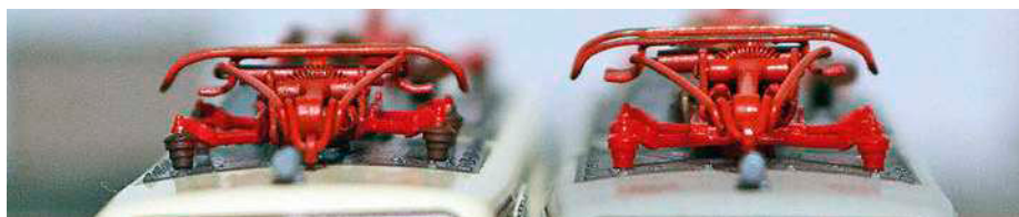
In der Seiten- wie in der Frontansicht wirkt der tiefergelegte Stromabnehmer auf der 111 von Fleischmann auch im gesenkten Zustand gefälliger und maßstäblicher
