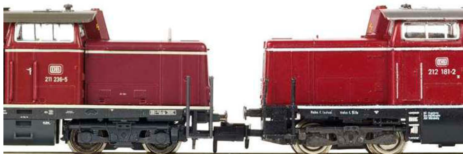
Diese Ansichten der Fleischmann-Generationen zeigen die Höhenprobleme vor allem der Puffer und des Führerhauses der 212 rechts
