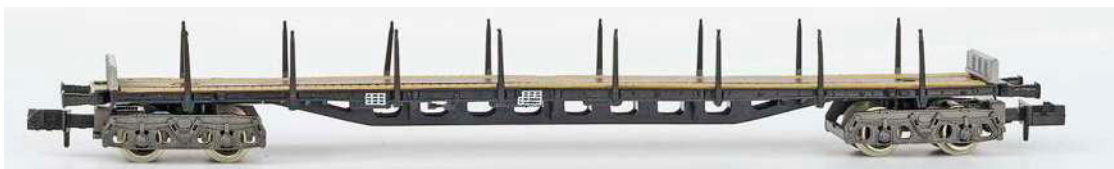
Rivarossi/Atlas: Der Sss-y 716 hat feststehende Rungen und einen vollständig durchbrochenen Untergurt
