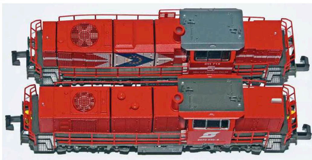
Hobbytrain: Die G1000 BB der HGK (oben) und die G800 BB der ÖBB haben unterschiedliche Vorbauten. Die ÖBB 2070 ist außerdem mit gelben Ranigerüberwurfkupplungen ausgerüstet
