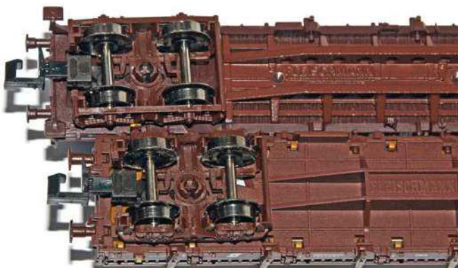
2004 überarbeitete Fleischmann seinen Rs und stattete ihn mit einer Kurzkupplungskinematik ähnlich dem Res aus (unten)
