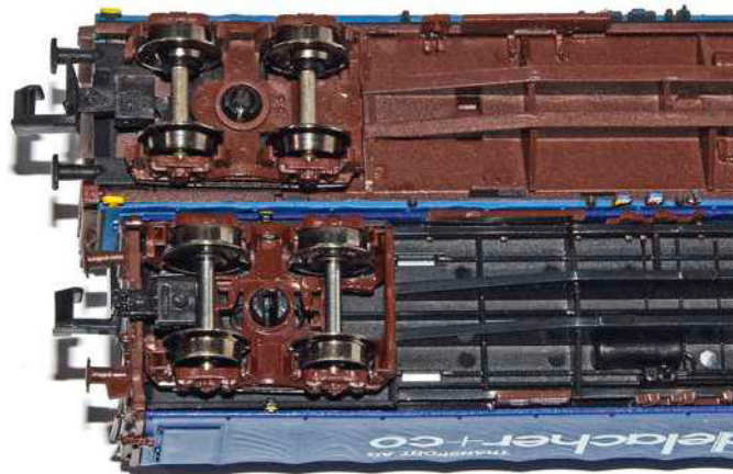
Im Vergleich zu Minitrix der detailliertere Boden mit Bremsanlage des rund 10 Jahre jüngeren Res von Fleischmann (unten)
