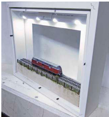
Batterie-LED-Leuchten eignen sich nur bedingt, da sie zugänglich sein müssen
