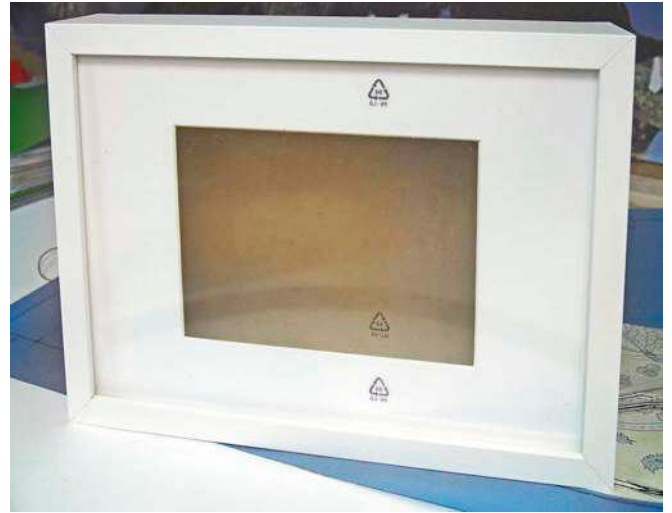
Der kleine Rahmenkasten im Rohbau mit vorgesetzter Polystyrol-Scheibe (noch mit Schutzfolie überzogen)
