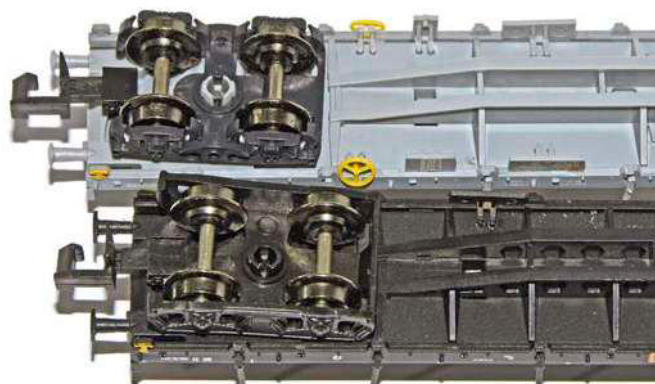
Die Minitrix-Neukonstruktionen von 2008 berücksichtigen unterschiedliche Drehgestelle, Langträger und Anschriftentafeln
