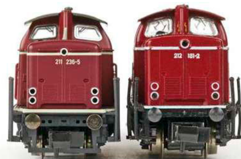
Diese Ansichten der Fleischmann-Generationen zeigen die Höhenprobleme vor allem der Puffer und des Führerhauses der 212 rechts
