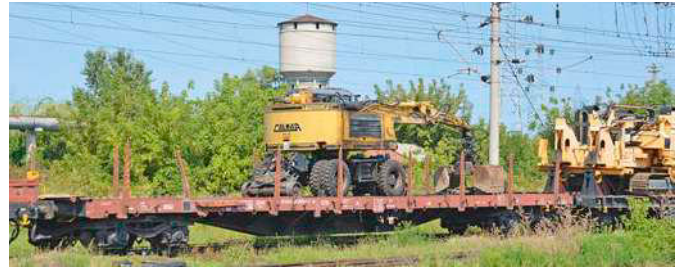
Zwei-Wege-Bagger auf „Abwegen“ auf einem CFR Infrastructura Rs im rumänischen Iasi 2021
