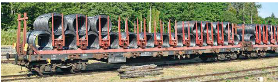
DB AG Rs-y 667 mit Sonderaufbauten für den Drahtrollentransport, Port-d'Atelier 2023
