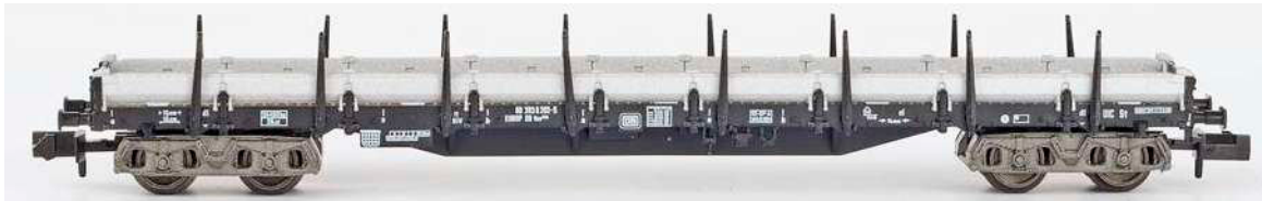
Fleischmann-Nachbildung des Res 686 aus 1989 noch mit metallisch silbern eingefärbten Drehgestellen und KKK
