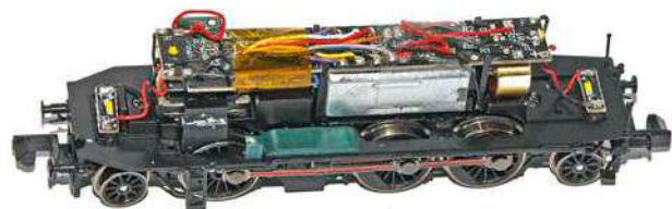
Der Sounddecoder ist unter der Platine über der Schnecke angelötet. Der Lautsprecher befindet sich am Boden des Führerstandes. Rechts erkennt man noch die kleine Schwungmasse
