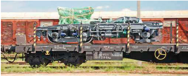
Etwas ungewöhnlich ist hier 2012 der improvisierte Transport auf einem Rs von kompletten Breitspur-Drehgestellen samt Getriebe
