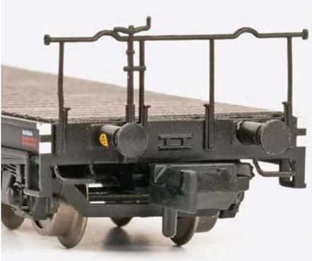
**Das feine Geländer mit Bremskurbel kann an einer Stirnseite eingesteckt werden**
