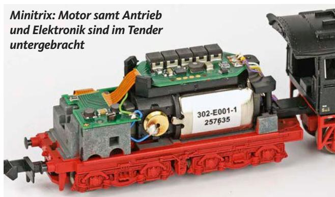
**Minitrix:** Motor samt Antrieb und Elektronik sind im Tender untergebracht
