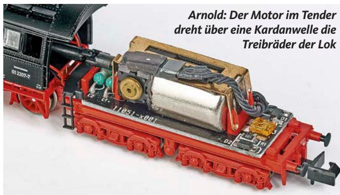
**Arnold:** Der Motor im Tender dreht über eine Kardanwelle die Treibräder der Lok
