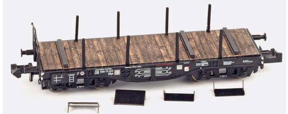
**SSys mit montierten Rungen und Bühnengeländer samt Handbremskurbel. Davor liegen die aus Metall gefertigten Überfahrbleche der DRB-Modelle zur Ladeszenendarstellung**
