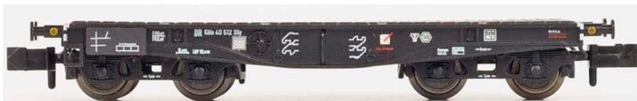
DRB SSy mit verstärktem Fischbauchträger und Deutz-Drehgestellen
