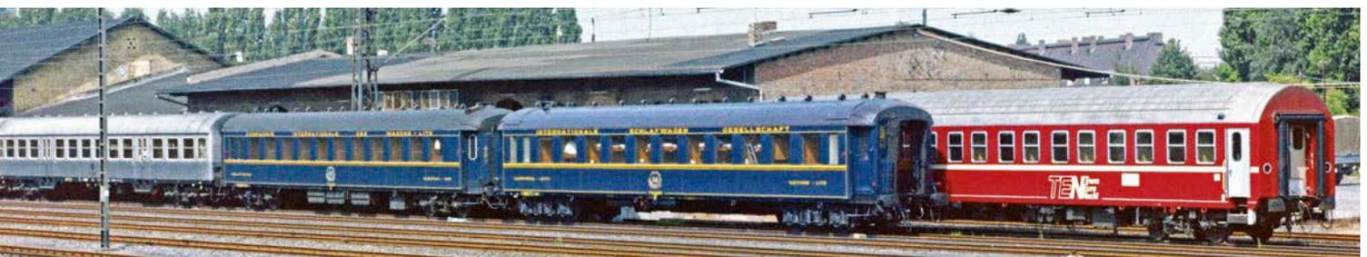
Schlafwagenverkehr im Umbruch: zwei umgebaute Altbau-WL Typ Y der ISG abgestellt vor einem modernen TEN WLA sm T2s mit den ursprünglichen Übersetzfenstern noch in der roten Farbe der DSG. Die Oldtimer sind modernisiert mit Drehgestellen der Bauarten Minden-Deutz (links) und SIG. Der linke hat Türfensterrahmen und weist in Silber angemalte Wappen auf, Frankfurt Süd Gbf 1975
