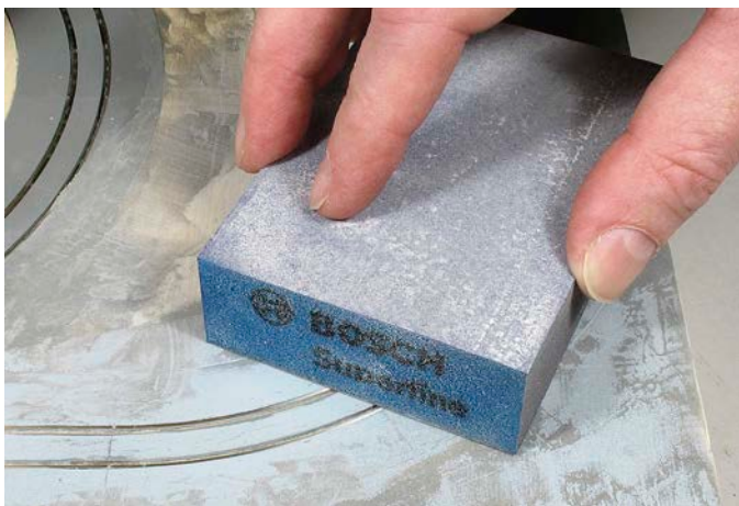
Die gespachtelte Straße samt Gleis wird mit einem feinen Schleifklotz geglättet
