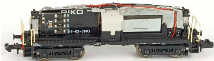
Jeder Zehntelmillimeter ist ausgenutzt: links die Schnittstelle, rechts der Motor
