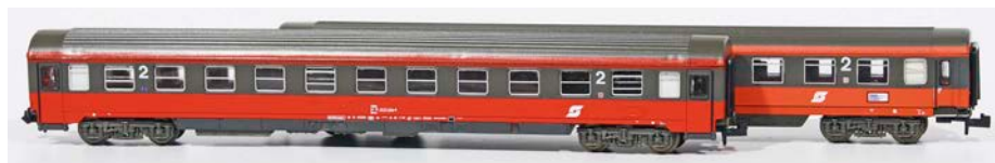
Durch Fenstertausch zwischen den Modellen von Roco und Fleischmann erhält man vorbildgemäße ÖBB Bmz 21-70.5 mit Übersetzfenstern und 21-70.0 mit Drehfalttüren
