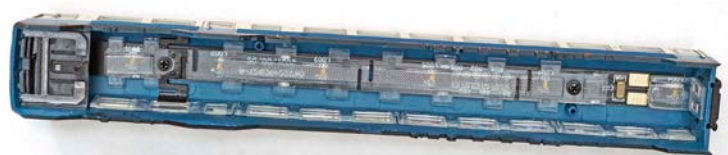
Liliput: Eine Innenbeleuchtung mit Lichtleiter ist bereits eingebaut
