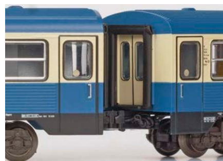
Liliput: Der 628.0 besitzt einen angedeuteten Gummiwulstübergang und farblich detaillierte Schiebetüren
