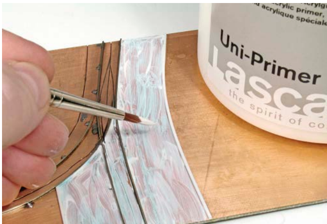
Damit die Modelliermasse auf der Platte anhaftet, wird die Kupferschicht mit einer Acryl-Grundierung überzogen
