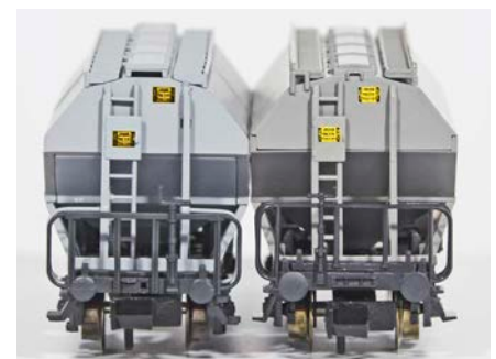
An den Spalten erkennt man die unterschiedlich konstruierten Stirnseiten
