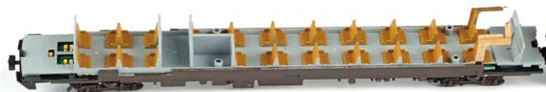
Liliput: Die Inneneinrichtung des motorlosen Teils mit Vis-a-vis-Sitzbänken. Die Deckenbeleuchtung erhält Strom über Federbleche
