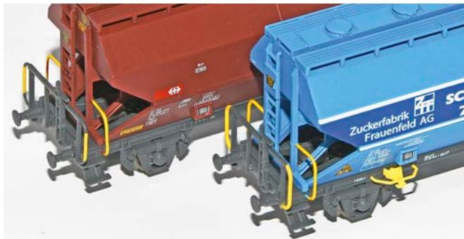
Der Zuckerwagen rechts hat die zusätzlichen zwei Konsolen mit Seilhaken zum Verschieben
