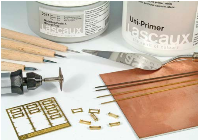
Benötigte Materialien: Grundierung, Modelliermasse, Profile, Spurlehren, kupferbeschichtete Pertinaxplatte und Werkzeuge
