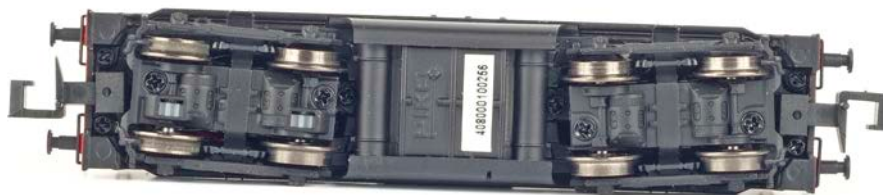
Aufwendig sind die Fahrmotoren des Vorbildes nachgebildet. Es gibt zwei Haftreifen
