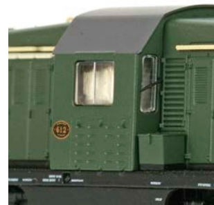
Die NS 612 in der grünen Lackierung der Epoche IIc. An den Stirnfenstern sind auch die Scheibenwischer ab Werk montiert
