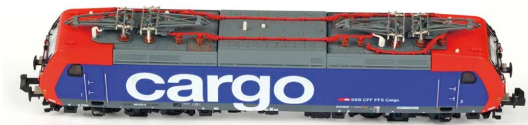
Piko: die Dachaustrüstung mit zwei unterschiedlichen Schleifstücktypen der SBB Cargo Re 482
