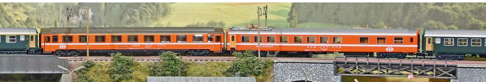
Durch Fenstertausch zwischen den Modellen von Roco und Fleischmann erhält man vorbildgemäße ÖBB Bmz 21-70.5 mit Übersetzfenstern und 21-70.0 mit Drehfalttüren
