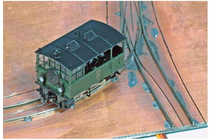
Die Schienenprofile werden direkt auf die mit einer Korundscheibe fahrstromgemäß aufgetrennte Kupferschicht gelötet
