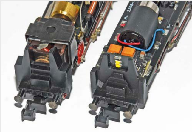
Links älteres Modell ohne Lampen an der Rückfront, rechts das neue Modell mit LED-Beleuchtung
