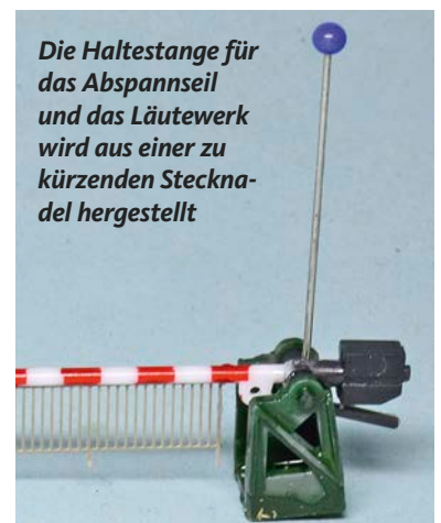
Der fertig montierte Schrankenbaum mit Abspannung
