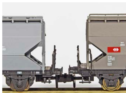
In der Seitenansicht wird der höher liegende Rahmen bei Fleischmann deutlich
