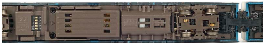
Liliput: Unterseite des Motorwagens. Links sieht man die DIP-Schalter für die Licht- und die Fahrstromfunktionen. Angetrieben wird ein Drehgestell, dessen Räder zwei Haftreifen aufweisen
