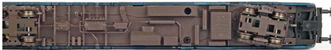
Liliput: der detaillierte Wagenboden des antriebslosen Modellteils
