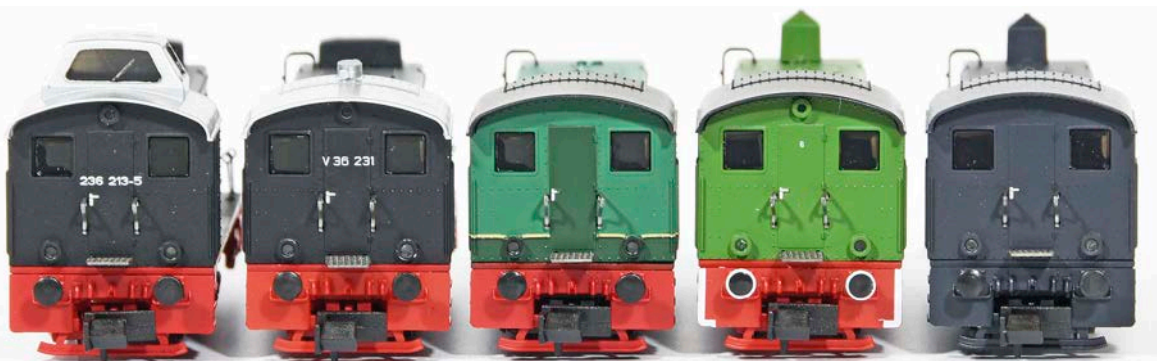
Hobbytrain: Angetrieben werden bei der V 36 direkt die beiden vorderen Achsen. Alle Räder haben Stromabnahmeschleifer
