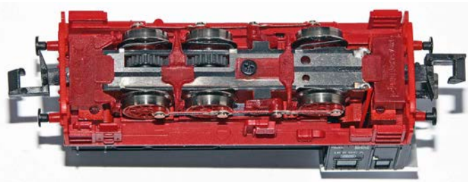
Hobbytrain: Angetrieben werden bei der V 36 direkt die beiden vorderen Achsen. Alle Räder haben Stromabnahmeschleifer
