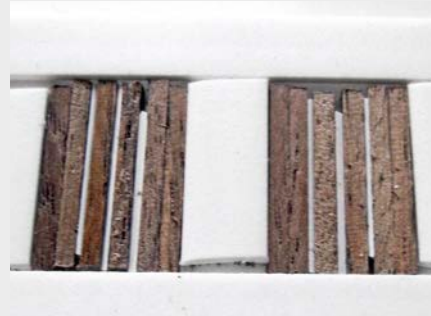
Bei der unteren Lage dienen die äußeren Bohlen als provisorische Anschläge. Zwischen den inneren vier Bohlen sind schmale Polystyrol-Streifen eingefügt
