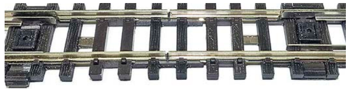
Mittels der Schwellenisolierstöße sind hier zwei Weichen aneinander gesteckt, ohne das Gleisrost optisch zu unterbrechen
