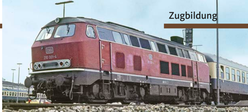
Eine typische Lokbaureihe für die Allgäubahn war die 218-Variante mit Turbine, hier die 210 001-4 im neuen Kemptener Hbf 1978
