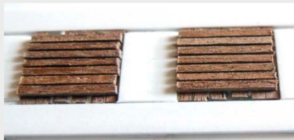
Anhand der vier Fleischmann-Bohlenstapel wird eine Montagelehre aus leicht schneidbarem Styrodur zum Einlegen der Hölzer angefertigt
