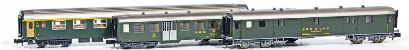
SBB-Reisezugwagen der Epochen III/IV: Am RIC UIC-X (Kato), LS B (Arnold) und Umbau-Stahlpackwagen D (Fleischmann)
