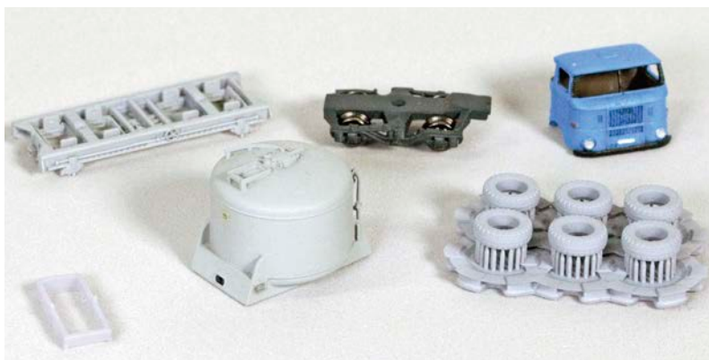
Die Einsatzmöglichkeiten modernster 3D-Feindrucker sind beachtlich, wie die Fahrwerksteile für Schmalspurwagen, der Uce-Behälter und Teile eines LKWs zeigen
