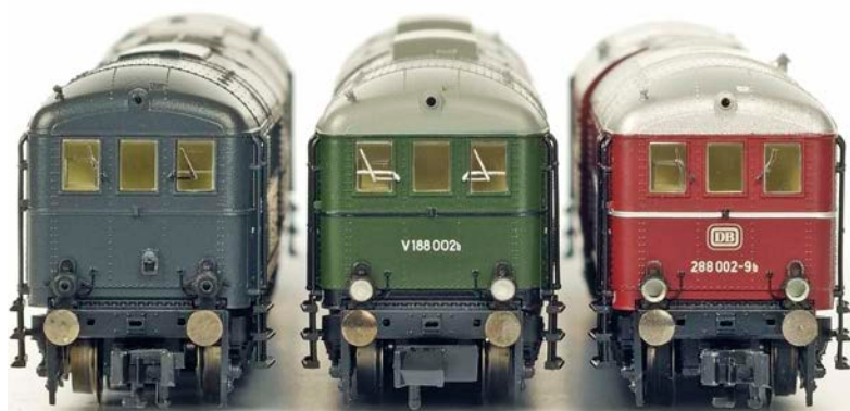
Die Fronten der D 311, V 188 und 288 unterscheiden sich durch die Laternen, E-Kabel-Anschlüsse und Scheibenwischer
