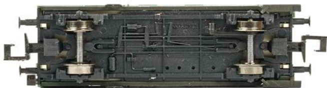
Die Details am Wagenboden sind angeformt
