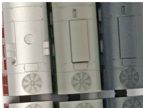
Die drei verschiedenen Dachdetaillierungen der DB Epoche IV, DB Epoche IIIa und der Ursprungsversion
