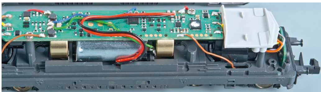
Minitrix: Die V 200 002 wird auf allen Achsen angetrieben. Der Motor hat beidseitig Schwungmassen
