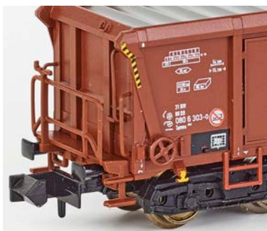
Minitrix: die verschiedenen Stirnseiten des DB Tamns 893 mit Bremserbühne
