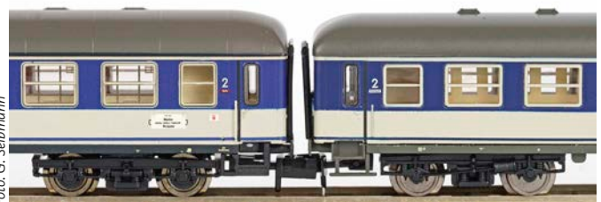
Die neuen Fleischmann-Wagen links harmonisieren mit den entsprechenden Arnold-Modellen in der Pufferhöhe. Sie sind in der Rahmenfarbe und der Dachhöhe sichtbar vorbildgerechter
