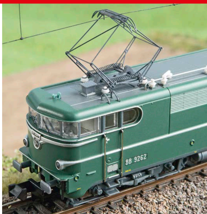
Eichhorn Modellbau: feiner SNCF-Stromabnehmer Typ G als Fertigmodell, hier auf der Minitrix BB 9200 montiert
