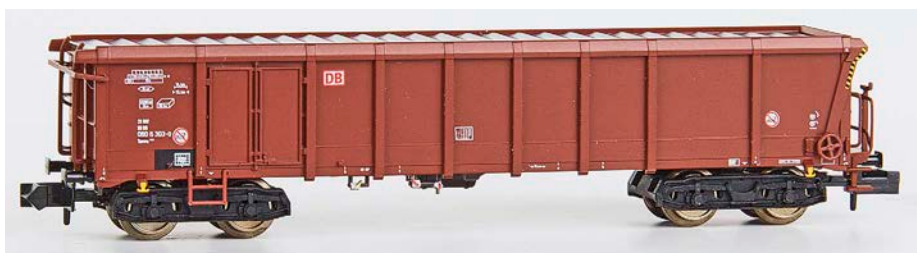
Minitrix: Modell des DB AG Tamns 893 mit Bühne und Rolldach
