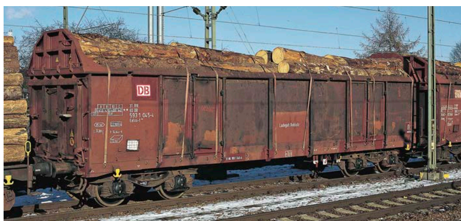
DB AG Ealos-t 058 mit DR-typischer festgelegter Stirnklappe für den Holztransport
