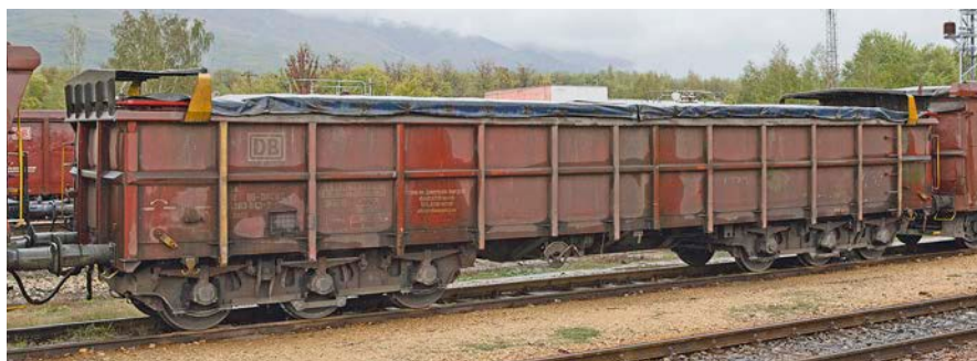
Sechssachsiges Spezialbauart mit zweiteiliger Schiebeplanenabdeckung Eaaos der DB Cargo Bulgaria, die es in Modell allerdings nicht gibt
