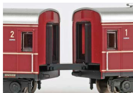
Die Hälften sind kinematisch verbunden
