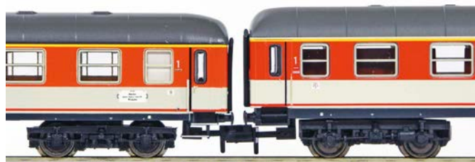
Im Vergleich zum älteren Fleischmann-Modell des gleichen Vorbildes rechts sieht man deutlich den Unterschied in der Fenstergestaltung, bei den Drehgestellen und der Wagenhöhe
