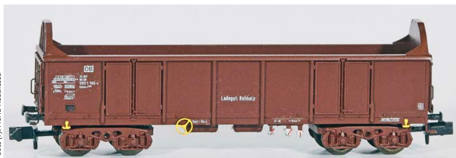
DB AG Ealos-t 058 mit DR-typischer festgelegter Stirnklappe für den Holztransport
