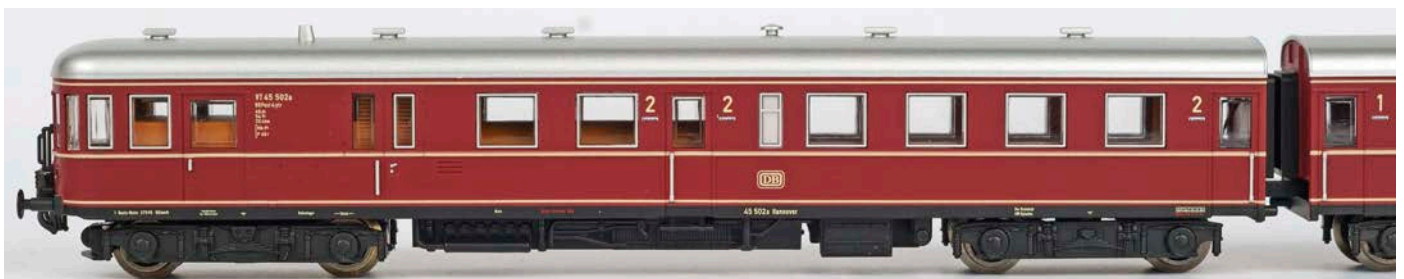
Der DB BDPst4 ytr ist mit dem Modellantrieb ausgestattet. Im Postabteilerbereich befindet sich der Einbauplatz für einen Lautsprecher
