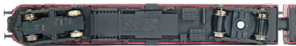
Der Boden der angetriebenen Hälfte. Die Stromabnahme ist im Zug durchgeschleift
