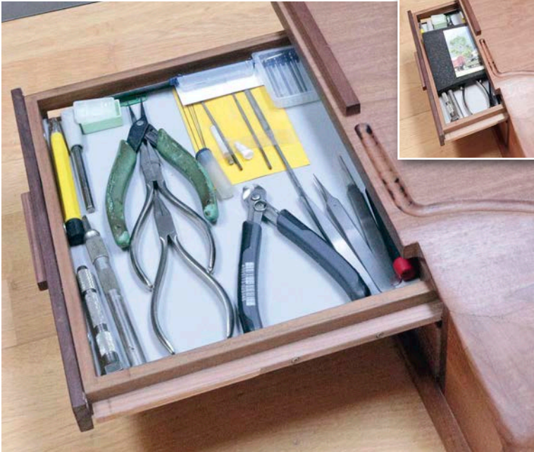
Die mit Moosgummi ausgelegte flache Schublade für feine Handwerkzeuge. Damit beim Transport die Werkzeuge nicht durcheinandergeraten, werden sie mit einem Schaumstoffkissen fixiert. Die aufgeklebte Postkarte erleichtert das Untergleiten des Schaumstoffs beim Einschieben der Schublade
