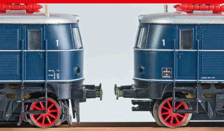
Eichhorn Modellbau: links die mit Bremsbacken und Bahnräumer aufgerüstete Arnold E 19
