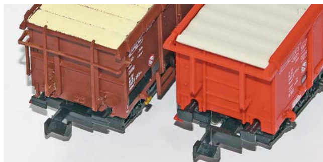
Stirnseitenvergleich zwischen dem Tamns 886 von Fleischmann in Verkehrsrot und dem Tamns 893 von Hobbytrain in Rotbraun
