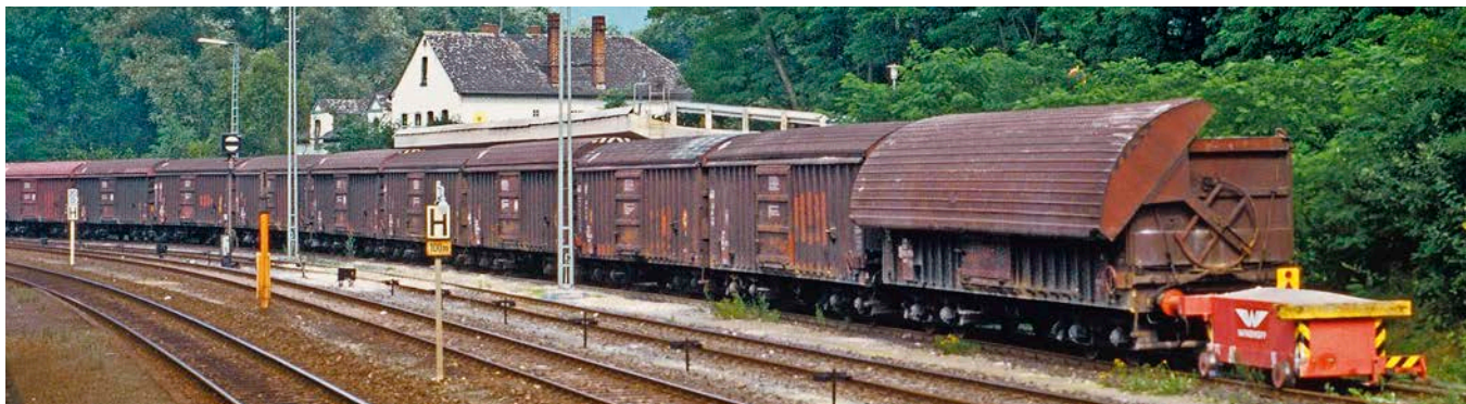
Tonerde-Zug aus Taems 890/891 hinter der Seilzug-Rangieranlage mit Pufferwagen von Windhoff an der Sturzrampe in Löhnberg im Lahntal 1987. Offensichtlich ist das Problem mit dem seitlichen Platzbedarf des geöffneten Schwenkdachs
