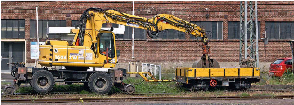
Dieser Atlas 1604 ZW überfährt ein Hindernis im Gleisbereich durch Anheben einer Achse
