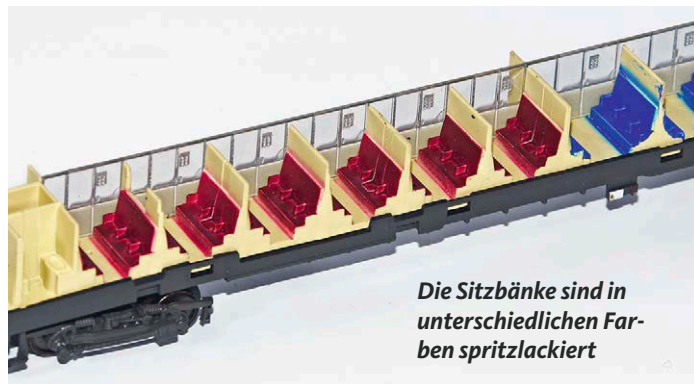
Die Seitengang-Trennwand hat aufgedruckte Fenster- und Türrahmen sowie Reservierungszettelhalter
