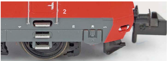
Fleischmann: Es sind alle drei Aufstiegtrittstufen vorhanden. Die Rangierertritte bestehen aus Kunststoff-Steckteilen
