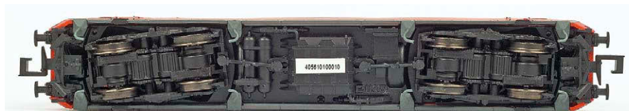
Piko: Die beiden Haftreifen sitzen auf den inneren Radsätzen
