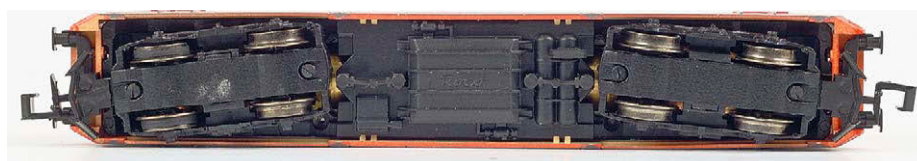
Roco: Es ist ein äußerer Radsatz mit zwei Haftreifen belegt
