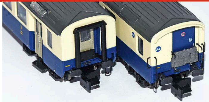
Hobbytrain: Autozug-Steuerwagen rechts ohne hintere Einstiegstüren, aber mit großer Stirnschiebetür und breitem Überfahrblech
