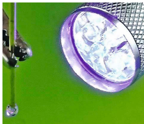
Anschließend wird die Kleberschicht mit einer UV-Licht-Lampe ausgehärtet
