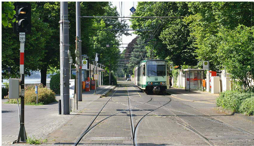
SSB Königswinter: Das Gleis wird über die rechte vordere Weiche einspurig weitergeführt. Die vordere linke Weiche führt zu einem Stumpfgleis
