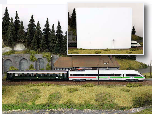
Das Modul wird mit LED-Haushaltslampen beleuchtet. Die Messung mit der vor den ICE gestellten Weißkarte (kleines Foto) ergibt 2800 Kelvin
