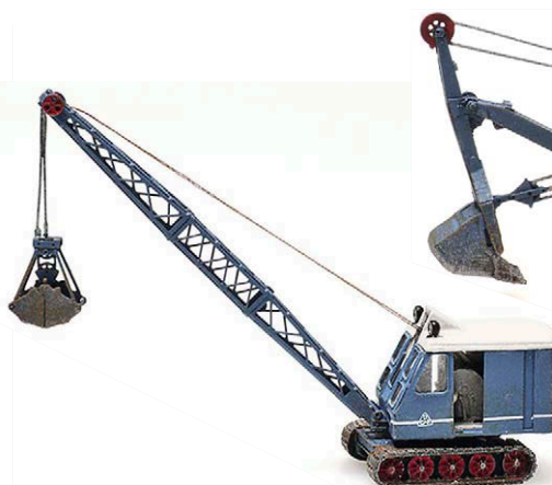
Schürfkübel-Bagger mit Gittermast auf einem Rad/Raupen-Fahrwerk
