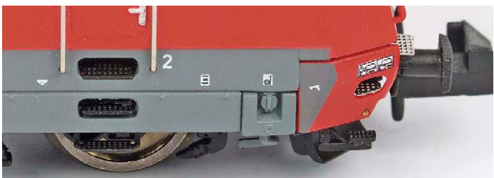
Piko: Die Aufstiege, der mittlere Rangiertritt und die Trittfläche über dem Puffer bestehen aus angesetzten Teilen mit Roststruktur
