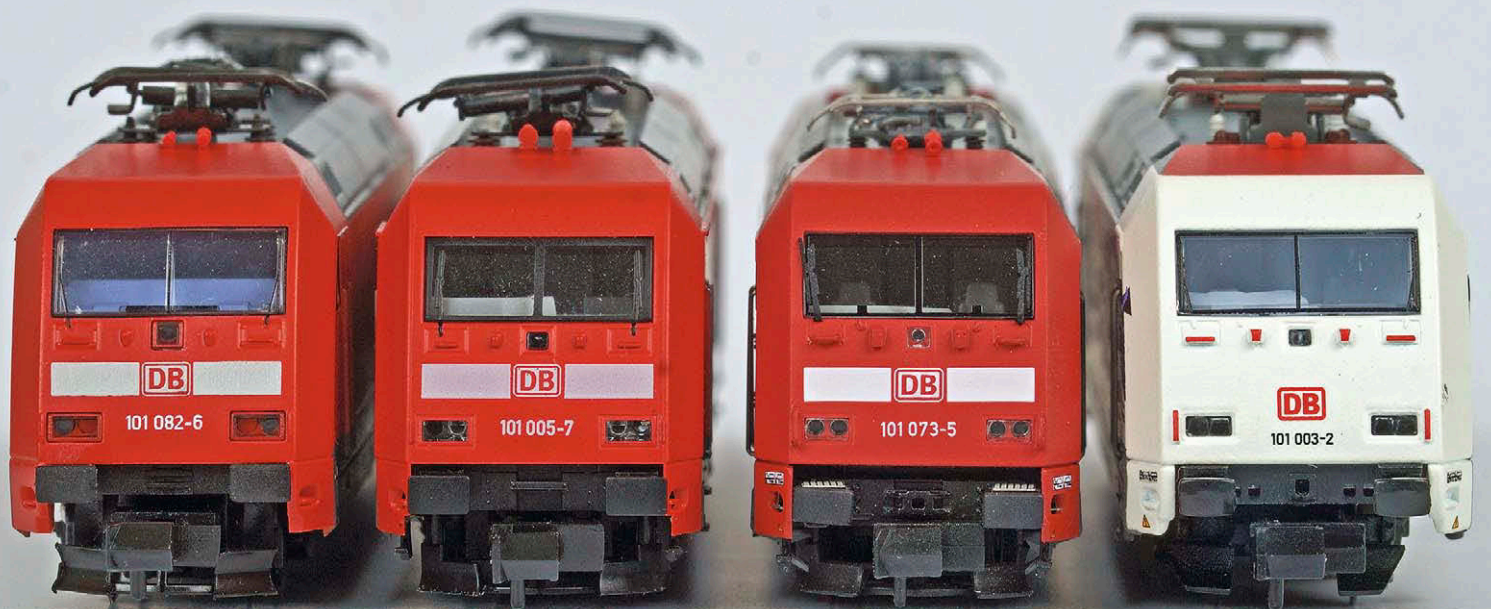
Die 101-Modelle von Roco, Fleischmann, Piko und Minitrix mit ihren unterschiedlichen Pufferhöhen und Fenstergestaltungen
