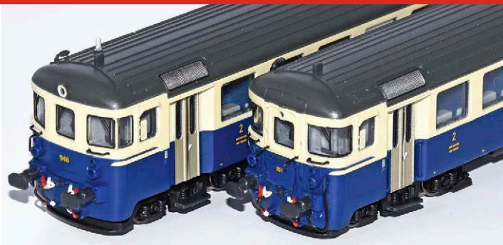
Hobbytrain: Der Bt rechts hat einen Stirnübergang und das obere Spitzenlicht in der Tür, links der BDt mit entferntem Übergang
