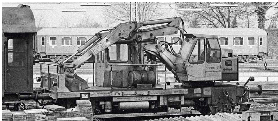
Aufwendige Selbstbauanregung: „Baggerkraftwagen“ 97 17 3500 112-7 mit Einachsantrieb des Gleisbauhofes Augsburg zusammen mit Bauzugwagen aufgenommen in Lindau 1981
