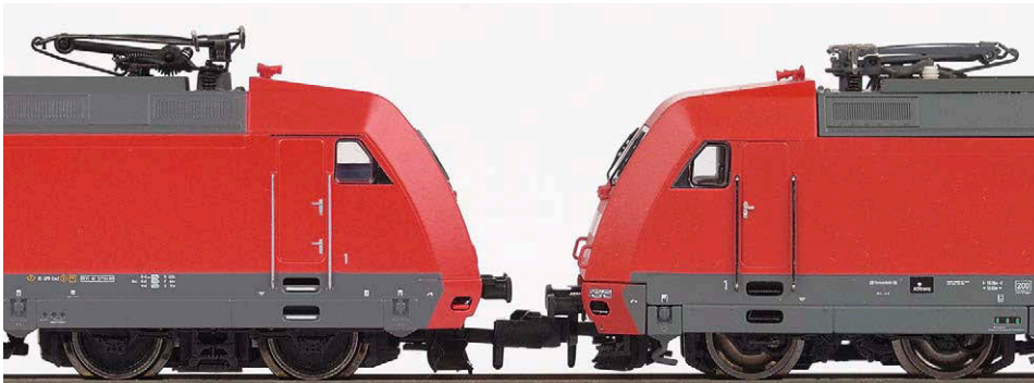
Besonders die Pufferebene der Roco-Lok (links) ist deutlich höher als bei Piko
