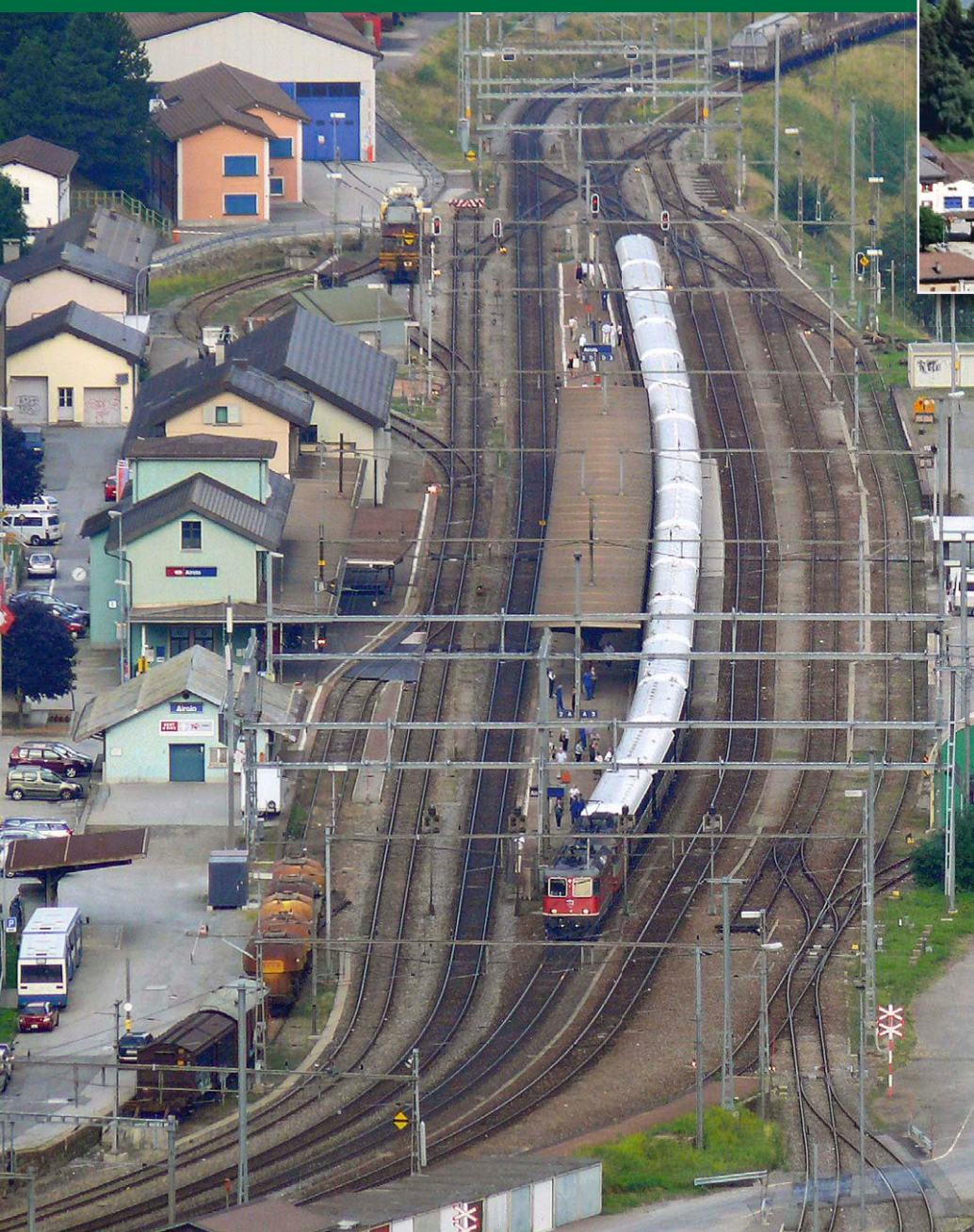
Gesamtbild von Airolo und dessen südlichem Kopf mit einer doppelten Gleisverbindung 2012. Das kleine Bild von 2018 zeigt den Zustand nach Entfernung einer Kreuzungsweiche (rechts)
