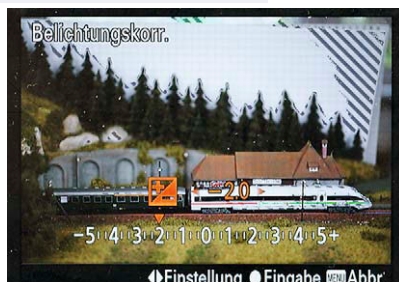
Anhand der Skala in 1/3-Schritten kann man die Belichtung über je fünf ganze Minus/Plus-Stufen korrigieren
