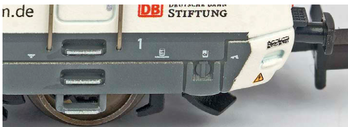
Minitrix: Es sind alle drei Aufstiegstritte vorhanden, allerdings ohne Rahmendurchbrüche. Der untere Rangiertritt fehlt
