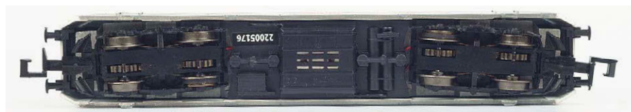
Minitrix: Die inneren Radsätze tragen jeweils einen Haftreifen
