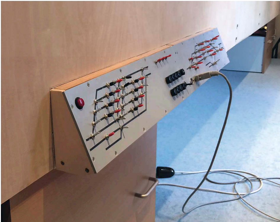
Die Anlagenfront mit den beiden eingehängten Schutzwänden. Links sind zwei der Haltehaaken zu sehen, die in Schlitz in der Platte greifen. Das Stellpult bleibt nach wie vor zugänglich
