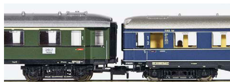
Während die Schürzenwagen von Minitrix und Roco gut zueinander passen, ist der 35er von Fleischmann gegenüber beiden zu hoch
