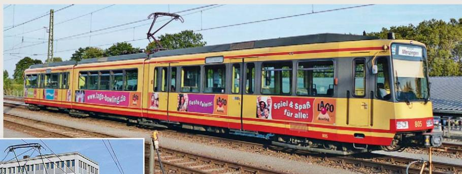
*1990/91 wurden die allerletzten GT8N aus DUEWAG-Produktion nach Freiburg geliefert. Diese verfügen schon ab Werk über ein Niederflur-Mittelteil*
