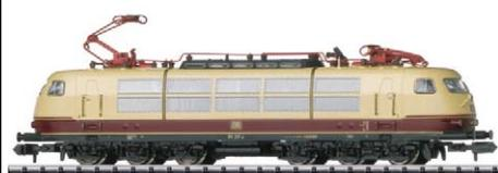
**Vorbild:** Elektrolokomotive 103 237-4 der Deutschen Bundesbahn (DB) im Zustand um 1985. Grundfarbgebung in Purpurrot/Elfenbein. Achsfolge Co'Co'. Baujahr ab 1970.
