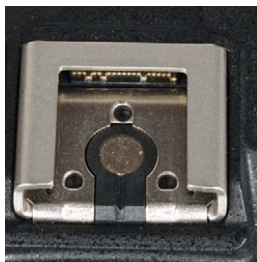
Ein aktueller Multifunktionsschuh mit verdeckten Zusatzkontakten
