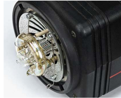
Offener Blitzkopf eines Studiogerätes (Leitzahl 58) mit ringförmiger Blitzröhre (200 W), dazwischen eine Halogenlampe (150 W) als Einstelllicht
