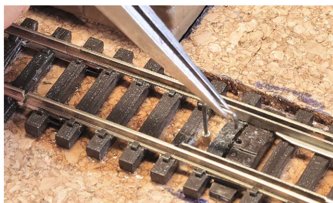
Beim Einsetzen des Stelldrahtes muss dieser leicht drehbar sein, um die Weiche ohne Klemmen stellen zu können. Notfalls kann die Bohrung in der Stellschwelle etwas aufgeweitet werden
