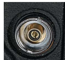
Buchse eines separaten Blitzanschlusses an einer Kamera
