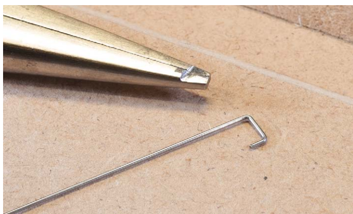
Der benötigte Stelldraht wird von Hand aus einem 0,5 mm starken Stahldraht in der jeweils passenden Form (Abstand Röhrchen zu Loch in der Stellbohle, siehe Skizze) zurechtgebogen
