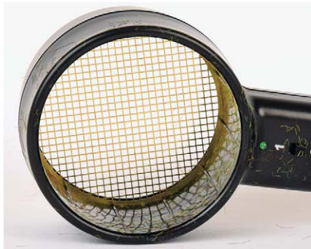
Faller (links) und Heki haben die Siebe fest verbaut und den Behälter nach oben offen gelassen, sodass ein unkomplizierter Graswechsel möglich ist. Allerdings bleibt immer ein kleiner Rest an den Rändern haften
