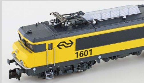
Das Modell besitzt eine authentische Dachgestaltung und etliche angesetzte Teile wie freistehende Griffstangen sowie Trittstufen an den Drehgestellen und ein Trittblech an der Front
