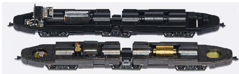
Fahrwerksgenerationen des GT 6 Z im Vergleich: oben die neue Hornby-Version mit neuem Motor, Digitalschnittstelle und geschwätzter Schwungmasse, unten das alte Arnold-Modell
