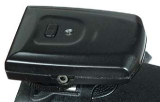
Funksender mit einfachem Mittenkontakt auf einem Multifunktionsschuh
