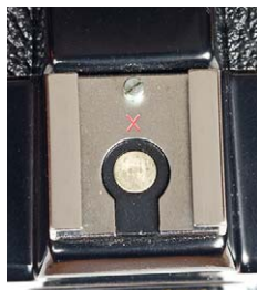
Älterer beschalteter Standardschuh mit Markierung für die X-Synchronisation
