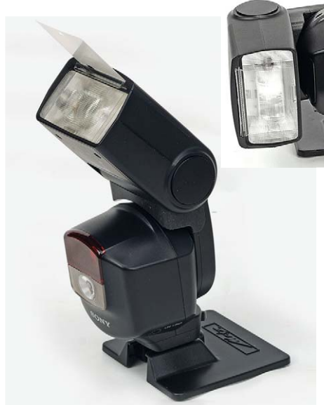
TTL-Zoomblitz (Leitzahlen 13-43) mit herausgezogener Reflexplatte, Position nach vorne und schräg oben gerichtet. Unten gibt es eine LED für Videos. Ein separater Direktblitz muss passend zur Formatlage der Kamera ausgerichtet sein, gegebenenfalls also auch vertikal (Bild oben)
