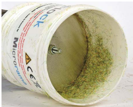
In den Wechselbehältern vom bFlock (links) und beim Greenkeeper bleibt relativ viel Material kleben, das allerdings leicht mit einem Pinsel herauszufegen ist
