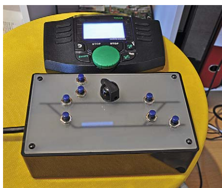
Beweglich über ein VGA-Kabel angeschlossen ist das selbst gebaute Gleisbild-Stellpult für den Bahnhof Schildburg
