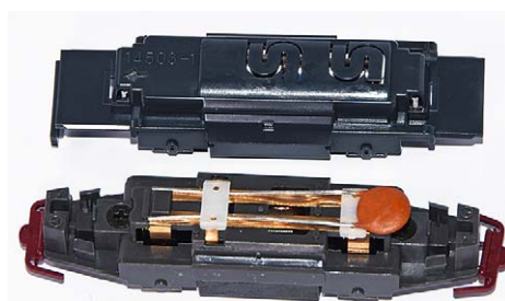
Oben neues Kato-Chassis in der Variante für ein japanisches Trammodell, unten das alte Fahrwerk des grünen Arbeitstriebwagens
