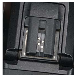
Inkompatibler Minolta-Schuh für TTL-Steuerung von AF-Kameras
