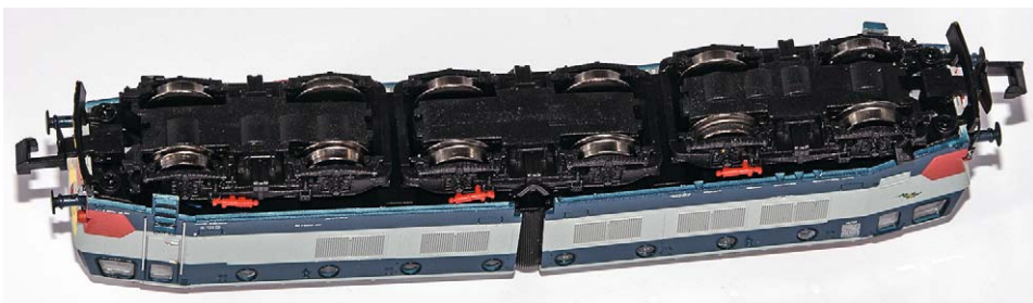
Die Antriebszahnräder sind nach unten abgedeckt. Die Stromabnahme erfolgt über Radinenschleifer an den Antriebsrädern. Alle Drehgestelle sind wie beim Vorbild frei beweglich
