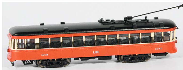
Typisch für amerikanische Straßenbahnen sind die langen Schutzgitter auf der türlosen Seite, hier als geätztes und geschwärztes Teil montiert
