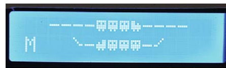
LCD-Anzeige an der Anlagenfront für den Schattenbahnhof: oben automatischer Betrieb mit freien Gleisen, unten manuelle Steuerung mit beiden belegten Gleisen
