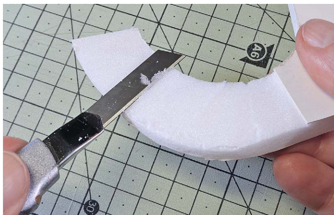
Die Auffahrt zur Laderampe lässt sich mit einem Cutter-Messer gut herausarbeiten
