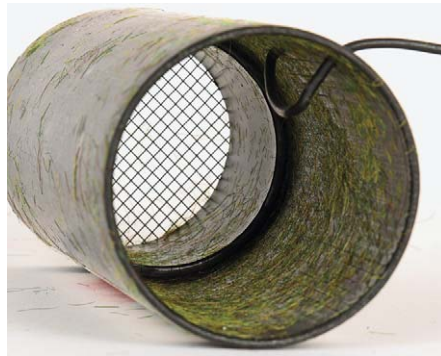
Faller (links) und Heki haben die Siebe fest verbaut und den Behälter nach oben offen gelassen, sodass ein unkomplizierter Graswechsel möglich ist. Allerdings bleibt immer ein kleiner Rest an den Rändern haften
