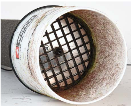
Beim Gras-Master (links) und Static King sind Bleche beziehungsweise Siebe am Behälterboden, sodass sich Grasrückstände schlechter herausbefördern lassen
