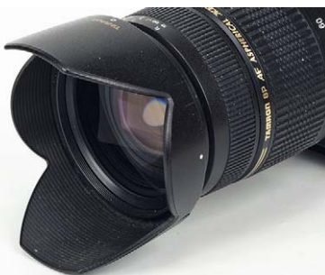
Blende mit Ausschnitten für die Weitwinkelstellung eines Zooms mit Bajonettbefestigung. Der Schutz für längere Brennweiten ist dadurch eingeschränkt
