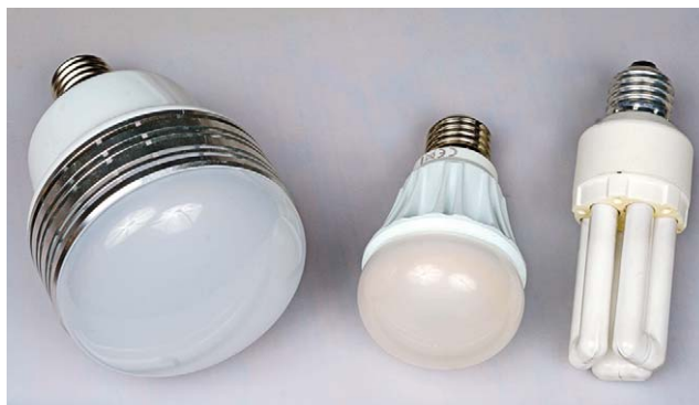
Nutzbare Leuchtmittel: spezielle LED-Fotoleuchte mit aktiver Kühlung (25 W, 5.500 K, 2.200 lm), LED-Haushaltslampe (13,5 W, 2.700 K) und Leuchtstoff-Energiesparlampe als Version mit Gewinde (14 W, 4.000 K, 740 lm)
