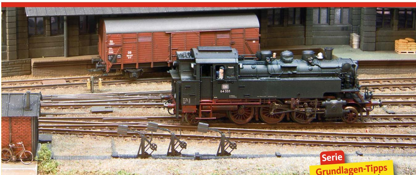
Bearbeitete Peco-Gleise mit der Anmutung eines Code-40-Selbstbaugleises
