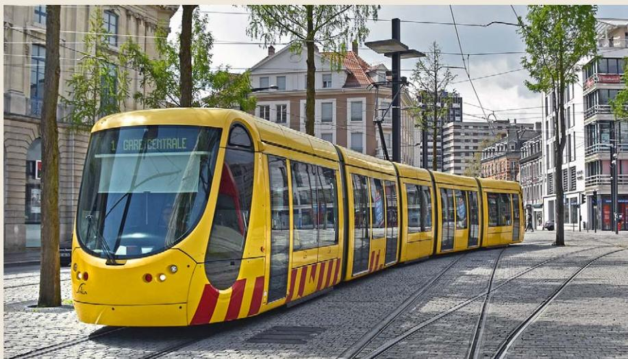
**Viele der in Europa eingesetzten Niederflur-Straßenbahnen sind fünfteilig, wie der Alstom Citadis 302 aus dem elsässischen Mulhouse (oben) und der Bombardier Flexity Outlook C aus Innsbruck (unten), der auch als Überlandbahn, z. B. nach Fulpmes eingesetzt wird**
