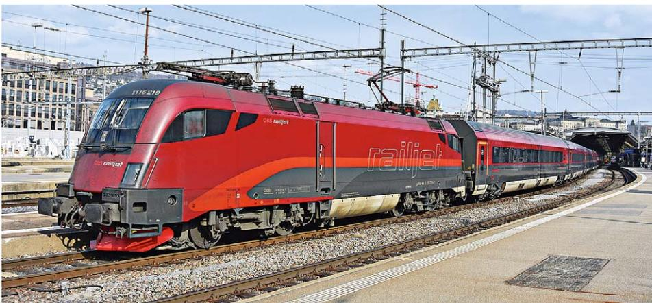
**Die Lokomotiven im Schweizverkehr tragen einen dritten Stromabnehmer mit schmalem Schleifstück sowie das Integra-Signum-System und haben einen verkleideten Trafo (1116 219-7 in Zürich HB 2017)**
