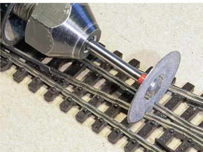
Mit einer 0,3 bis 0,5 Millimeter starken Diamanttrennscheibe werden die beiden Zungenschienen vom Herzstückbereich vorsichtig und möglichst gerade getrennt
