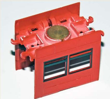
Die zurechtgeschnittenen Seitenwand- und Dachteile werden zusammen mit dem Messinggewicht als Einheit verklebt
