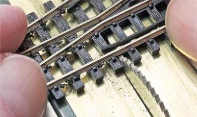
An einer kleinen Kreissäge werden im Zungen- sowie Herzstückbereich die Schwellenzwischenräume bis zur Schienenfuß-Unterkante abgefräst
