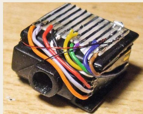
Die mit der Elektronik bestückte Motorhalterung: Die beiden dünnen Kupferlackdrähte führen nach links zum Powerpack. Der Decoder rechts ist mit den bunten Litzen angeschlossen. Oben sitzt die Streifenplatine als Basis für alle weiteren Anschlüsse mit zwei verbundenen Leiterbahnen für alle „blauen“ Plus-Leitungen
