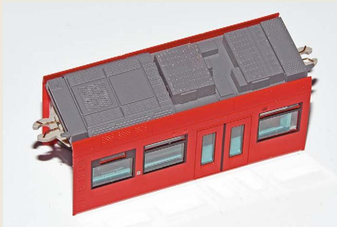
Statt eines weiteren unnötigen Dachstromabnehmers auf dem zweiten langen Mittelteil montiert man über dem Einstiegsbereich einen Dachwiderstand. Er wird aus dem übrig gebliebenen Endteil herausgeschnitten. Die Klimaanlage mit Ventilator könnte man bei Bedarf auch noch in Weiß oder silberfarben anmalen
