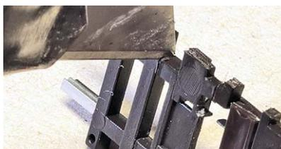
Um die überflüssigen Teile der Zungenfederung zu entfernen, wird mit einer Messerklinge eine Sollbruchstelle am Übergang zur nächsten Schwelle eingeschnitten
