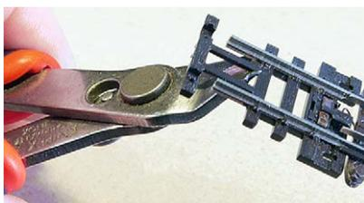
Zunächst werden die angespritzten Einzelschwellen mit einem Seitenschneider ohne Wate abgetrennt
