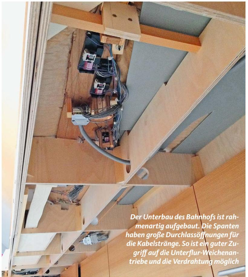
*Der Unterbau des Bahnhofs ist rahmenartig aufgebaut. Die Spanten haben große Durchlassöffnungen für die Kabelstränge. So ist ein guter Zugriff auf die Unterflur-Weichenantriebe und die Verdrahtung möglich*
