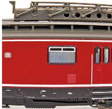
**Beispiel für eine tonnenförmige Verzeichnung bei Makroaufnahmen**
