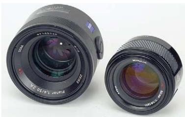
Zwei 50/1.4-Objektive mit unterschiedlichen AF-Antrieben, beide mit Nahgrenze von 0,45 m: Das linke hat einen eingebauten AF-Ultraschallmotor (SSM) und Innenfokussierung. Das rechte kleinere besitzt einen von der Kamera bewegten Stangenantrieb und fährt im Nahbereich nach vorne aus
