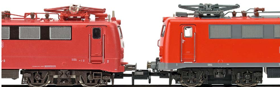
Die Fleischmann-141 (links) liegt korrekt deutlich tiefer mit ihrem Lokkasten
