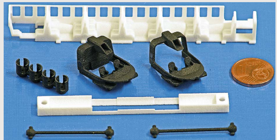
Die im groben, aber robusten SLS-Verfahren gedruckten Bauteile
