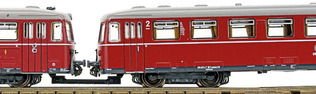
Die Kupplung liegt zwar sehr tief, sollte jedoch bei NEM-orientiertem Anlagenbau nicht aufstoßen können, wie diese abrupte Übergangssimulation in eine Steigung testweise zeigt
