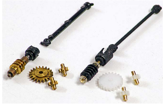
Links alte und rechts die neuen Getriebekomponenten
