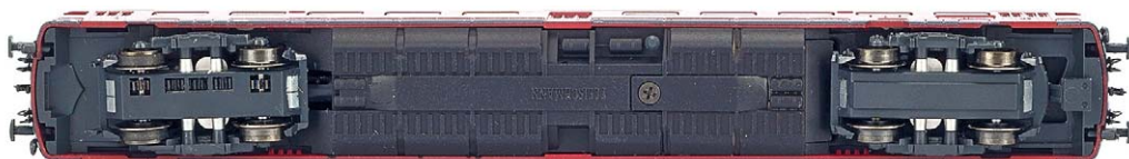
Beim ETA ist ein Drehgestell (links) angetrieben, das Decoderfach liegt auf der anderen Seite
