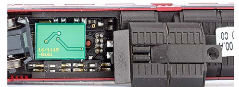
Die geöffneten Decoderfächer mit Minischaltern des ETA (oben) und des ESA
