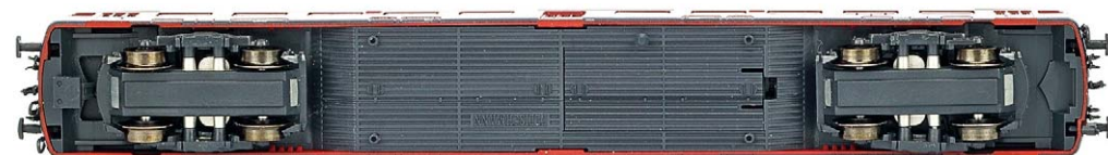
Der Steuerwagen hat eine Bodenwanne zur Aufnahme des Decoders (rechts)
