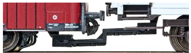
Gerade Kuppelstange zwischen ETA und ESA links und gestufte Form rechts zur normalen Kupplungshöhe (Minitrix UIC-X-Wagen)
