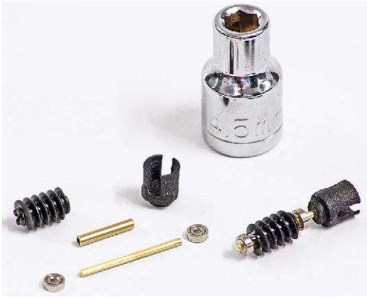
Die Einzelteile der neuen Schneckenwelle (links). Die Schnecke sitzt auf einer Hülse, welche gleichzeitig die Kugellager auf Abstand hält. Im Hintergrund sieht man die 4,5 mm-Nuss, die als Presshilfe für die Schnecke dient
