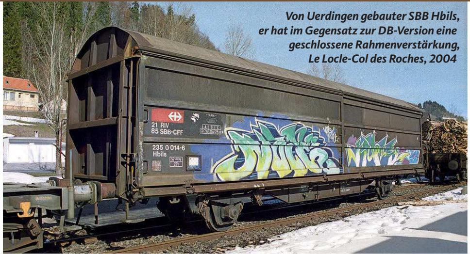
*Von Uerdingen gebauter SBB Hbils, er hat im Gegensatz zur DB-Version eine geschlossene Rahmenverstärkung, Le Locle-Col des Roches, 2004*
