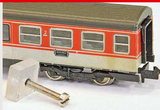
Ersatzbefestigung von Dächern mit Schrauben, hier bei einem DB 614 von Fleischmann
