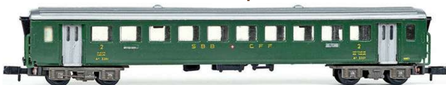
Die Arnold-Wagen von 1967 hatten damals zeitgemäß die Ursprungsversion mit Faltenbälgen als Vorbild, hier der 2. Klasse-Wagen mit unpassenden und vereinfachten SIG-Drehgestellen. Die Türen mit Tritt sind silberfarbene Einsteckteile, die Bodenkästen angeschraubt
