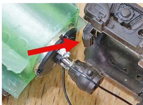
Der Motor kann sich im eingebauten Zustand mit der Halteklammer der Drehgestellblende verhaken. Mit der leicht angeschliffenen Motorstirnseite aus Kunststoff und angeschrägtem Haken der Drehgestellblende gibt es dann genug Bewegungsspiel
