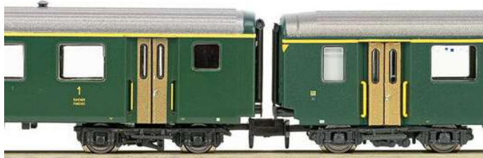
Der Wagenkasten sitzt beim EW II von Brawa (links) etwas zu hoch, sodass die vorbildlich tiefer Fensterlinie nicht zur Geltung kommt
