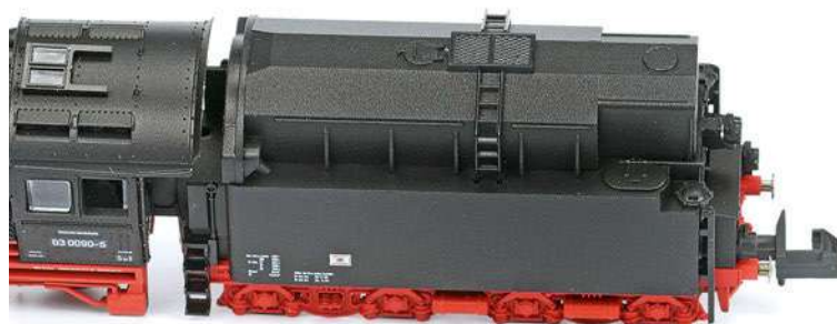
Minitrix: Die Leitern und Plattform auf dem Tender sind angesetzte Kunststoffteile
