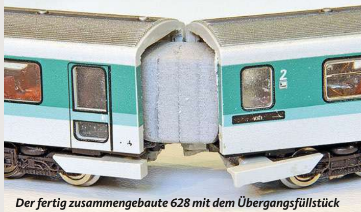
Das an einer 628-Hälfte angeschraubte Füllstück
