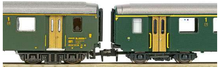
Die Fenster beim EW I von Lima (links) sind etwas kleiner. Der Wagenkasten sitzt auf den zu wuchtigen Drehgestellen zu hoch auf
