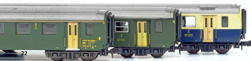
Die alte Lima/Arnold-Serie umfasst auch verschiedene Stirnseiten und Dächer: links SBB A mit Gummiwülsten, mittig SBB B mit Übersetzfenstern und Ansatzkante am Dachende sowie rechts BLS B mit Düsengittern, Regenabweiser und typischem schrägen Kastenende
