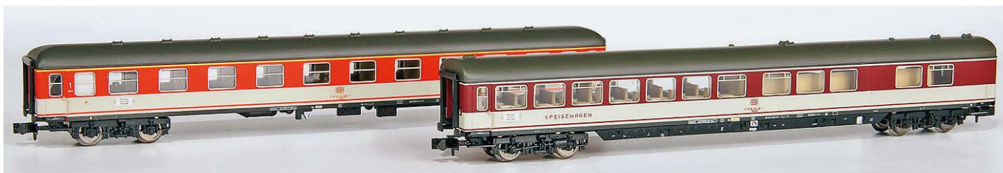
Ebenfalls aus dem Satz von 2008 stammen die beiden Einzelgänger Aüm 202 mit großen Türen und der WRümh 132 – korrekt mit zwei Gangfenstern gegenüber dem Küchenbereich. Er ist allerdings zu kurz geraten
