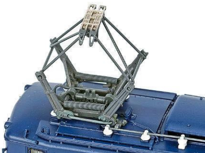
Piko: der Gleichstrom-Pantograf mit Doppelschleifstück auf der niederländischen NS 1100
