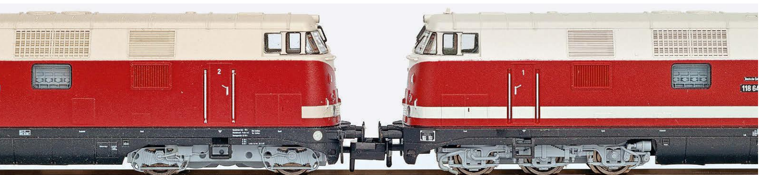
Fleischmann: Vergleich der beiden Drehgestelltypen mit jeweils korrekten Lagen am Rahmen
