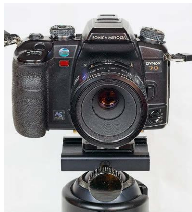
Beim Wechsel von Quer- auf Hochformat mittels Kopfverstellung wird die Kameraposition/optische Achse in der Höhe und zur Seite verlagert
