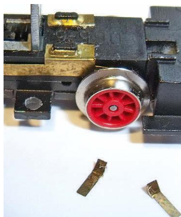
Die beiden hochstehenden Stromkontaktbleche für den alten Motor werden am Chassis abgetrennt (siehe Bild Mitte). Dort wird je ein Kabel für die Stromversorgung des Decoders angelötet (siehe Bilder auf der nächsten Seite)
