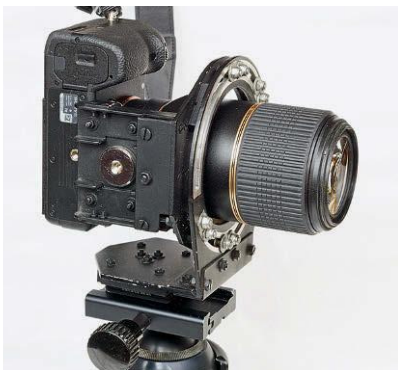
Die universelle Lösung für einen achsenneutralen Formatlagewechsel wäre eine Rotationshalterung für die Kamera, hier eine Eigenkonstruktion
