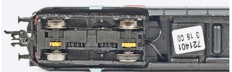
Fleischmann: links das Chassis der 228 aus der ersten Produktionsserie mit Schleifkontakten zwischen Drehgestellen und Lokboden zur Stromübertragung, rechts die neue 118-Version mit Kabelverbindungen. Abgeändert ist auch das Drehgestell
