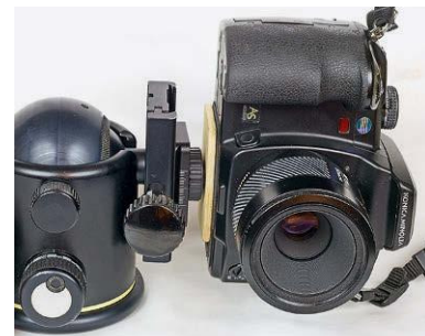
Beim Wechsel von Quer- auf Hochformat mittels Kopfverstellung wird die Kameraposition/optische Achse in der Höhe und zur Seite verlagert
