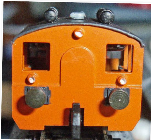
Die zusammengebaute Köf als SOB Tm 34. Markant ist die freistehende Nachbildung des Handrades im Führerhaus. Der Motor ist nur bis zum Handrad geschwärzt, wo er von außen zu sehen ist. In der Stirnansicht fällt der neue Motor überhaupt nicht auf
