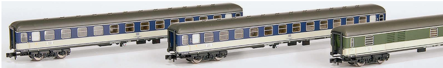
Minitrix brachte 2008 nochmals eine Serie mit Popwagen. Diese haben den Zuglauf Hamburg-Altona – Basel SBB. Hier zu sehen sind zwei Büm 232 mit breiten Türen und schmalen Abteifenstern sowie der Düms 902
