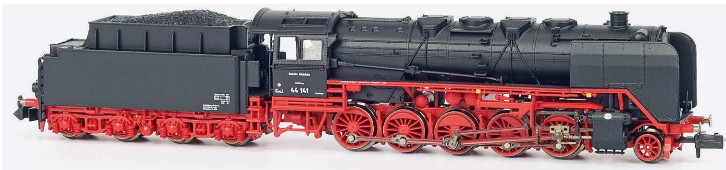
Fleischmann: die DRB 44 141 im Ursprungszustand von 1938 (oben) und die DB 044 119-6 als Beschriftungsvariante aus dem Ruhrgebiet mit Pumpen an den Umläufen, Indusi und Kohlenkasten-Erhöhungsaufsatz
