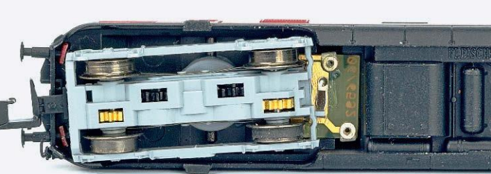
Fleischmann: links das Chassis der 228 aus der ersten Produktionsserie mit Schleifkontakten zwischen Drehgestellen und Lokboden zur Stromübertragung, rechts die neue 118-Version mit Kabelverbindungen. Abgeändert ist auch das Drehgestell
