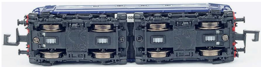
Piko: das Fahrwerk der NS 1100 im Lieferzustand ohne Haftreifen
