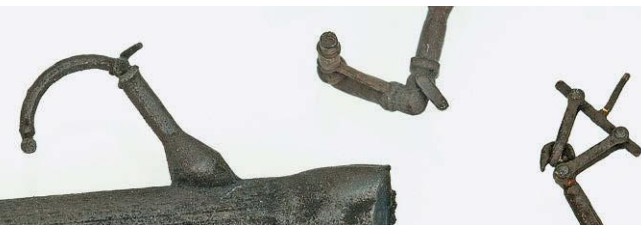
Eichhorn Modellbau: Bemsschläuche, Dampfheizkuppelungen und Schraubenkuppelungen
