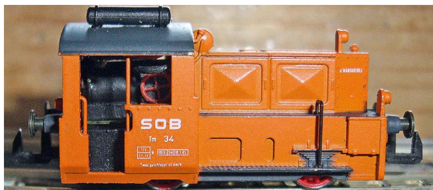
Die zusammengebaute Köf als SOB Tm 34. Markant ist die freistehende Nachbildung des Handrades im Führerhaus. Der Motor ist nur bis zum Handrad geschwärzt, wo er von außen zu sehen ist. In der Stirnansicht fällt der neue Motor überhaupt nicht auf
