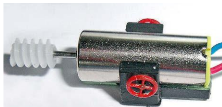
Der in die lackierte Halterung mit Schalt-rad geklebte neue Motor inklusive Schnecke
