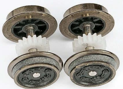
Piko: die Austauschradsätze mit Haftreifen. Man erkennt auch die Andeutung des Vorbildantriebes auf den Radscheiben
