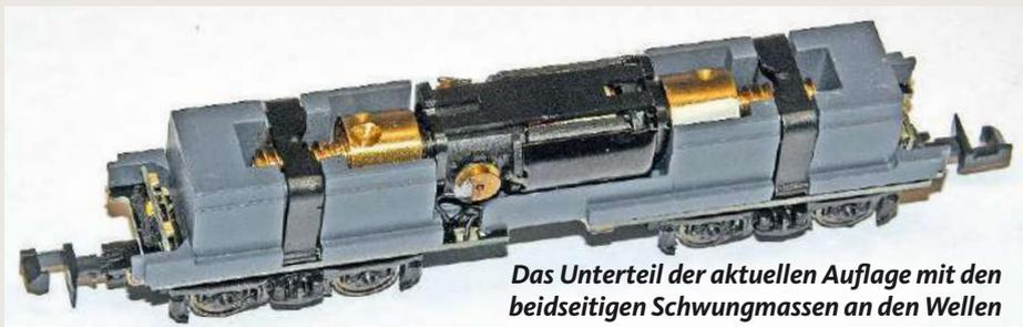
**Das Unterteil der aktuellen Auflage mit den beidseitigen Schwungmassen an den Wellen**
