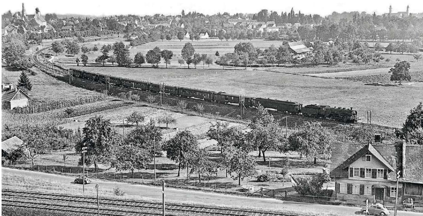
Der D 161 bei Lindau-Aeschach 1953 in Modellbahn-anregender Umgebung. Nach der 18 480 folgt ein langer PZa mit symmetrischem Oberlicht. Zwischen den Altbau-Einheitswagen der DB sind zumindest an fünfter und sechster Stelle zwei SNCF-Wagen Typ Est zu identifizieren
