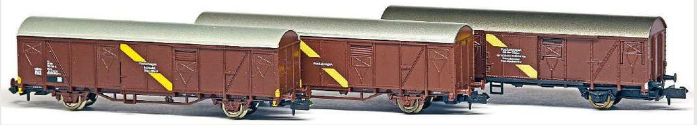
**A**uch in Österreich gab es Bahnpostwagen in Güterwagenbauart. Die typischsten und am weitesten eingesetzten Vertreter wurden als Gbs(s)-vx bezeichnet. Es handelte sich um schnelfahrttaugliche und für den Einsatz in Reisezügen mit elektrischer Heizleitung umgebaute Standardgüterwagen der Bauart Gbs (erstes Baujahr 1964) mit einer LüP von 14.020 mm und 8.000 mm Achsstand. Die Gbs(s)-vx behielten ihre Ur-
