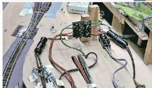
Kabelanschlüsse zwischen dem linken und mittleren Segment mit Lüsterklemmensteckern und großen Rundsteckverbindungen: Zu sehen sind auch die Lampensockel in der Grundplatte für die Schattenbahnhofbeleuchtung
