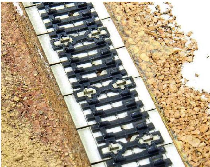
Die Metallschienenstühle sind in das Rost eingeklebt
