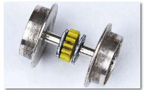
Wieder montierter Radsatz mit beidseitigen Führungsscheiben am Zahnrad
