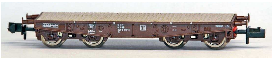
Fleischmann: ÖBB Schwerlast-Flachwagen S der Epoche IV, unten im Bild ist am rechten Wagen die neue rote Kupplungshalterung zu sehen. Der Wagen kuppelt nun in einem weiteren Abstand als früher
