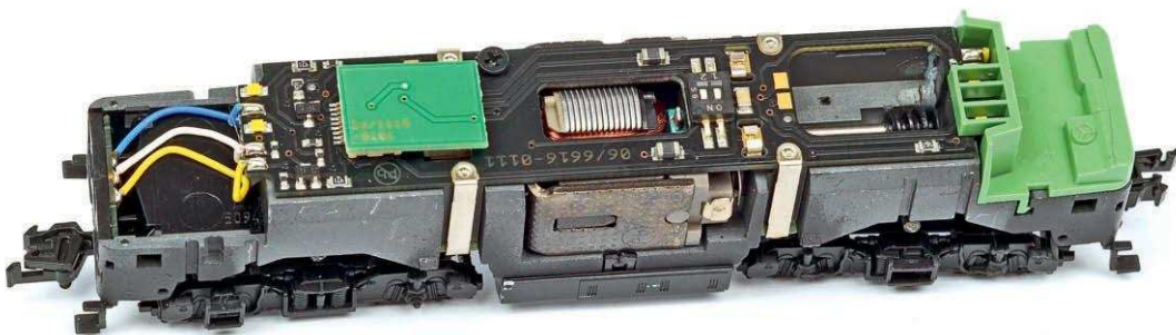
Fleischmann: Die Next18-Schnittstelle der 210 ist auf der Platinenoberseite platziert
