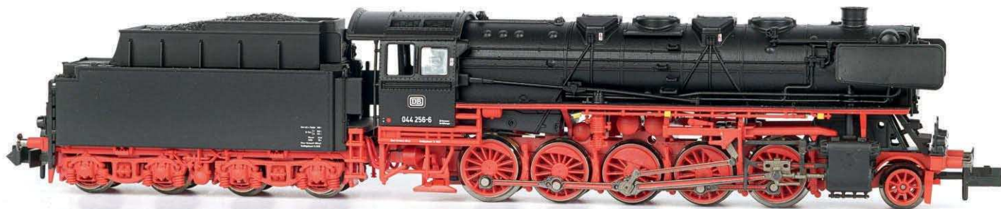
Oben Lokführerseite der DB 044 mit tief sitzender Luftpumpe, unten Heizerseite mit ebenfalls tiefer Lage der Speisewasserpumpe
