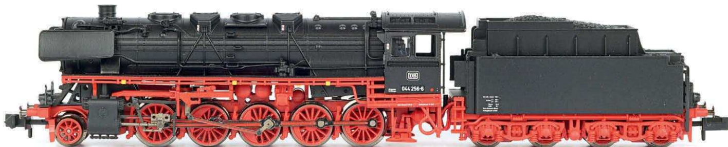
Oben Lokführerseite der DB 044 mit tief sitzender Luftpumpe, unten Heizerseite mit ebenfalls tiefer Lage der Speisewasserpumpe
