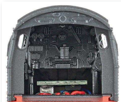
Die sehr detaillierte Stehkesselrückwand und der Freiraum für den Decoder darunter
