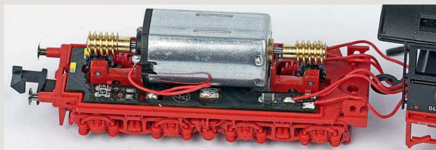
Nach Abnahme des Gehäuses liegt der Motor lose in den Halterungen
