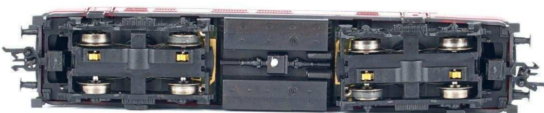
Fleischmann: Bei der 210 haben die inneren Radsätze je einen Haftreifen
