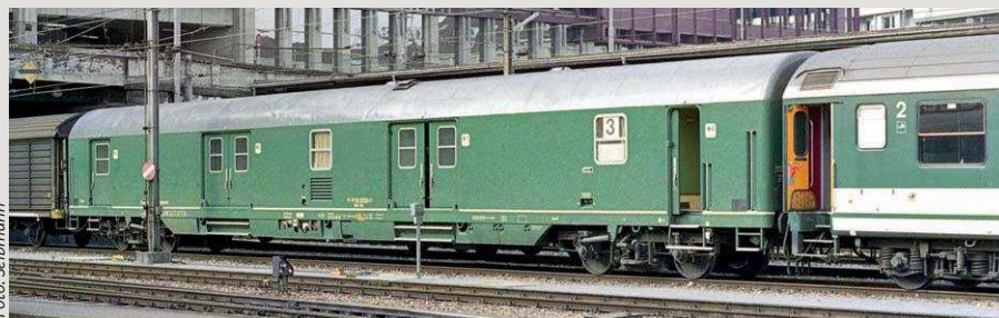
Ein Post mrz für 200 km/h mit Schlingerdämpfern in der letzten Lackierung mit grüner Schürze und Zierstreifen in Basel SBB im Jahre 1992
