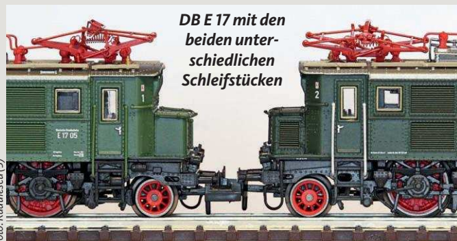
Links die E 17 in Flaschengrün mit Einzelschleifstück, rechts die neue Variante in Chromoxidgrün mit Doppelschleifstück
