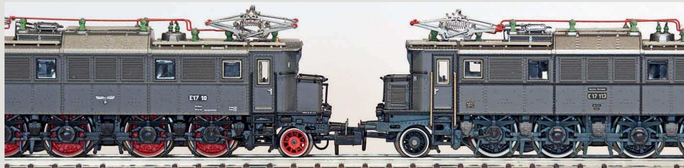
DB E 17 mit den beiden unterschiedlichen Schleifstücken
