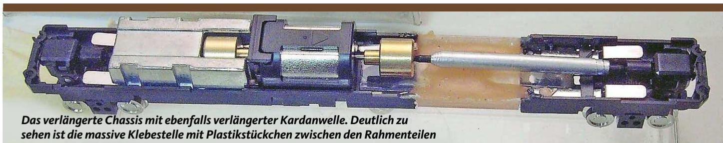
Das verlängerte Chassis mit ebenfalls verlängerter Kardanwelle. Deutlich zu sehen ist die massive Klebestelle mit Plastikstückchen zwischen den Rahmenteilen
