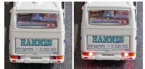
Die rechteckigen Löcher werden schrittweise mit Micro Kristal Klar aufgefüllt. Ganz links erkennt man das gelbe Abdeckband auf der Gehäuserückseite unter dem Loch
