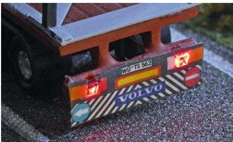
*In diesem Fall sind die rückwärtigen Details auf einem einzigen Dekorbogen gedruckt. Die Öffnungen für die Rücklichter sind herausgeschnitten. Das Ganze wird am LKW mit Cyanoacrylat-Kleber befestigt*
