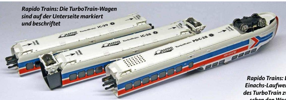
**Rapido Trains: Die Einachs-Laufwerke des TurboTrain zwischen den Wagen**
