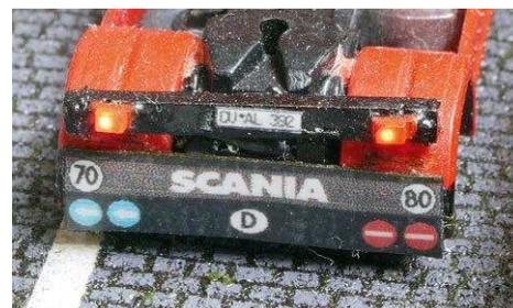
*Der Scania-LKW (Roco) hat einen externen Beleuchtungseinsatz, der mit 2K-Kleber befestigt ist. Das Ganze ist mit Polycarbonat-Farbe schwarz angemalt. Ferner ist das Modell nachlackiert und hat gedruckte Schilder*
