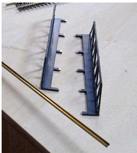
*Die Hack-Brücke wird zunächst der Länge nach durchgetrennt*
