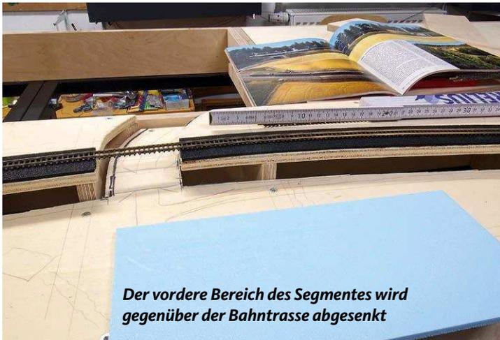
Der vordere Bereich des Segmentes wird gegenüber der Bahntrasse abgesenkt
