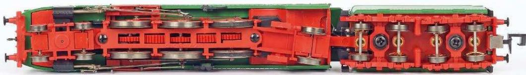
**Arnold: Fahrwerk der DR 02 mit drei über Zahnräder angetriebenen Triebrädern mit zwei Haftreifen. Die Tenderräder werden für die Stromabnahme herangezogen mit Spiralfedern auf den Achsen**
