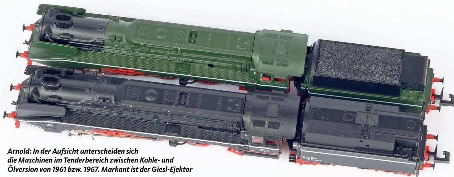
**Arnold: In der Aufsicht unterscheiden sich die Maschinen im Tenderbereich zwischen Kohle- und Ölversion von 1961 bzw. 1967. Markant ist der Giesl-Ejektor**
