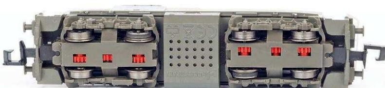
*Fahrwerk mit vier angetriebenen Achsen und zwei Haftreifen auf den inneren Radsätzen*
