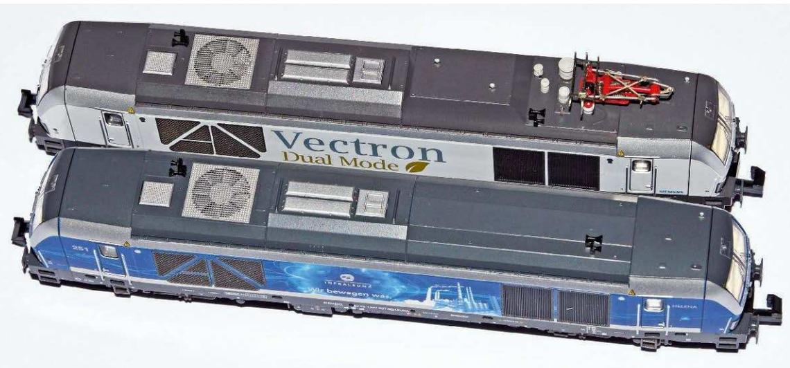
**Hobbytrain: Im Dachansichtsvergleich wird die Herkunft des Vectron Dual Mode vom dieselelektrischen Vectron DE (unten) offensichtlich, der auf der rechten Seite im Bild eine geänderte Gestaltung wegen seiner elektrischen Ausrüstung mit Transformator und Stromabnehmer aufweist**
