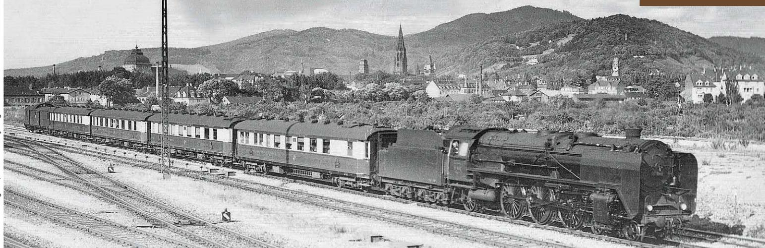
**Die Offenburger 01 069 verlässt Freiburg mit dem FFD 102 in Richtung Basel im Jahre 1934. Er besteht aus den SB4ük-28, SA4ü-28, SA4ük-28, SB4ü-28 und violetterm Pw4ü-Pr16. Der Schutzwagen hinter der Lok ist jetzt bei den Stahlwagen nicht mehr vorgeschrieben**
