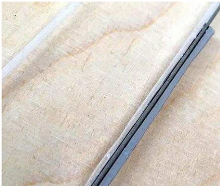
*Die Alublechstreifen werden mittels eines in die Rille passenden stabilen Stahldrahtes auf ganzer Länge gleichmäßig eingedrückt. Dann wird die Außenkante mit einem Messer entlang des Drahtes abgeschnitten. Auf der anderen Seite wird der Blechstreifen-Überstand auf die Acrylplatte umgefaltet und plan gedrückt*
