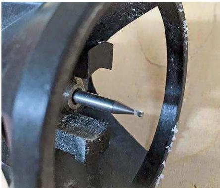
*Eine Modellbau-Oberfräse wird mit einem Kugelfräser-Kopf bestückt, der nur teilweise übersteht*
