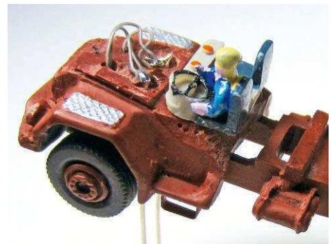
**Hier gibt es beim Magirus Deutz von Littke N-Modelle absolut keinen Platz für eine Beleuchtungseinheit. Die winzigen LEDs sind einfach an feinste Drähte angelötet, an den Rahmen geklebt und mit einer großzügigen Schicht schwarzer Polycarbonat-Farbe abgedeckt**
