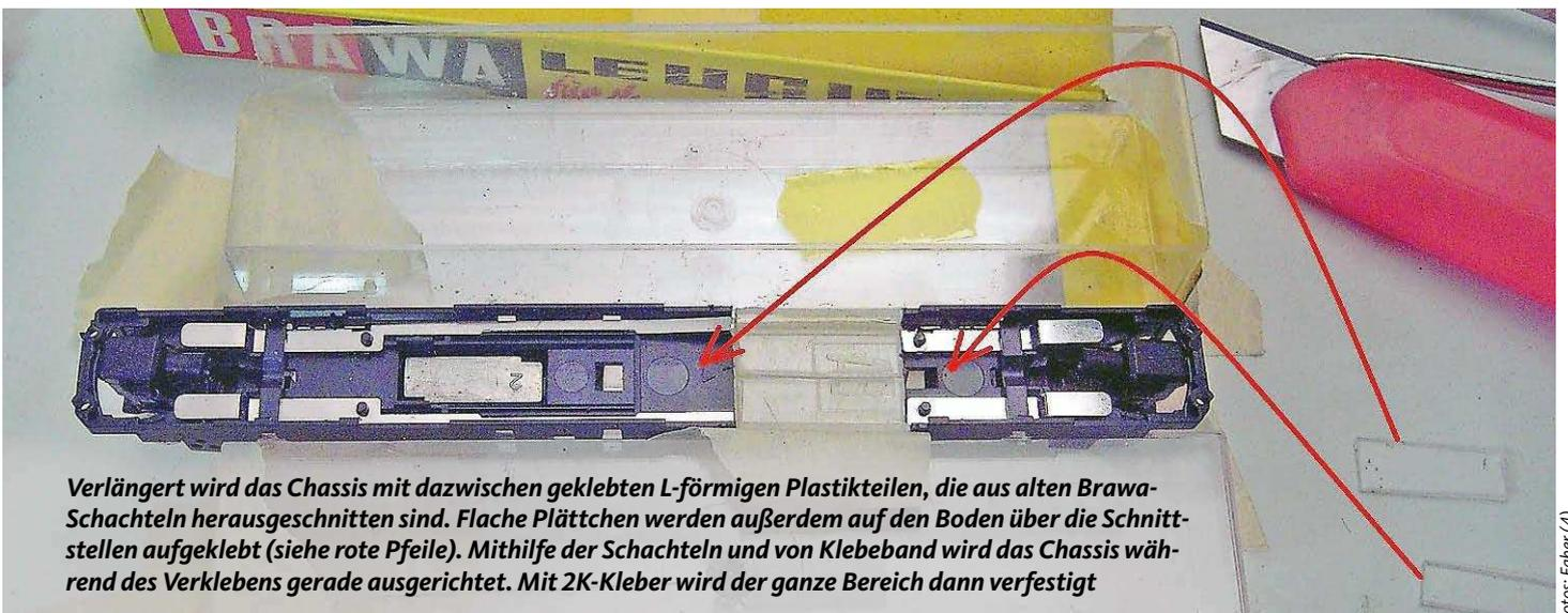
Verlängert wird das Chassis mit dazwischen geklebten L-förmigen Plastikteilen, die aus alten Brawa-Schachteln herausgeschnitten sind. Flache Plättchen werden außerdem auf den Boden über die Schnittstellen aufgeklebt (siehe rote Pfeile). Mithilfe der Schachteln und von Klebeband wird das Chassis während des Verklebens gerade ausgerichtet. Mit 2K-Kleber wird der ganze Bereich dann verfestigt
