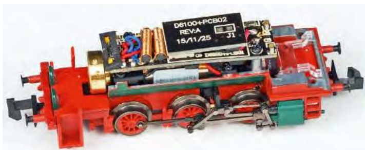
Liliput: Chassis mit Next18-Schnittstelle über dem Motor
