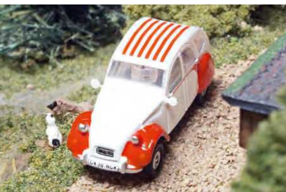
Der Citroën 2CV Dolly vom britischen Hersteller Oxford Diecast ist mit schmalen Spiegeln von FKS Modellbau ausgerüstet. Feine Löcher wurden gebohrt, die Spiegel eingeklebt und lackiert
