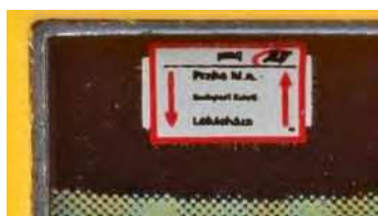
Minitrix: Vergrößerte Ansicht des dreifarbigen auf die Fensterscheiben gedruckten Zuglaufschildes
