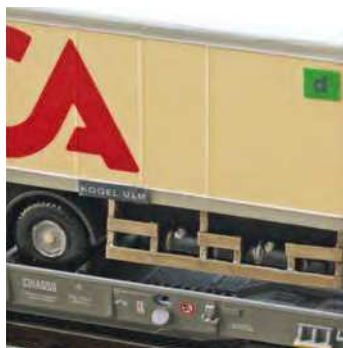
Ein alter Mercedes 2236: Der seitliche Unterfahrschutz und Spiegel sind ergänzt und andere Details am gesamten Lkw angeklebt
