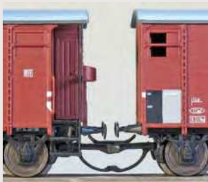
Die möglichen Wagenabstände mit N-tram-Kupplungen links und daneben mit einem Paar von Fleischmann-Profi-Köpfen
