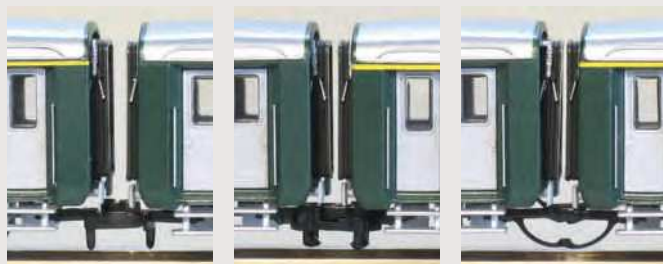
Kuppelabstände mit Standard-Klauenkopf, Fleischmann-KK-Kopf und mit N-tram KK-Kupplung
