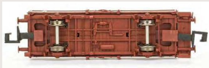
Wagenboden eines DR-Wagens mit Bühne, die auf einfachen Verlängerungen sitzt, deswegen ist eine Kupplungsaufnahme länger
