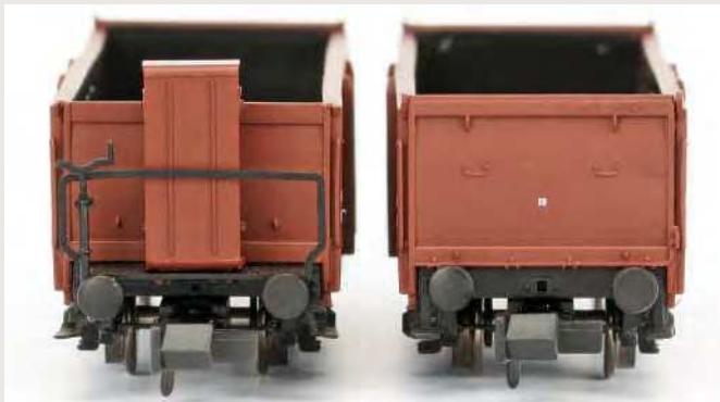
Stirnseiten mit und ohne Bremserhaus der DB-Version
