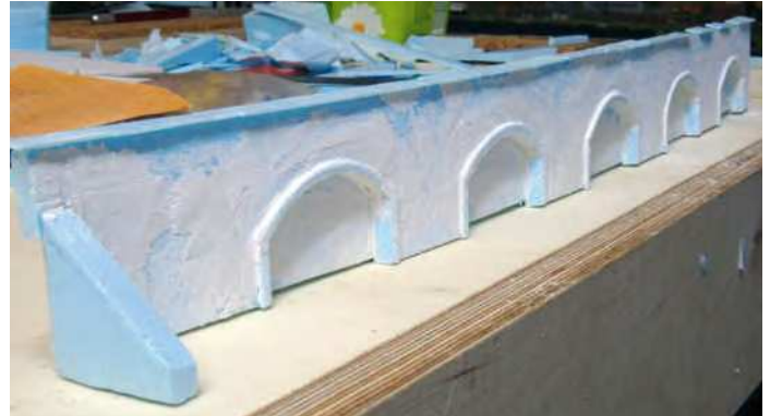
Es wird eine poröse Putzschicht aufgetragen
