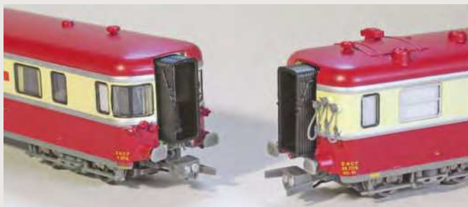
Die Wagen werden über magnetische zweipolig leitende Spezial- köpfe (siehe Bild unten) miteinander kurzgekuppelt
