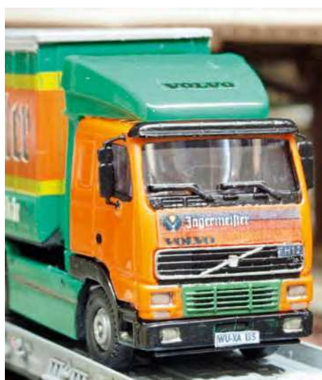
Eine Roco-Zugmaschine aus den 1990er-Jahren. Einige Teile sind angemalt. Hinzugefügt sind bedruckte Täfelchen (Nummernschild, FH12-Schriftzug, Jägermeister- und Volvo-Logos), Decals (das hohe schwarze Frontlogo auf dem Dachspoiler) und Blechspiegel
