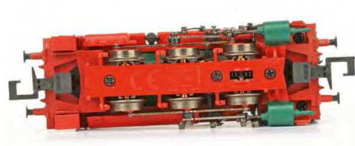
Liliput: Fahrwerk mit einer direkt angetriebenen Achse
