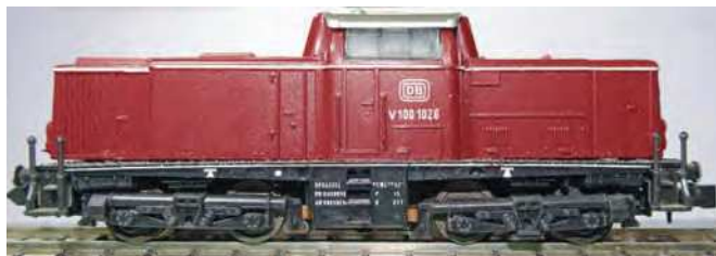
Längsansicht der einstigen V 100 von Lima, unten das kuriose 1'B1'-Fahrwerk mit Stirnradgetriebe und querstehendem Motor
