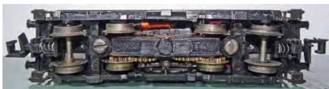
Längsansicht der einstigen V 100 von Lima, unten das kuriose 1'B1'-Fahrwerk mit Stirnradgetriebe und querstehendem Motor
