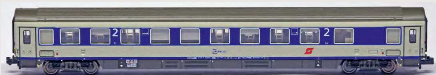
Abteilseite des Liegewagens Bcmz 73 in K3-Lackierung mit sichtbaren Bettleitern und Rollos
