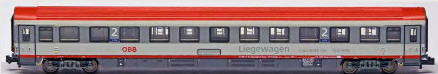
Gangseite des Liegewagens Bcmz 73 in Upgrade-Lackierung mit entfernten Zugziel-Anzeigekästen
