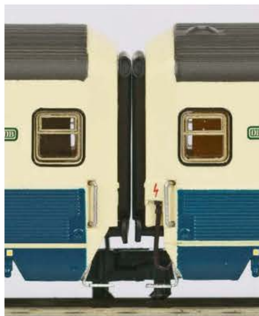
ASM: Vergleich des Kuppelabstandes mit Fleischman-KK-Köpfen (links) und mit der Standard-Klauenkupplung (rechts)
