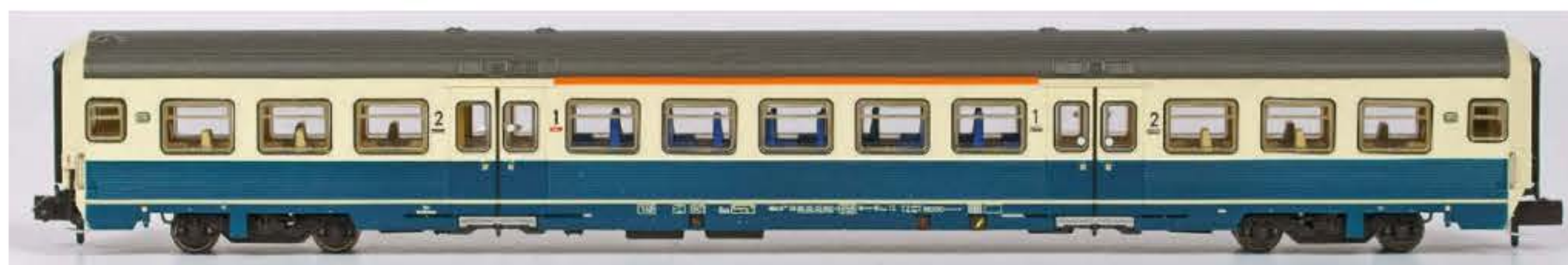
ASM: 1./2. Klasse-Wagen ABnrzb 706 mit Großraum in der ersten 1. Klasse und fensterunabhängiger Sitzteilung auf Basis des 2. Klasse-Wagenkastens
