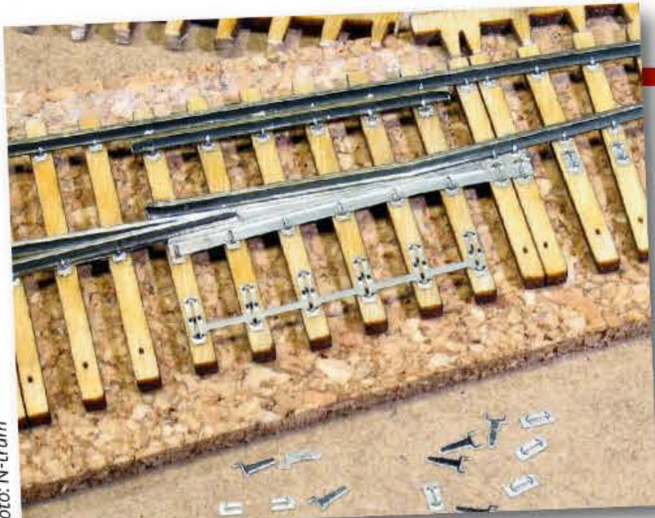
N-tram: Eine EW-190-1:9 auf Korkbettung im Bau mit teilweise abgetrennten Bohlen-Montageverbindungen, teilmontiertem Herzstück und noch einer fehlenden Backenschiene. Im Vordergrund liegen Gleisklammern und Schienenplatten
