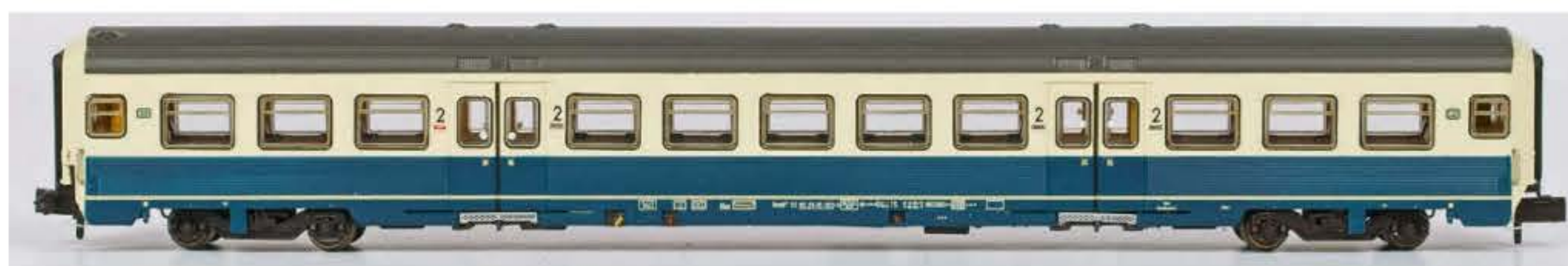
ASM: 2. Klasse-Wagen Bnrzb 276 in üblicher vis-a-vis-Sitzaufteilung wie bei den „Silberlingen“
