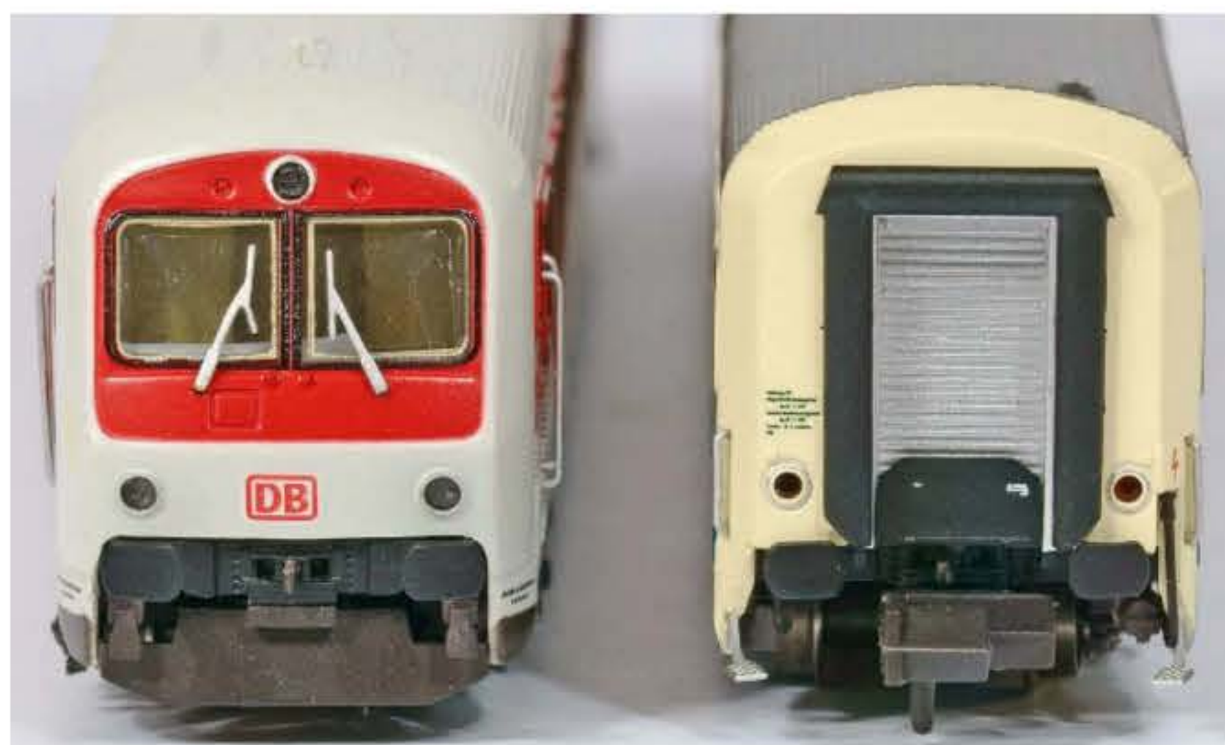
ASM: Steuerwagenfront mit Füllstück und Stirnübergang mit Rollo der LHB-Wagen. Die Griffstangen sind aus Draht angesteckt
