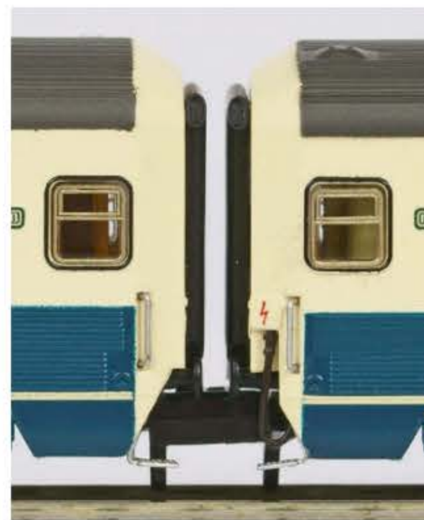
ASM: Vergleich des Kuppelabstandes mit Fleischman-KK-Köpfen (links) und mit der Standard-Klauenkupplung (rechts)
