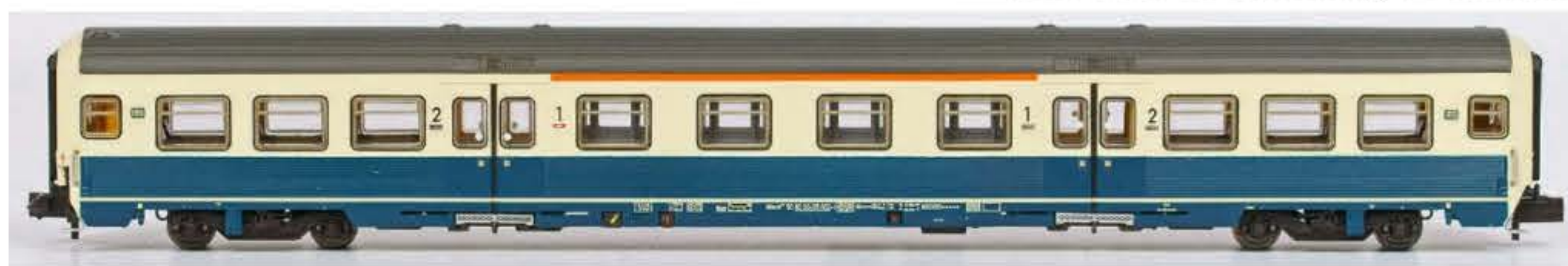
ASM: 1./2. Klasse-Wagen ABnrzb 705 mit Seitengang-Abteilen in der 1. Klasse und gewöhnlicher vis-a-vis-Sitzteilung der 2. Klasse
