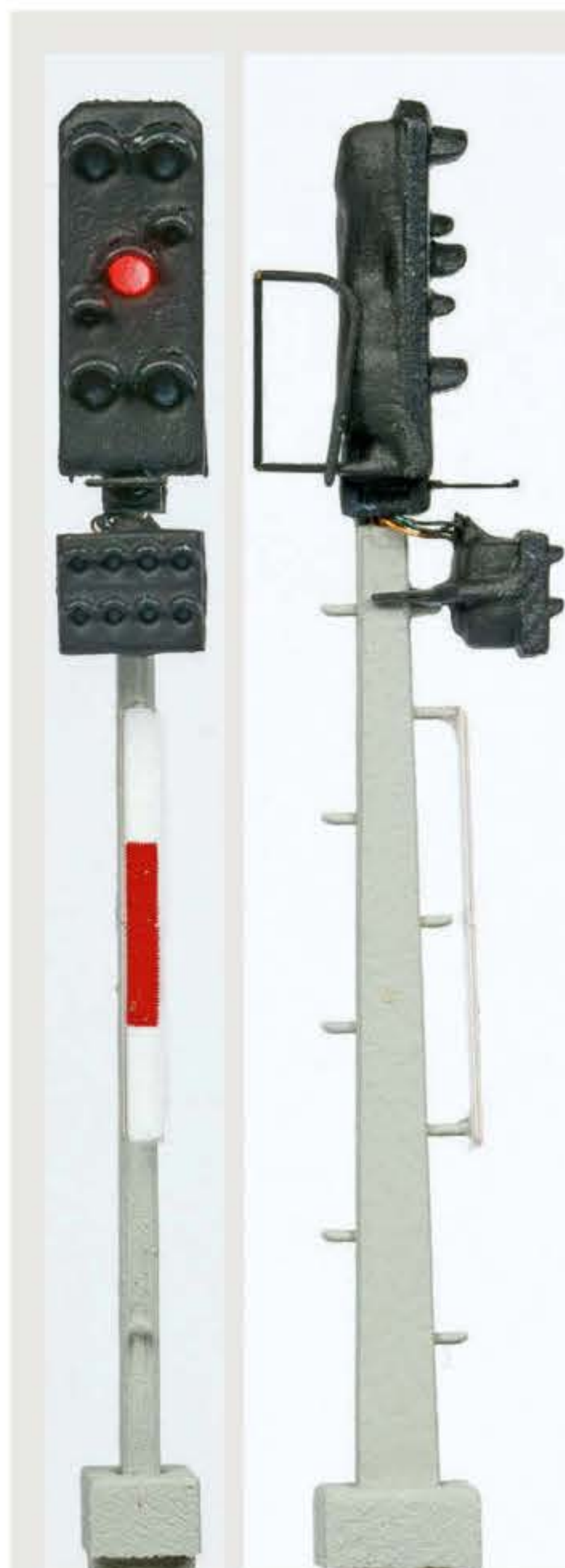
Ausfahrtsignal mit Lichtstreifen in den Stirn- und Seitenansichten
