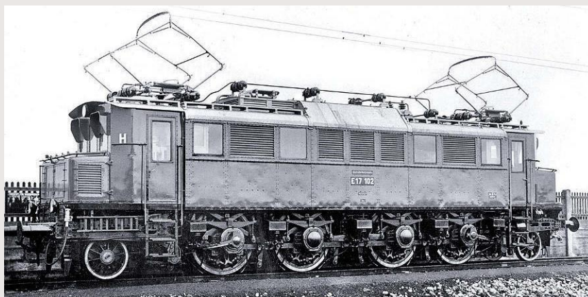
Die DRG E 17 102 im ursprünglichen Zustand mit Leiter unter dem Vorbau und nur oberer Lüfterreihe, RAW München-Freimann 1935
