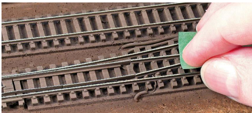
Vor dem Schottern werden mindestens die Gleise komplett eingefärbt und anschließend die Schienenprofile mit feinem Schleifpapier wieder blank geschliffen. Ebenso sind die Weichenzungen auf einwandfreien Kontaktschluss zu überprüfen
