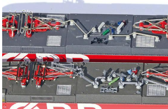
Die Dachdetaillierungen von Hobbytrain (hinten) mit Metall-Leitungen und von Fleischmann mit Kunststoff-Leitungen und schmälere Paletten
