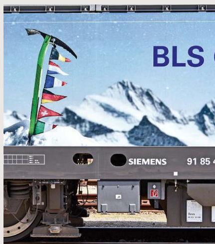
Die BLS Re 475 mit der typischen Dreiergruppe der Signum-Magneten
