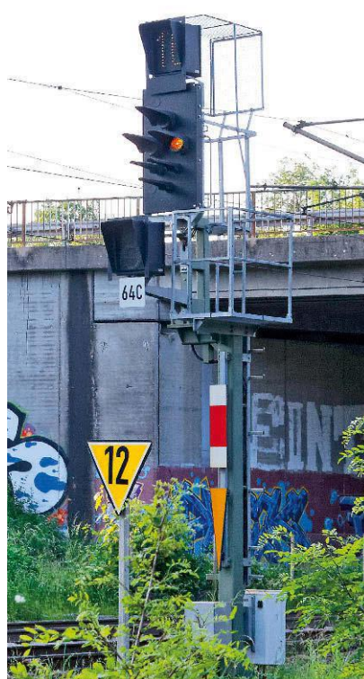
Das rechtsseitige Einfahrsignal 64C in Frankfurt Stadion. Es zeigt Ks 2 + Zv 3 für 100 km/h. Davor steht ein Geschwindigkeits-Ankündesignal Lf 6 für eine ständige Vmax von 120 km/h
