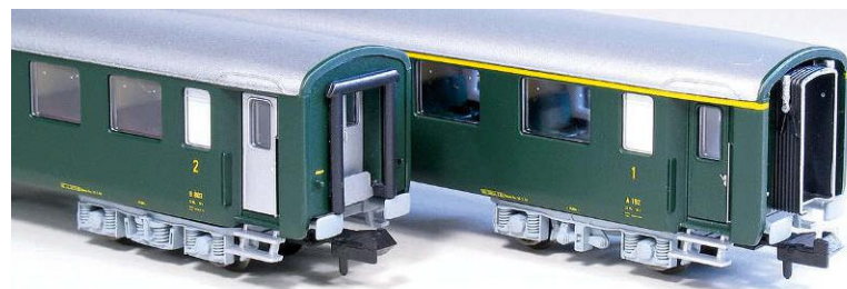
MW-Modell: die unterschiedlichen Stirnseiten mit Gummivulst oder Faltenbalg
