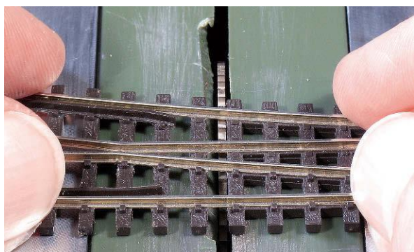
Eine nur auf der rechten Hälfte ausgefräste Code 55-Bogenweiche von Peco zeigt deutlich den Unterschied vor und nach der Bearbeitung
