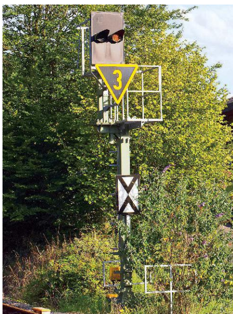
Das Einfahrsvorsignal in Linz (Rhein) für die Kasbachtalbahn. Es kann Ks 1 nur mit Zs 3v 30 km/h anzeigen. Die Zs 3v-Schilder sind nicht so oft zu sehen
