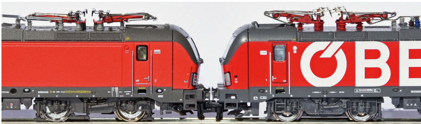
Höhenvergleich: links das ÖBB-Modell von Fleischmann, daneben dasjenige von Hobbytrain, dessen Lokkasten etwas höher aufsitzt
