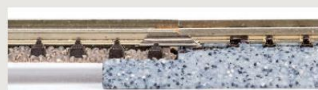
Das in den Kato-Adapter eingesteckte Fleischmann-Gleis links liegt unten nicht auf
