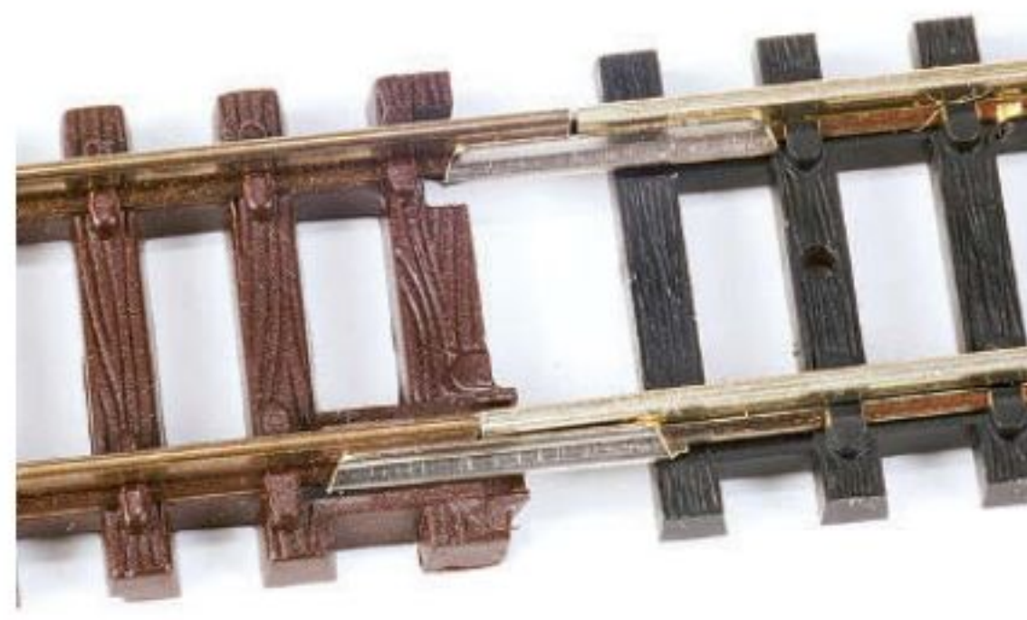
Minitrix (wie auch Fleischmann) bie- tet ein gerades Adaptergleisstück mit einseitig verlängertem Schienen- profil und vertauschter Schienenver- binderseite als Übergang zu den Ar- nold-Gleisen an
