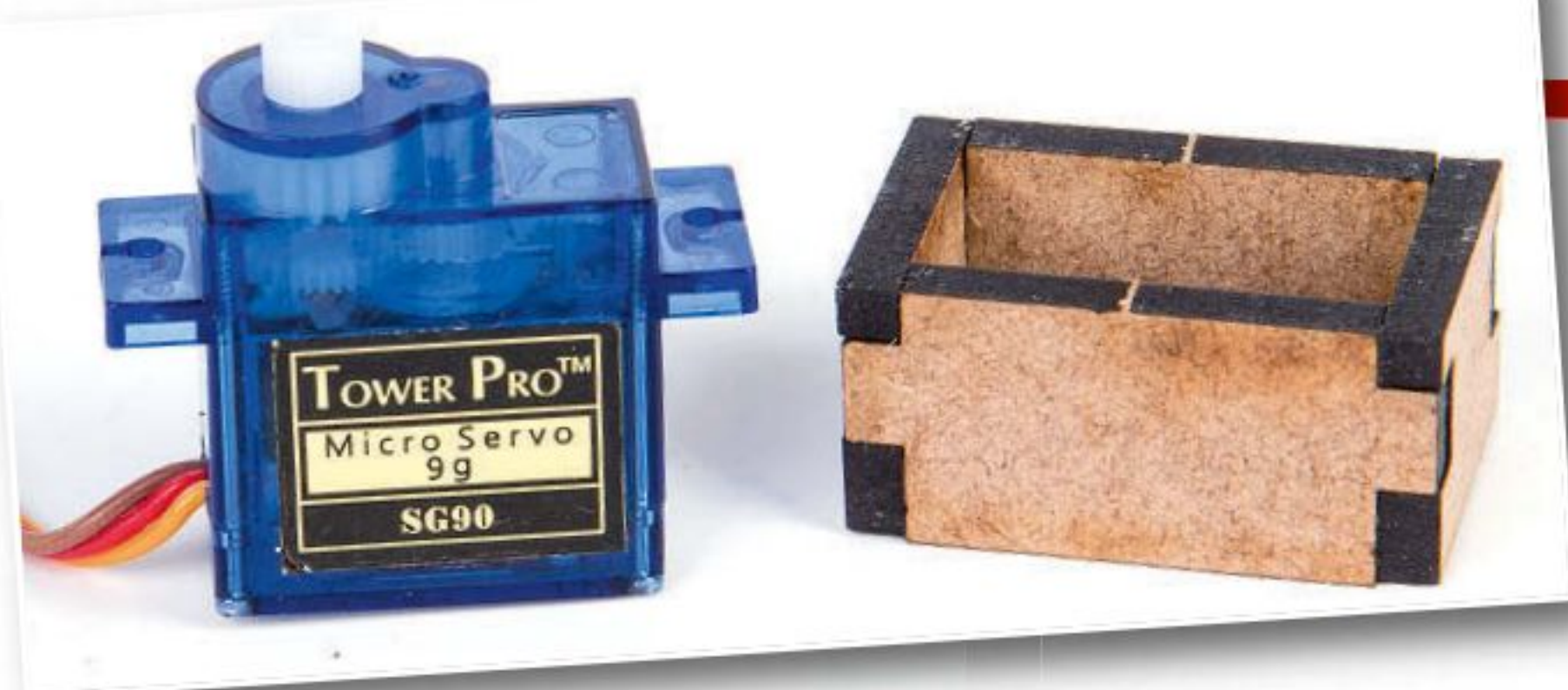
Modellbahn Union: Dem Bausatz liegt ein Servo von Tower Pro als Antrieb bei
