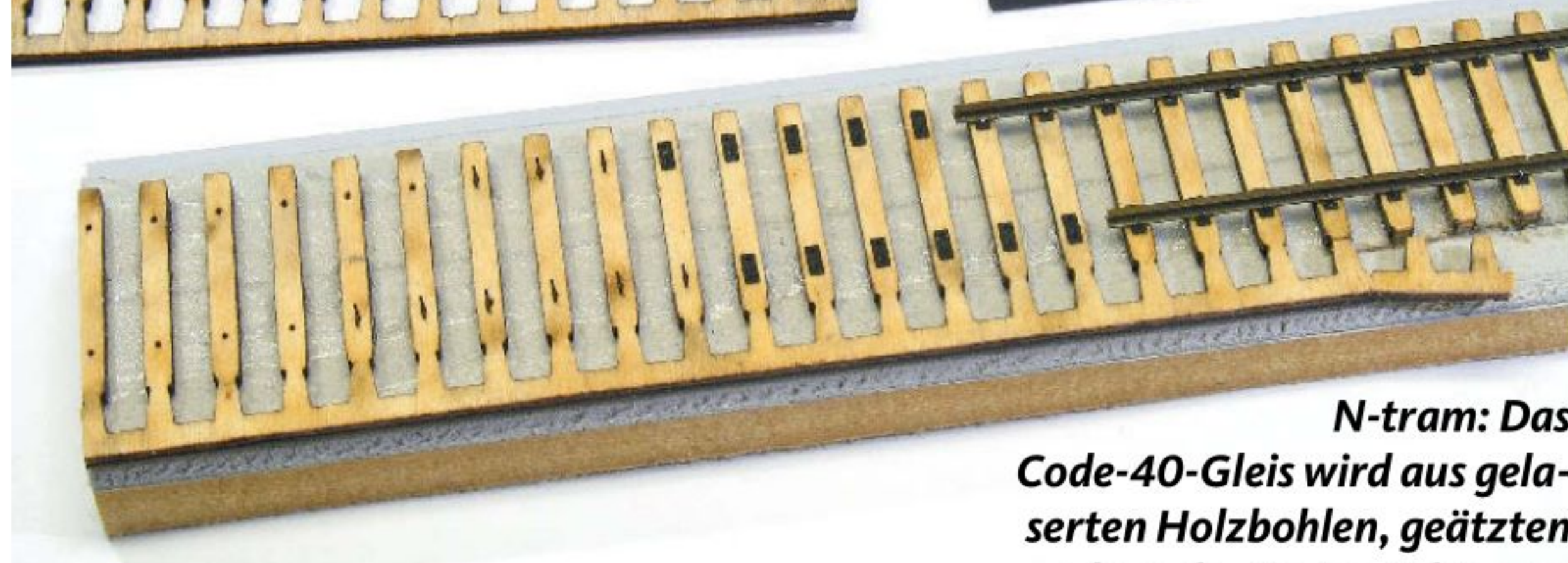
SpurNeun/SMB: Das Code 40-Gleis besteht aus Metallgussstreifen für die Schienenhalterungen, gelaserten Holzschwellen und blanken Profilen
