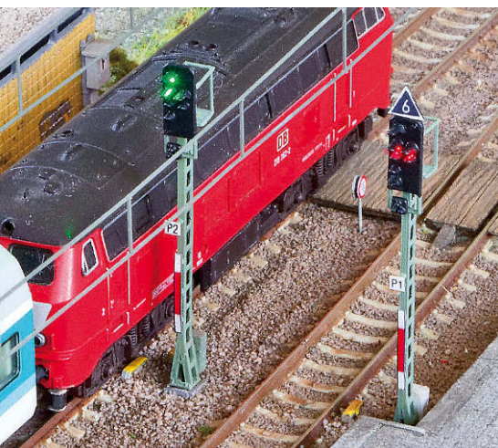
Ausfahrtsignalgruppe auf dem Segmentebahnhof Rheinfort. Das rechte Signal trägt zusätzlich das selbst gedruckte Signalschild Zs3 für Hp2 mit 60 km/h
