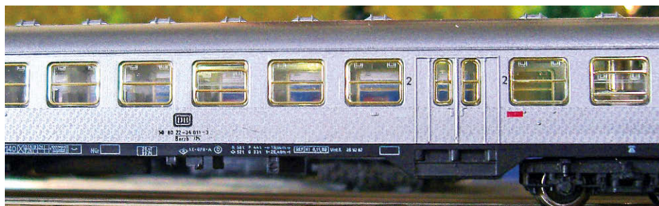
„Silberling“ mit indirekter Lichtleisten-Montage über Alufolie im Dach
