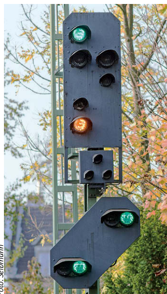
Mattschwarzer Schirm der Signalbauart 69 mit seinen typischen Signallampfarben in bläulichem Grün und Orangegelb
