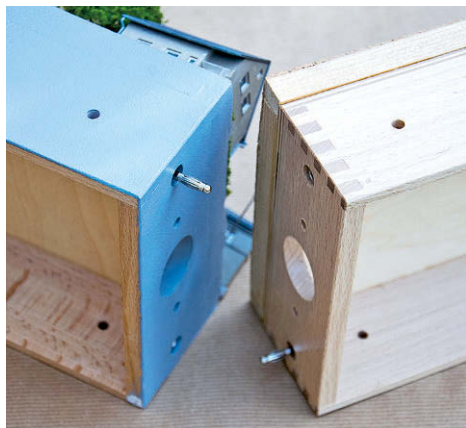
Die Kontaktverbindung zwischen den Modulen mittels großer Bananenstecker
