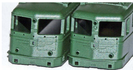
Unlackierte Fronten der überarbeiteten Ae 6/6 mit erhabenen Zierstreifen sowie ohne und mit Fahrtberechtigungssignal
