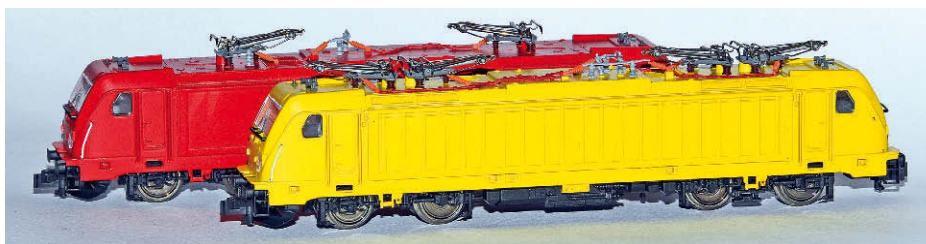
Konstruktionsmuster der TRAXX 3 mit unterschiedlichen Seitenwänden und Dachausrüstungen
