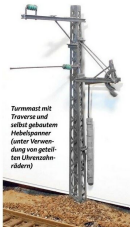
Eingebauter einfacher Streckenmast für ein Gleis mit sichtbarem Fundament
