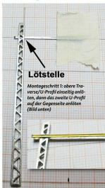
Gittermast mit Diagonalverstrebung. Vorbildmaße und Maße in 1:160 (rot)
