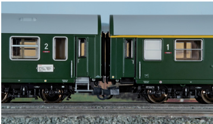
Gut erkennbar sind die im Zugverband dicht anliegenden Gummistübe. Je nach Mindestradius lassen sich tiefere Triffstufen nachrüsten (links)
