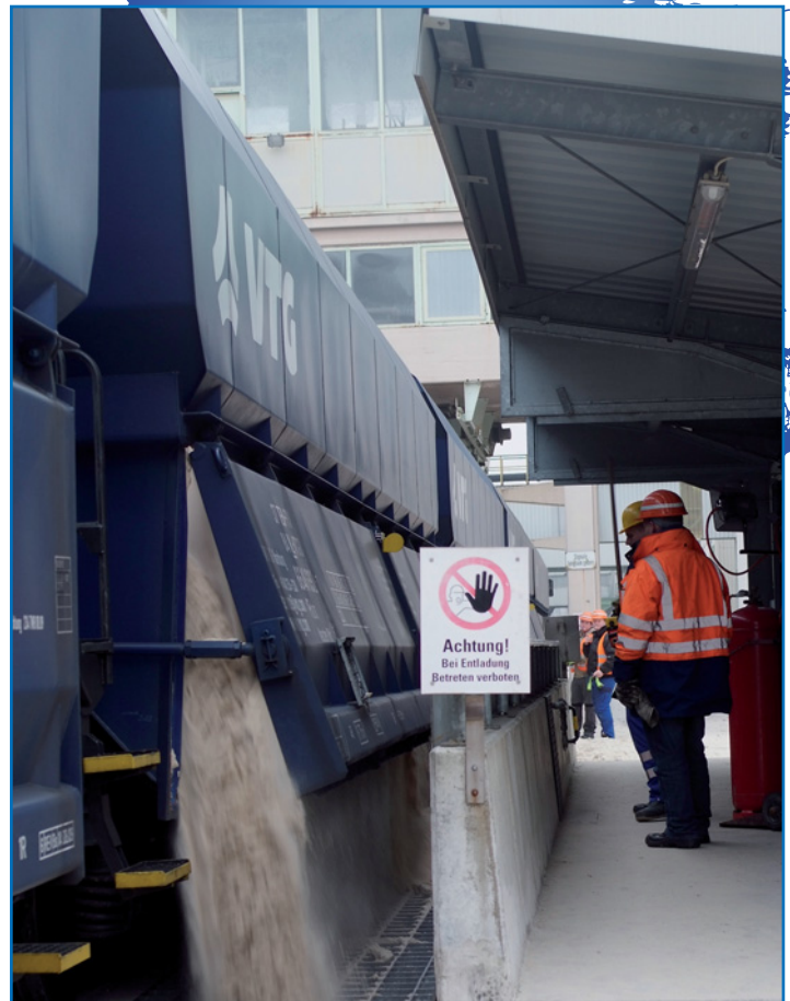
Zu wichtigen Nutzern der VTG-Wagen zählt die HGK, welche damit Ganzzüge zum Transport von Quarzsand bildet. Hier ist der Entlademechanismus gut erkennbar
