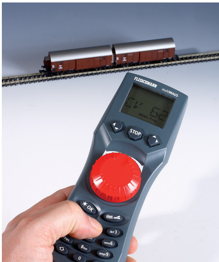
Über den Parameter CV62 legen Sie fest, in welchem Modus Sie die Türen bewegen wollen: Schalter- oder Drehrad-Modus
