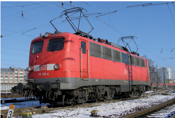
Die ehemalige 110 198 ist zwar mittlerweile in 115 198 umbenannt, war aber noch im Januar 2006 mit alten Einfachlampen ausgerüstet
