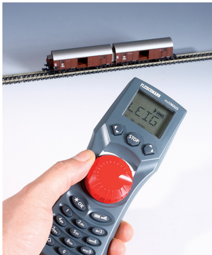
Drehrad nach rechts – und schon gleitet die Tür zur Seite. Alternativ zum Drehrad-Modus lassen sich die Türen auch über die Funktionstasten F1 bis F4 an der multiMAUS öffnen und schließen
