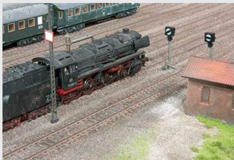
Im Stellwerk werden alle nötigen Weichen in die richtige Lage gebracht. Dann wechselt das Signal auf Sh 1 und die Lok fährt an.
