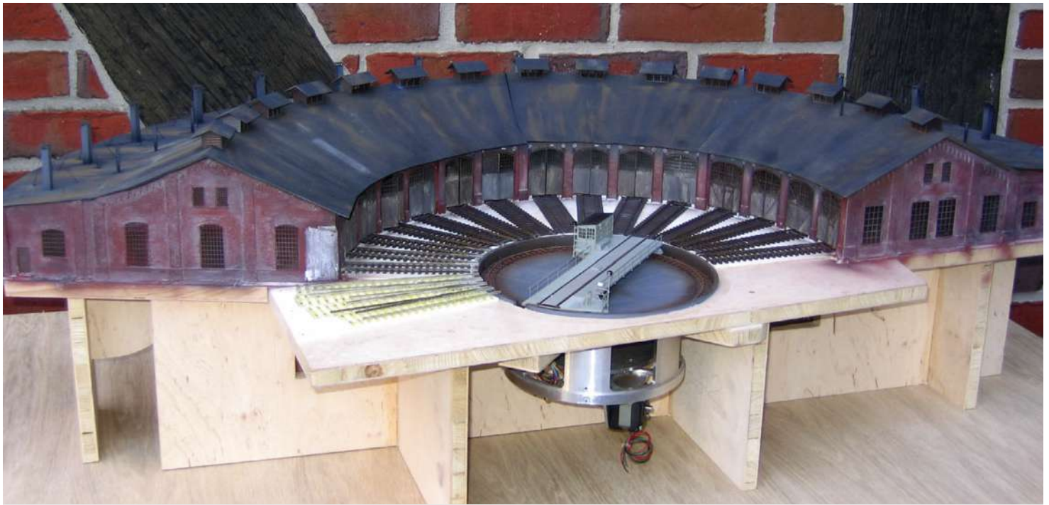
■ Eine knifflige Arbeit war die Ansteuerung der Drehscheibe: Sie ist mit 23,5 cm nur knapp länger als der Radstand der Loks der Reihe 44. Im automatischen Betrieb müssen die Loks für einen störungsfreien Betrieb exakt positioniert werden.
