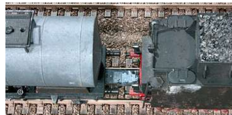
■ Sobald die Metallflächen der Kupplungen zueinander Kontakt finden, beginnt der T4T-Kokdecoder mit seinem „Kuppelprogramm“ und stoppt die Lok nach wenigen Millimetern, sodass der Zug nur ein wenig rückt.
