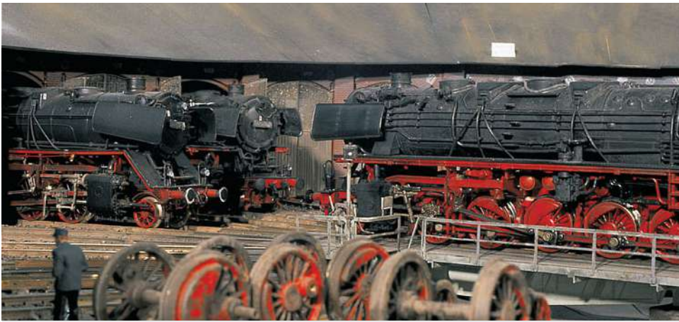
■ Hochbetrieb auf der Scheibe. 044 210-3 wird nach abgeschlossener Ganzprüfung gedreht und dann auf Stand 7 für die weiteren Ausbesserungsarbeiten abgestellt.
