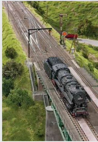
Auf dem Damm rollt die bisherige Zuglok bis über das am Galgen aufgehängte Wartezeichen hinaus und hält dort.
