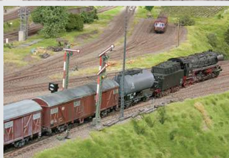
Nach Ankuppeln und Bremsprobe wird Signal N53 in Hp 2 Stellung gebracht, die Ausfahrt steht. Nun beschleunigt die frische Lok ihren Zug auf die Strecke hinaus.
