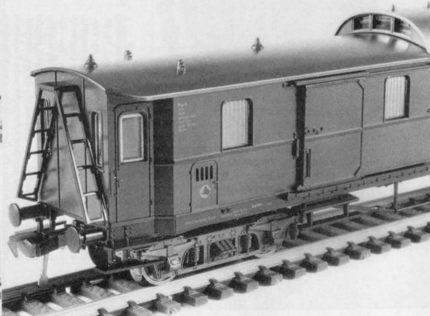
Abb. 6. Diese Nahansicht des Gepäckwagens verdeutlicht außer diversen Details an Drehgestellen, Langträger, Wagenkasten und Dach vor allem die Tatsache, daß das Modell als Eilzug-Gepäckwagen tatsächlich keine Übergänge an den Stirnseiten hat.
