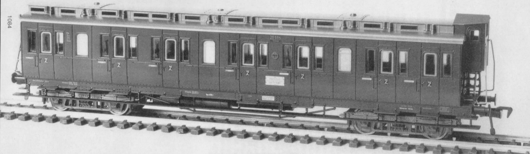
Abb. 1 u. 2. Oben das 21,2 cm lange Modell des preußischen Abteilwagens 2. Klasse mit Bremserhaus in ca. 1/1 H0-Größe; links in ca. 1½-facher Originalgröße Boden- und Drehgestell-Details sowie die Aussparungen in den Trittbrettern (für das Ausschwenken des Drehgestelles bei Kurvenfahrt).
