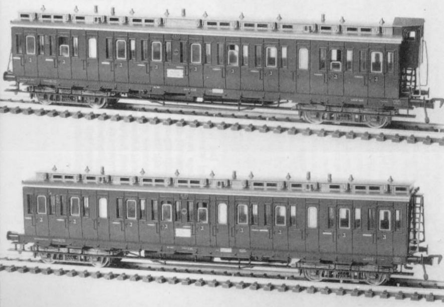
Abb. 6. Diese Nahansicht des Gepäckwagens verdeutlicht außer diversen Details an Drehgestellen, Langträger, Wagenkasten und Dach vor allem die Tatsache, daß das Modell als Eilzug-Gepäckwagen tatsächlich keine Übergänge an den Stirnseiten hat.
