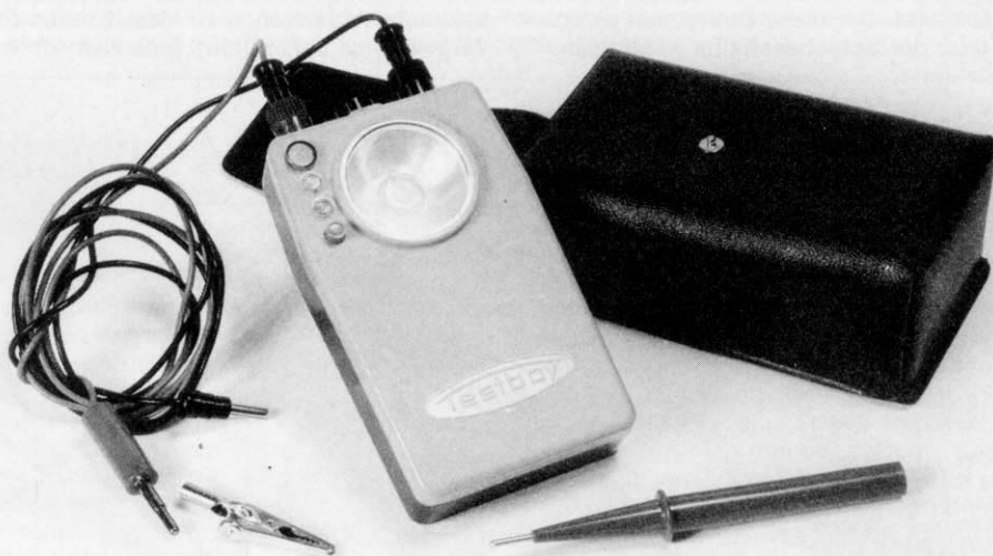
Abb. 2. Das Vielzweck-Prüfgerät „Testboy“ wird in einer schwarzen „Bereitschaftstasche“ geliefert.
