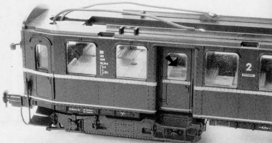
Abb. 5. Beim Steuerwagen sind die Sitzbänke nur im Bereich der Kopfstücke höhergelegt, darunter sitzt die Feder der Kurzkuppplungs-Einrichtung (Pfeil).
