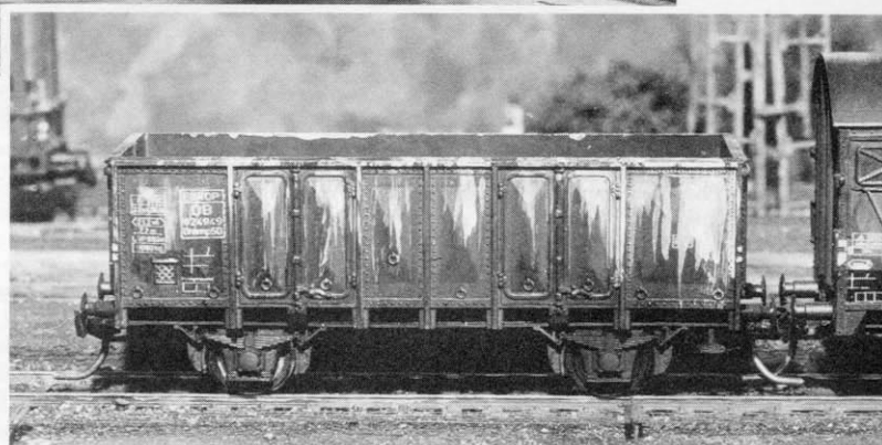
Abb. 4: Ein kurzer Klappdeckelwagen mit kalkverschmierten Türen und sonstigen Betriebsspuren; man beachte auch die nachgestrichenen Bretter der Bremshaustür.
