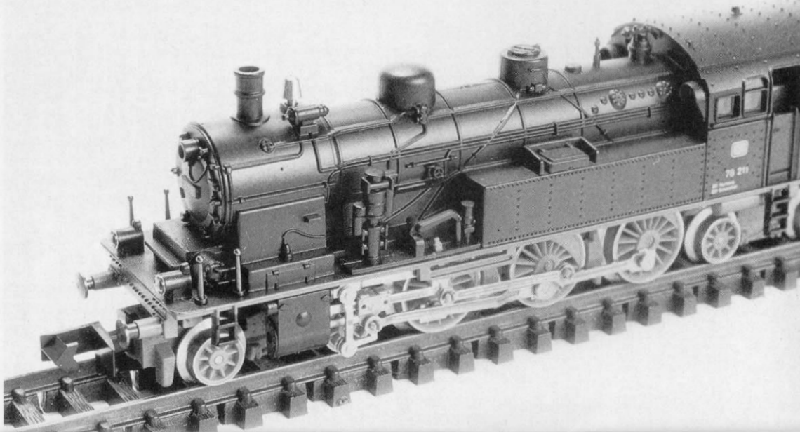
Abb. 2. Die vergrößerte Wiedergabe (mehr als 1½fache N-Größe) bringt die zahlreichen feinen Einzelheiten der „78“ erst so recht zur Geltung, wie z. B. Pumpe, Aufwerfhebel, Sicherheitsventil, oder die für N relativ zierliche Steuerung.
