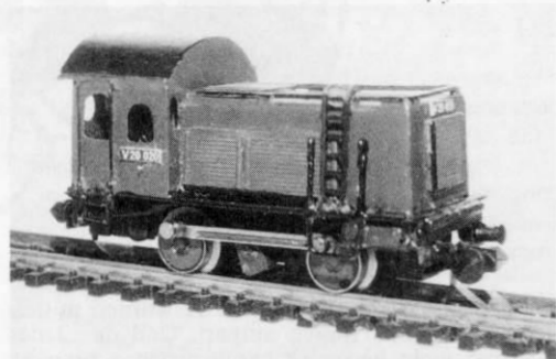
Abb. 1. Die vergleichsweise winzige V 20 basiert auf dem Fahrgestell der Minitrix-T3; die mittlere Achse wurde zur Blindwelle.
