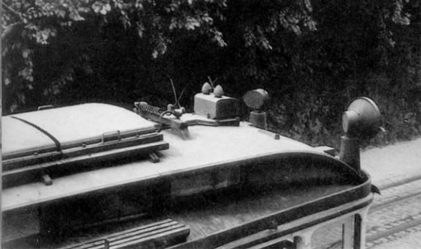
Abb. 12 u. 13 zeigen, wie genau der Erbauer die charakteristischen Dach-Details des Vorbildes wie z. B. die Nummerntafel ins Modell umsetzte. Die Fenster des Fahrgastraums sind zur Tarnung des Motors (s. Abb. 8) mattiert.
