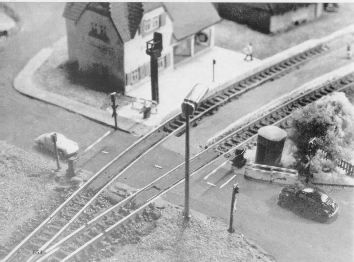
Abb. 6. Die etwas „gedrängt“ erscheinende Anordnung von Bahnübergang und Empfangsgebäude mit Bahnsteig entspricht der Wirklichkeit. Die winzigen Halbschranken sind selbstgebaut; das Bü-Signal ist ein umgebautes Lichthauptsignal, in das eine weiße Lichtleitfaser eingezogen wurde.
