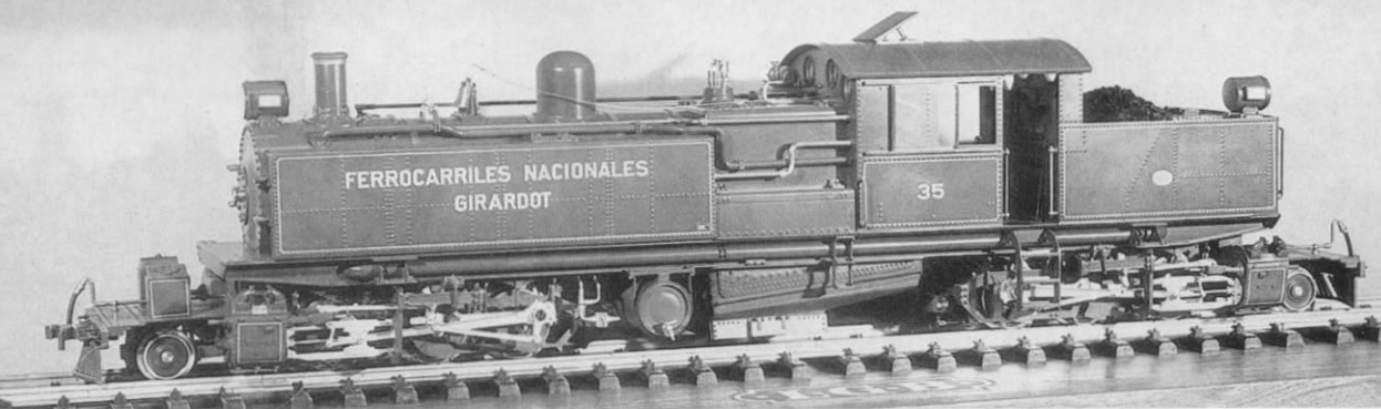
Ilm Abb. 212. 1'C + C 1' lautet die Achsfolge dieser 67 cm langen, ganz aus Messing gearbeiteten Dampflokomotive nach einem 1927 gebauten südamerikanischen Vorbild der Bauart Kitson-Meyer.
